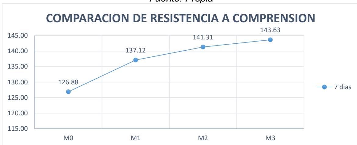
Figura 7 Ensayo a compresión a la edad de 7 días
