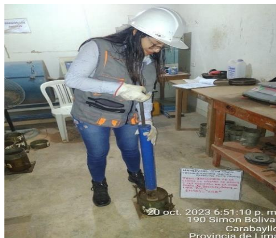
Figura 28. Compactación del suelo
