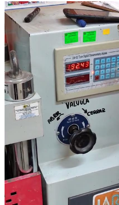
Resultados a la compresión de Probeta con 10% de CCA N°1 a los 14 días
