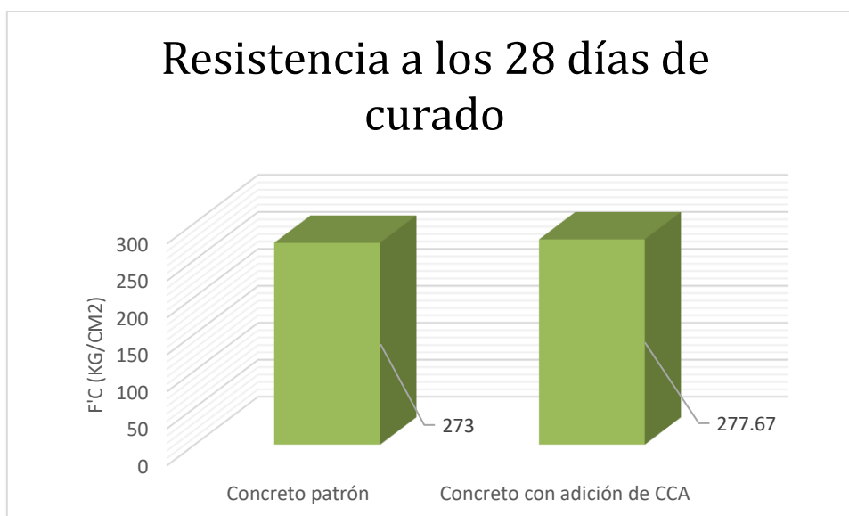
Figura 21. Resultados del ensayo a la compresión a los 28 días
