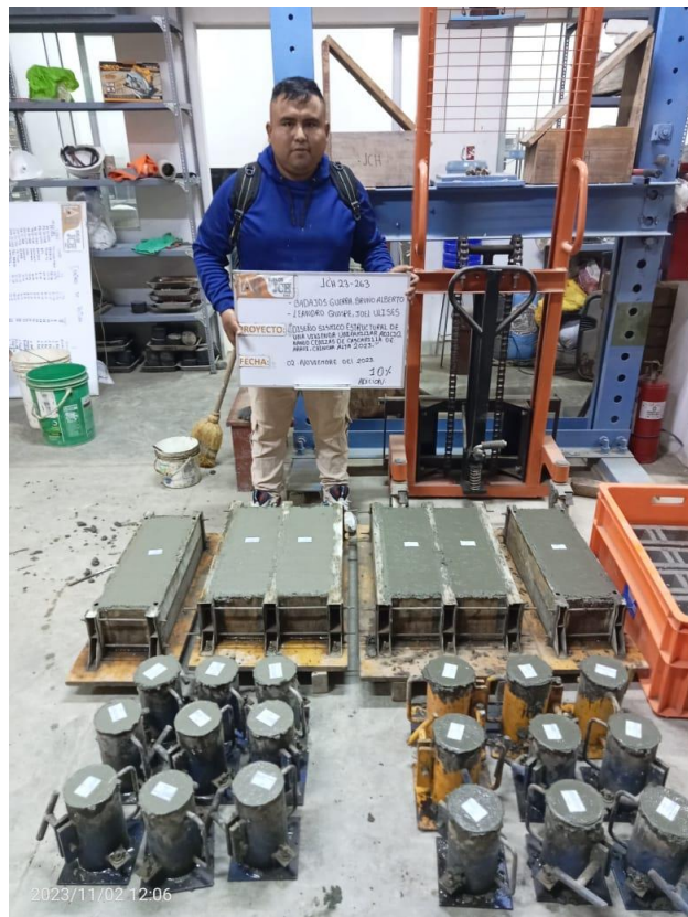
Probetas y vigas para los ensayos de compresión y flexión
