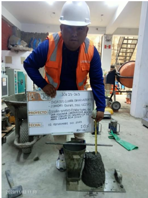
Ensayo de Slump y vaciado de probetas (Concreto con 10% de CCA)
