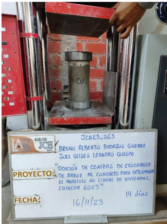
Resultados a la compresión de Probeta patrón N°1 a los 14 días curado
