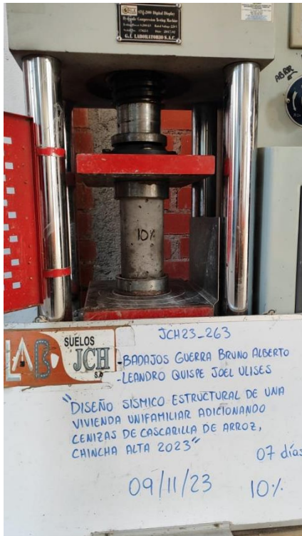
Resultados a la compresión de Probeta con 10% de CCA N°2 a los 7 días
