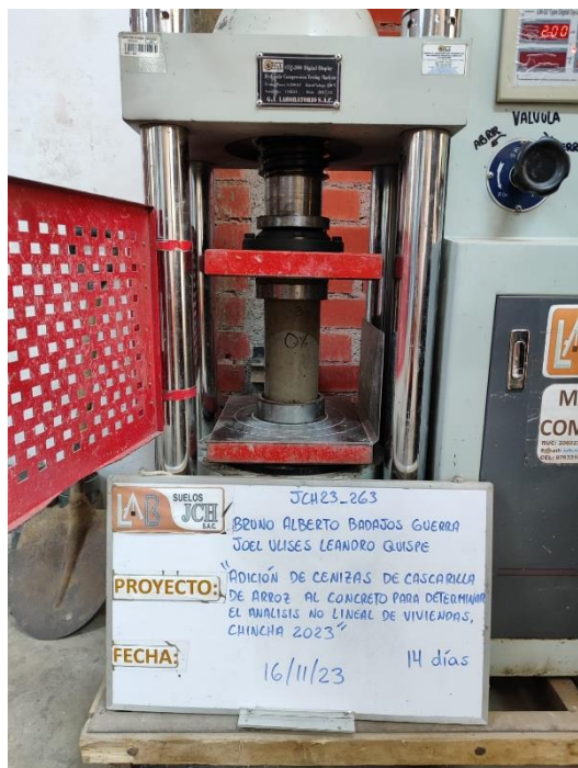
Resultados a la compresión de Probeta patrón N°3 a los 14 días curado
