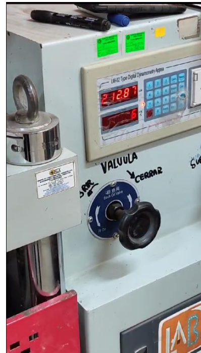
Resultados a la compresión de Probeta con 10% de CCA N°2 a los 14 días
