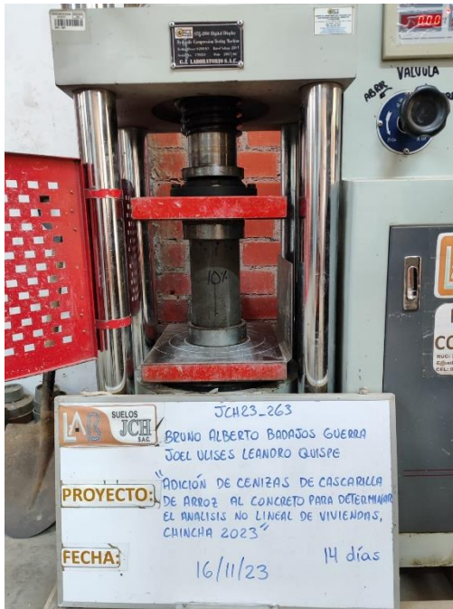
Resultados a la compresión de Probeta con 10% de CCA N°1 a los 14 días
