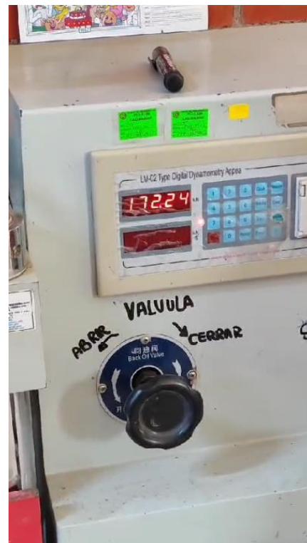
Resultados a la compresión de Probeta con 10% de CCA N°3 a los 7 días
