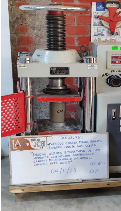
Resultados a la compresión de Probeta patrón N°1 a los 7 días
