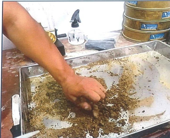
Imagen N° 05: Se aprecia los ensayos de limite líquido y limite plástico, donde se observa suelo arenoso y limoso con poca trabajabilidad a la plasticidad.
