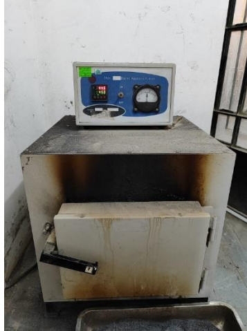
Figura 2. Mufla de laboratorio empleada en la investigación
