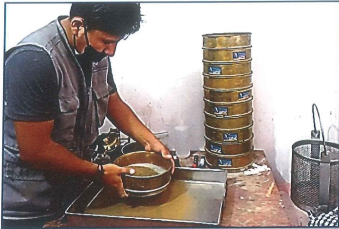
Imagen N° 03: Se aprecia el ensayo de límites de consistencia de la calicata N°01.
