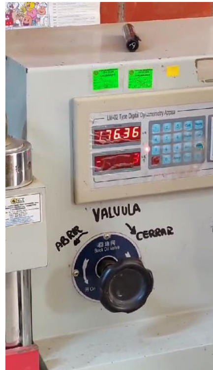
Resultados a la compresión de Probeta con 10% de CCA N°2 a los 7 días
