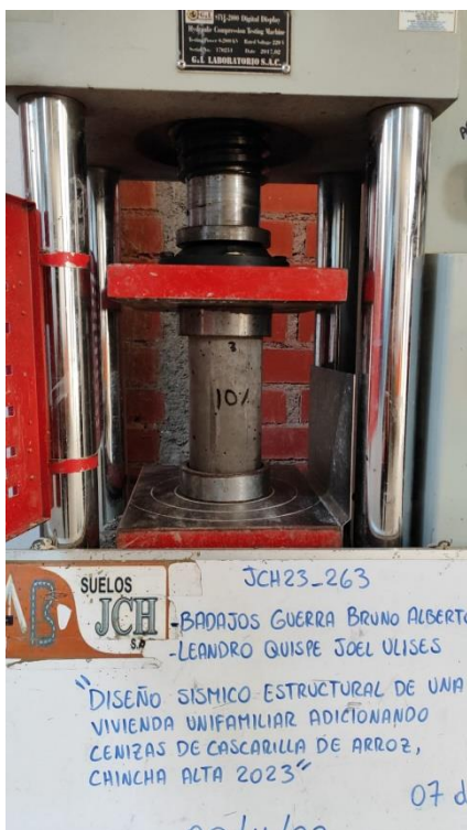
Resultados a la compresión de Probeta con 10% de CCA N°3 a los 7 días
