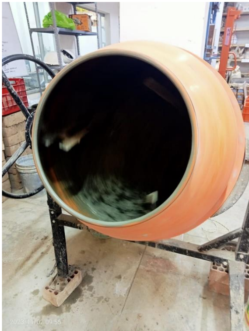
Elaboración del concreto patrón 210 kg/cm 2
