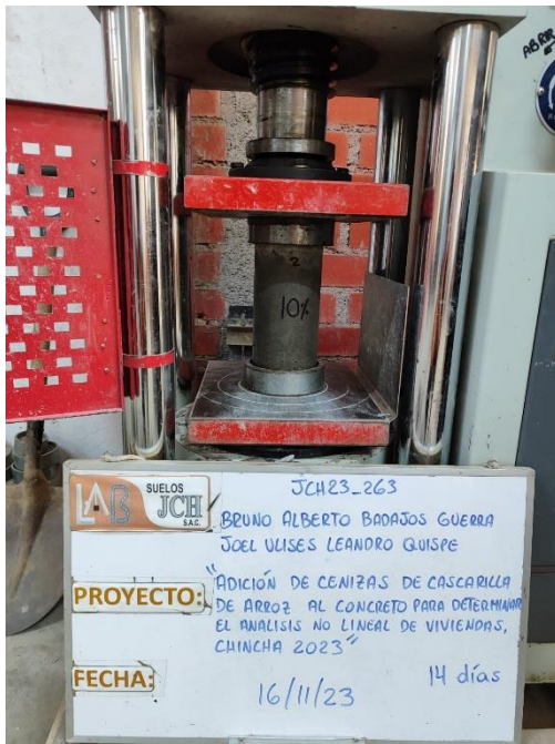
Resultados a la compresión de Probeta con 10% de CCA N°2 a los 14 días
