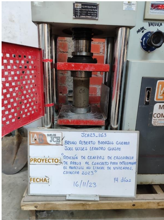
Resultados a la compresión de Probeta patrón N°2 a los 14 días curado
