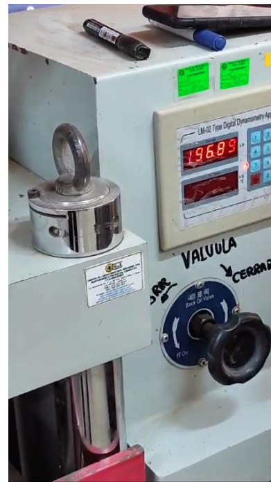
Resultados a la compresión de Probeta patrón N°3 a los 14 días curado
