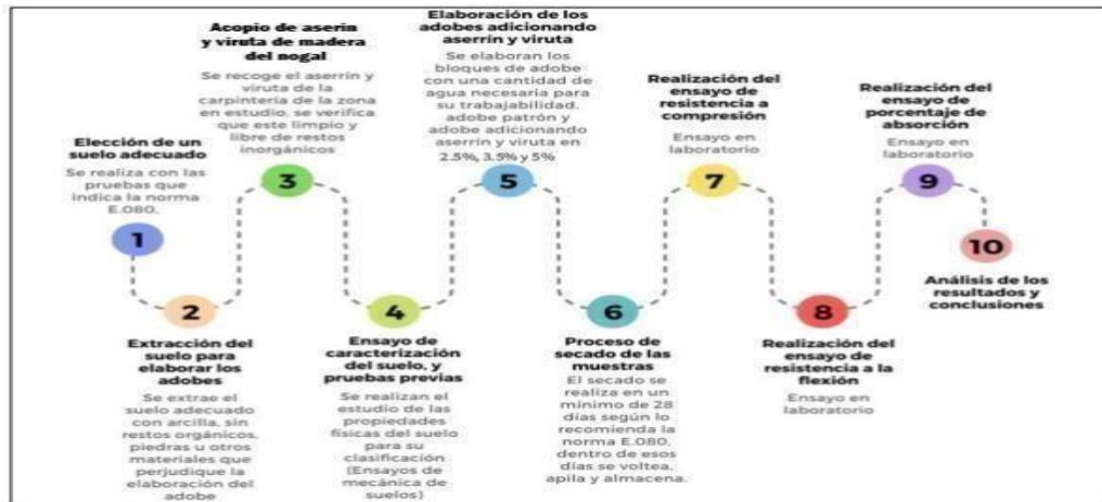
Figura 5: Proceso de elaboración de adobe con viruta y aserrín de nogal
