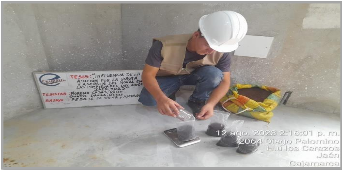
Fotografía 5: Pesado de viruta y aserrín de madera de nogal
