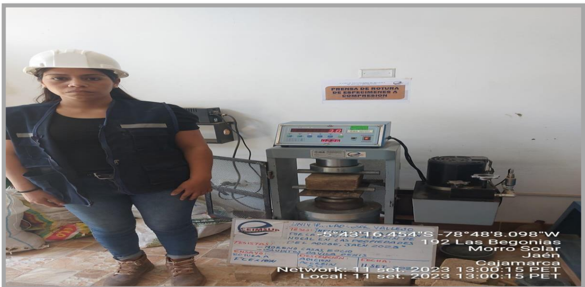
Fotografía 8: Ensayo de resistencia flexión
