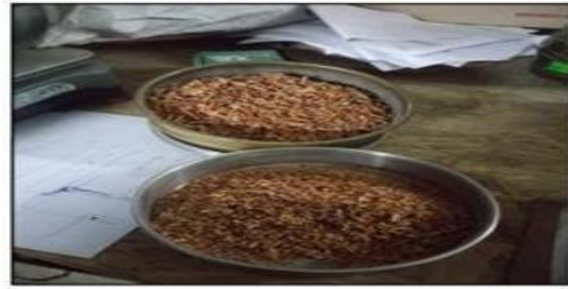
Figura 2: Residuos de viruta de después del proceso de cepillado
