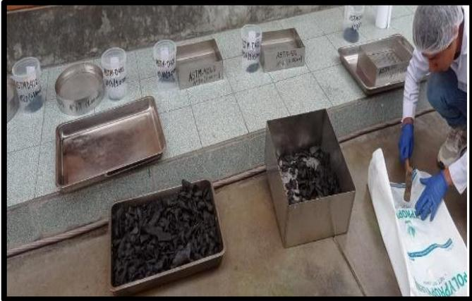
**Figura 13:** Trituración y análisis de tamices
