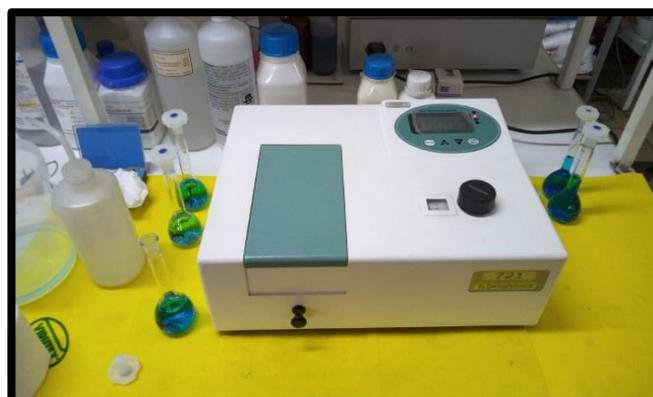
**Figura 24:** Prueba con espectrofotometría UV/V
