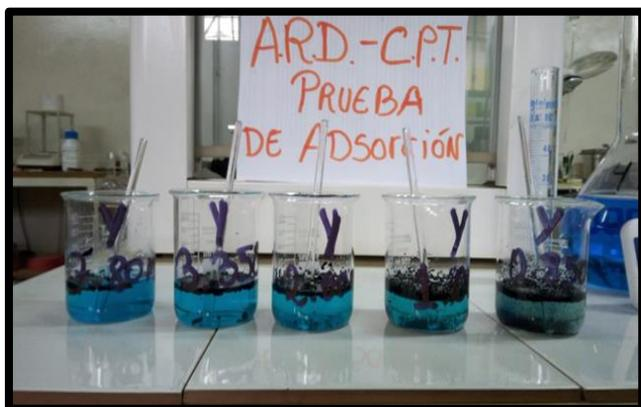
**Figura 19:** Adsorción con el azul de metileno
