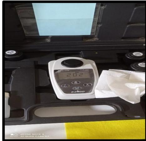
**Figura 30:** Prueba de turbidez del agua
