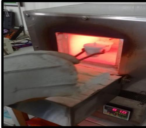
Figura 12: Prueba de ceniza en la mufla
