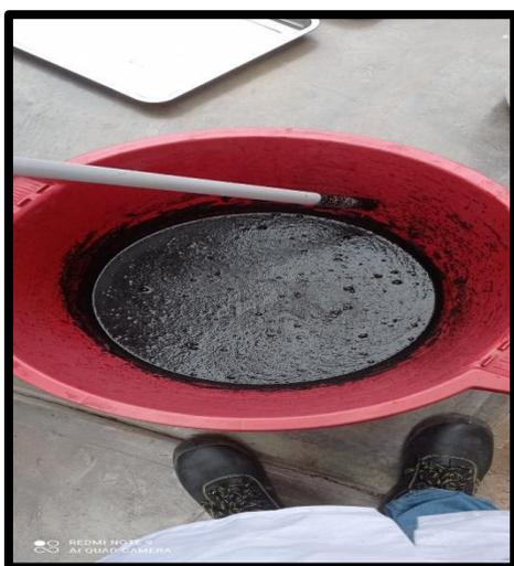
Figura 17: Lavado del biocarbón
