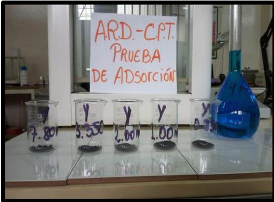
**Anexo 10.** Determinación de la curva de calibración de la constante K
