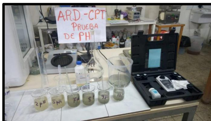
**Figura 16:** Prueba de pH de agua residual
