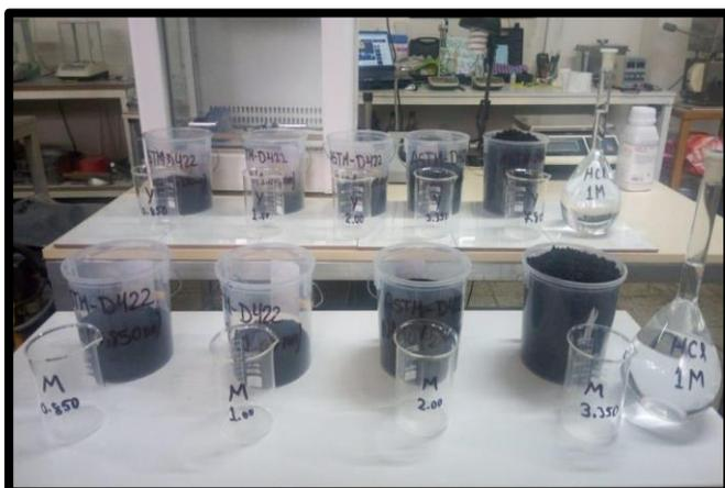
**Anexo 9.** Prueba de adsorción de biocarbones con una concentración de 4ppm azul de metileno
