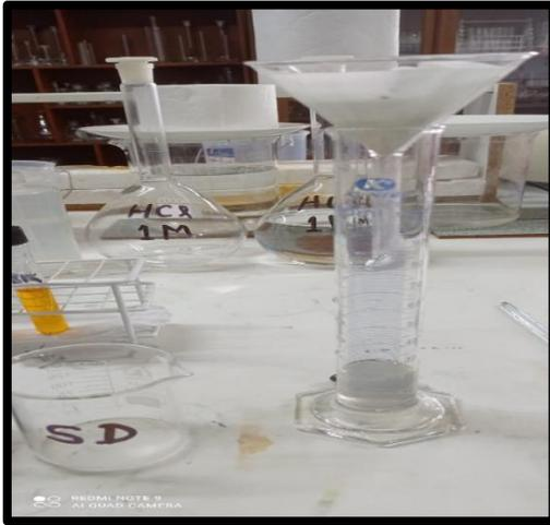
Figura 31: Análisis gravimétricos de agua residual
