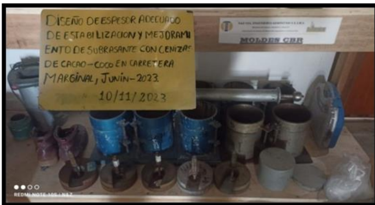
Figura 44. Equipos para el ensayo de Proctor para la Muestra Patrón.
