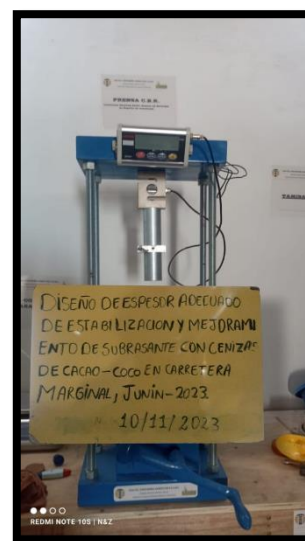
Figura 27. Moldes para el ensayo CBR
