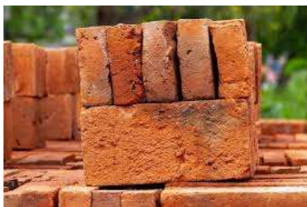
Figura 2. Unidad de albañilería sólida de arcilla
