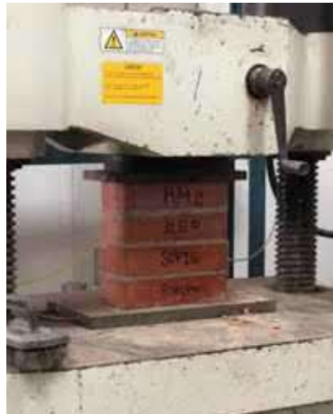
Figura 10. Equipo de ensayo para compresión axial
