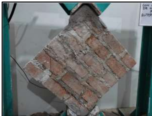
Ensayo de compresión diagonal en muretes
