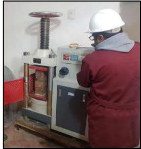
Ensayo de compresión axial en pilas
