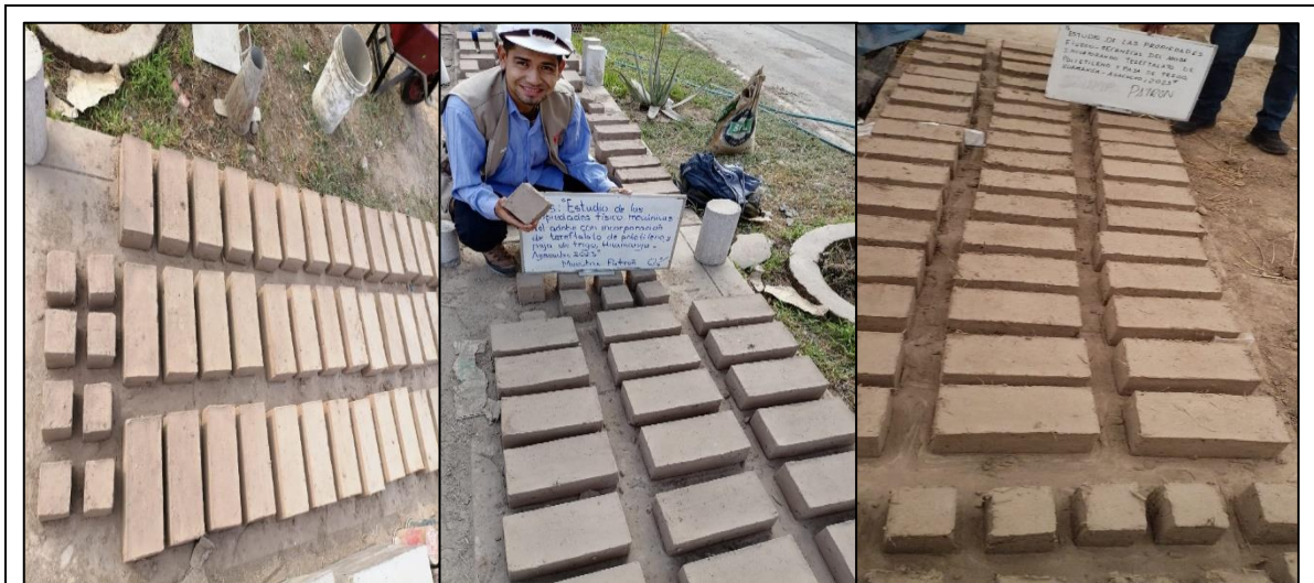
Figura 7: Producción y secado de adobes por dosificación de PET y paja de trigo
