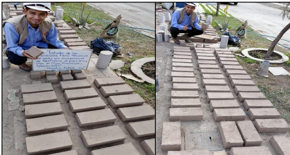
Figura 21. Secado de adobes con dosificaciones de 0%, 4%, 9% y 14%
