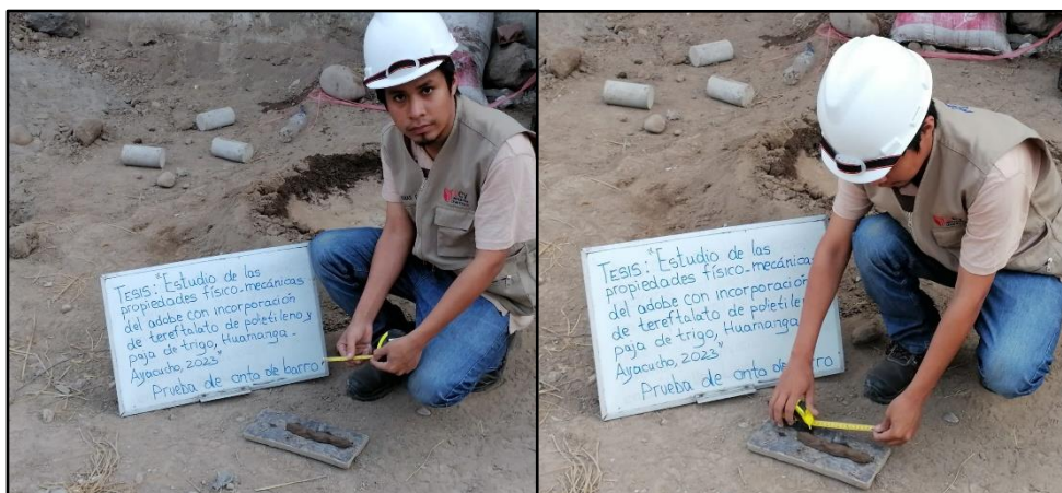
Figura 15. Prueba de cinta de barro
