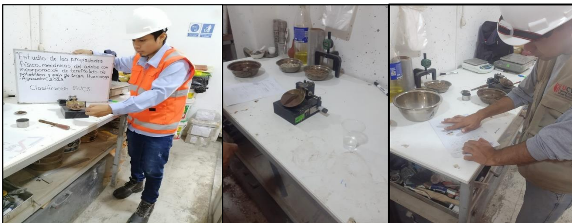
Figura 18. Ensayo Límites de Atterberg
