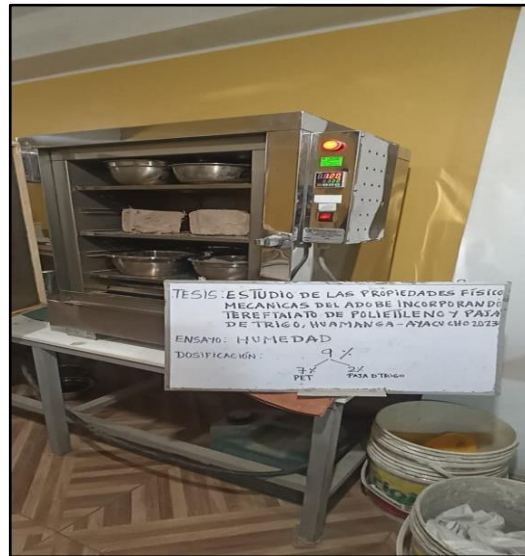
Figura 23. Ensayo de absorción de agua Fuente: Propio
