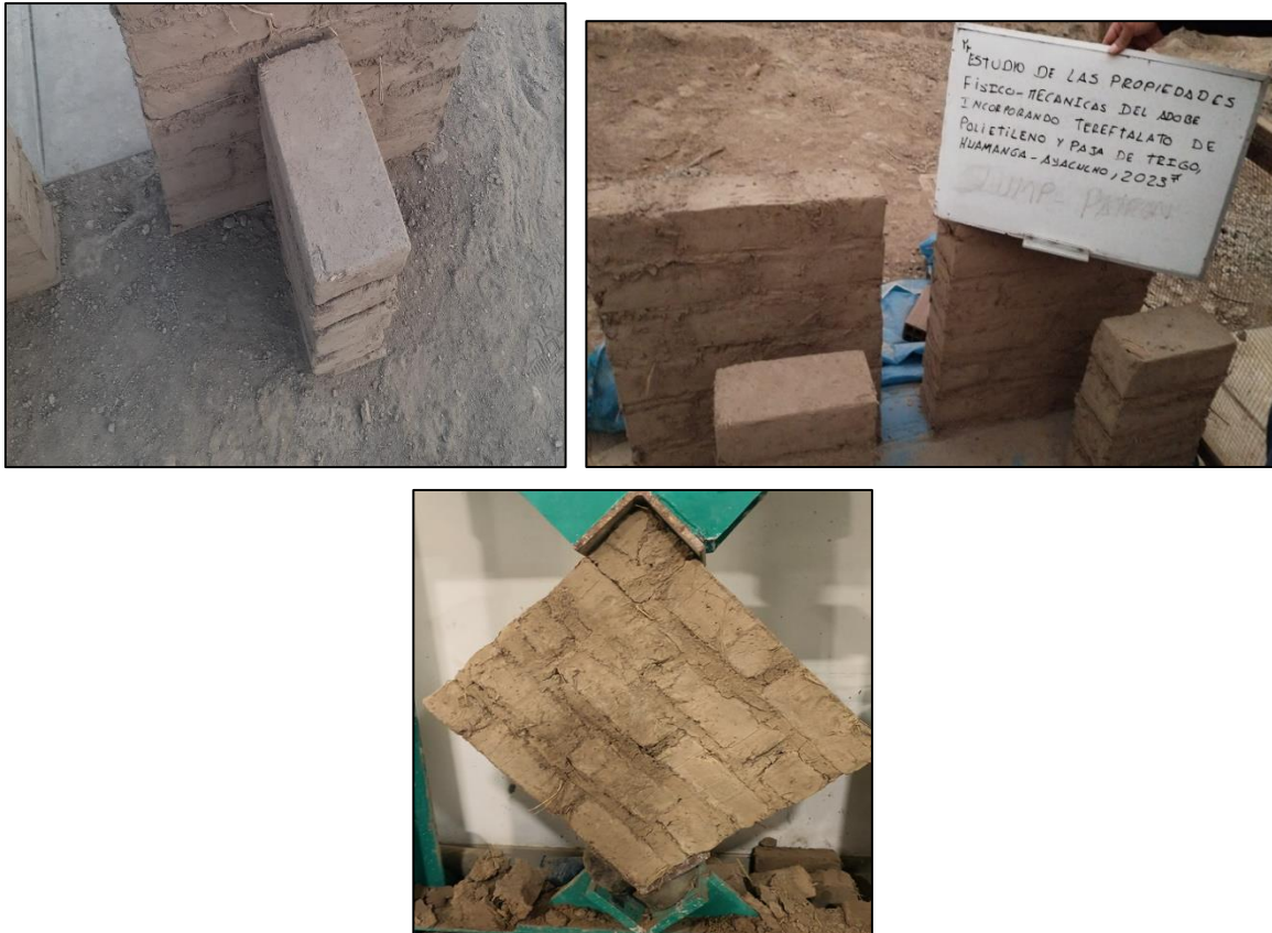
Figura 11: Ensayo de resistencia a compresión en pilas y diagonal de muretes de adobe con 0%, 4%, 9% y 14%
