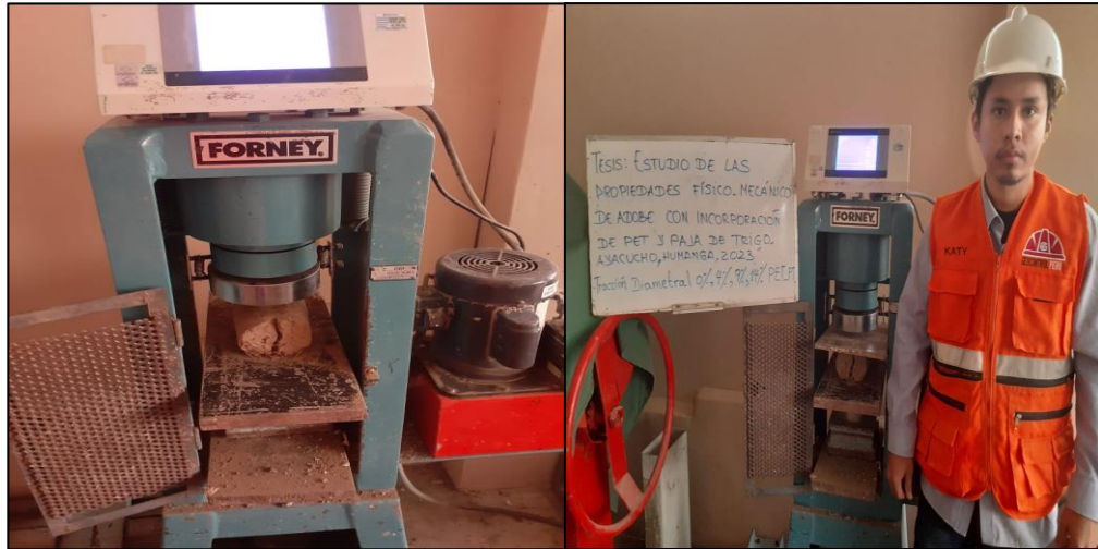
Figura 10: Ensayo de resistencia a tracción por compresión diametral con 0%, 4%, 9% y 14%
