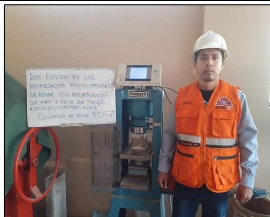
Figura 9: Ensayo de resistencia a la compresión en unidades cubo con 0%, 4%, 9% y 14%
