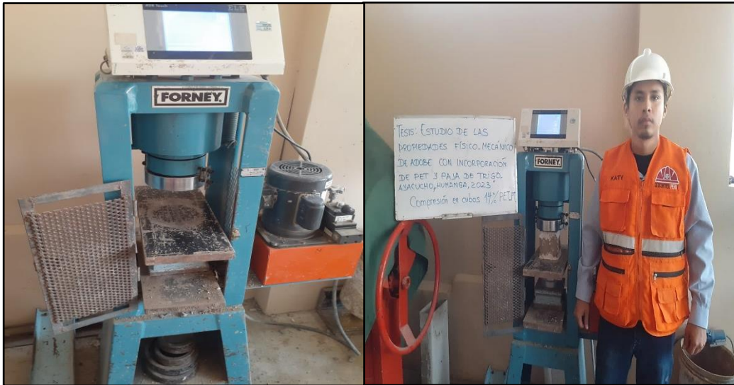
Figura 24. Ensayo a compresión en unidades de cubo
