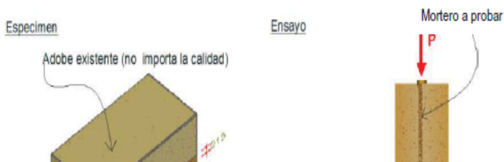
Figura 7. Ensayo de resistencia del mortero a la tracción
