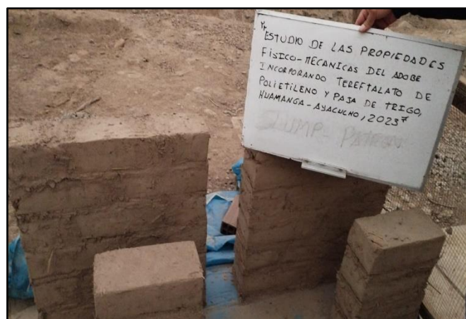
Figura 27. Ensayo a compresión diagonal en muretes
