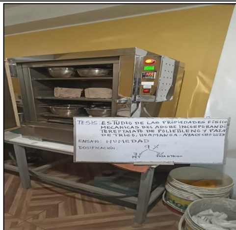
Figura 8: Ensayo de Absorción de adobes con PET y paja de trigo
