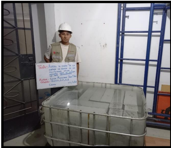
Figura 5. Curado de Vigas
