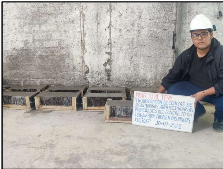
imagen 5: Elaboración de probetas y vigas de concreto
