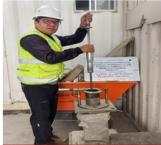
Figura 10. Compactación de cada espécimen de la muestra de 75 golpes por lado – MTC E 504 .
