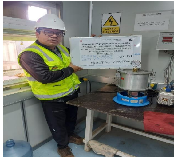
Figura 14. Ensayo Rice, determinación máxima densidad teórica. – MTC E 508.
