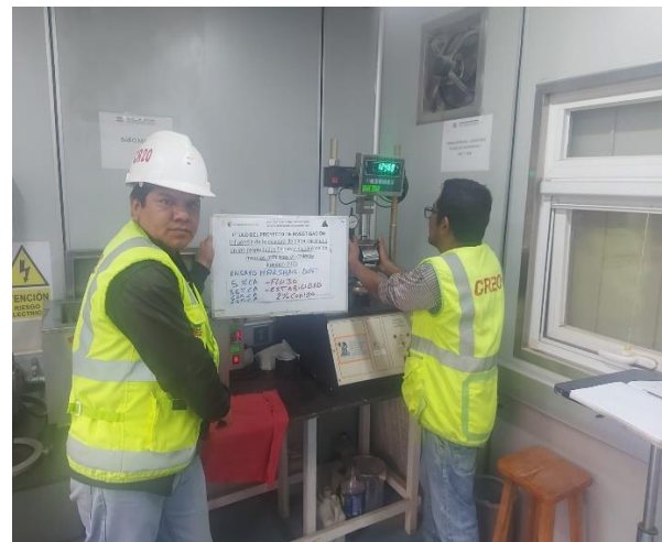
Figura 12. Determinación de ensayo de estabilidad y flujo mediante la prensa Marshall – MTC E 508
