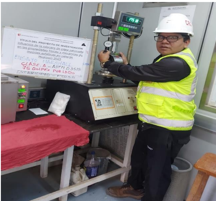
Figura 23. Ensayo flujo y estabilidad
