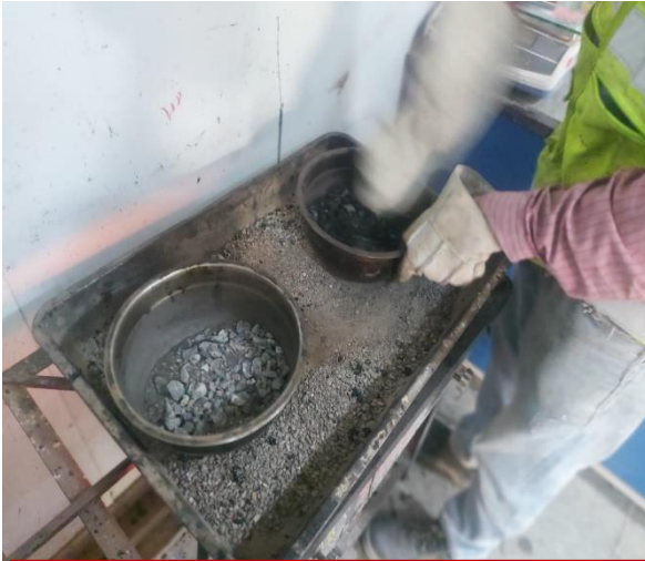
Figura 9. Proceso del combinado de los agregados, hasta obtener una combinación homogénea, donde se trabaja a una temperatura de 40°.
