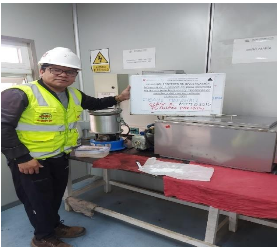
Figura 11. Probetas expuestas en baño maría a una temperatura de 60°C.
