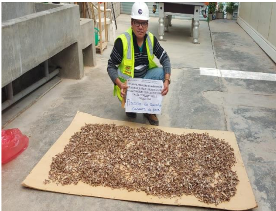
Figura 1. Proceso de secado con una reducción del 30% a su peso inicial.
