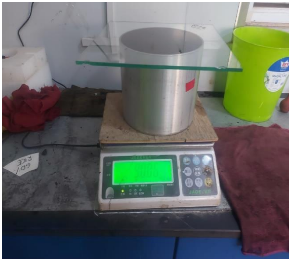
Figura 13. Peso del picnómetro más mezcla asfáltica aforado.
