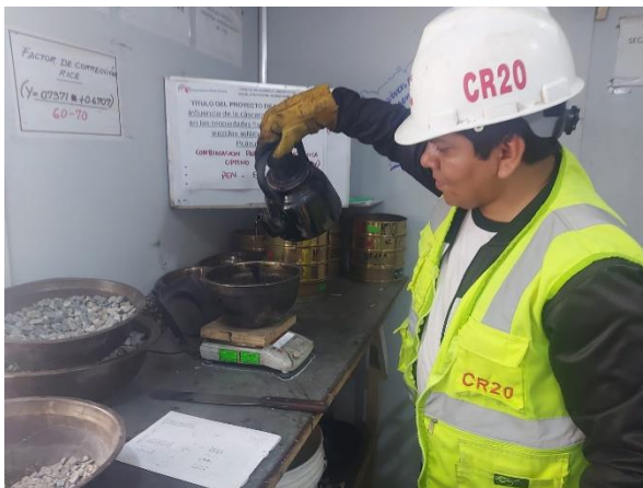
Figura 7. Adición del C.A. (85-100), a los agregados.
