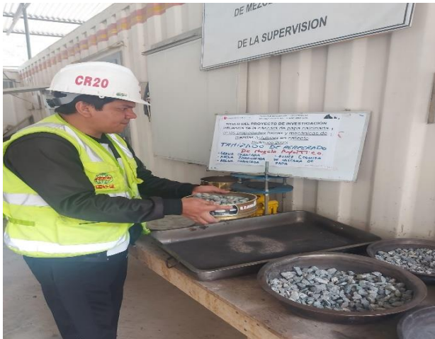
Figura 5. Características granulométricas de los agregados pétreos y el filler que ahora será remplazado por la ceniza de papa.
