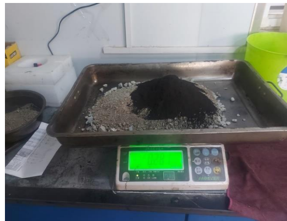
Figura 8. Peso de las combinaciones de los materiales aportantes para el diseño de mezcla asfáltica.
