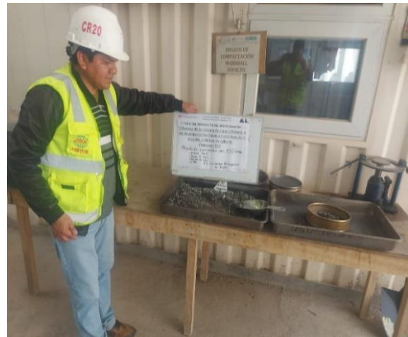
Figura 4. Análisis granulométrico mediante el proceso de tamizado de los materiales pétreos y la ceniza de cascara de papa.
