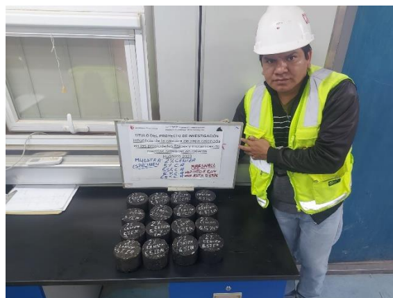
Figura 15. Especímenes con adiciones de ceniza de cascara de papa.
