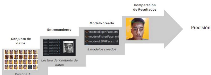
Figura 22: Procedimiento para pruebas con modelo EigenFace y LBPHFace
