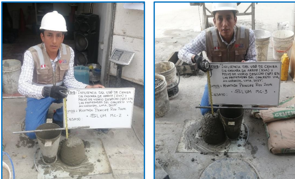
Figura 14. Ensayos de SLUM según ASTM C143 / NTP 339.035. Para muestras patrón.
