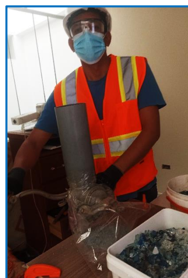
Figura 11. Vidrio reciclado, trituradas hasta lograr un tamaño aproximado de 1", para su posterior molido.
