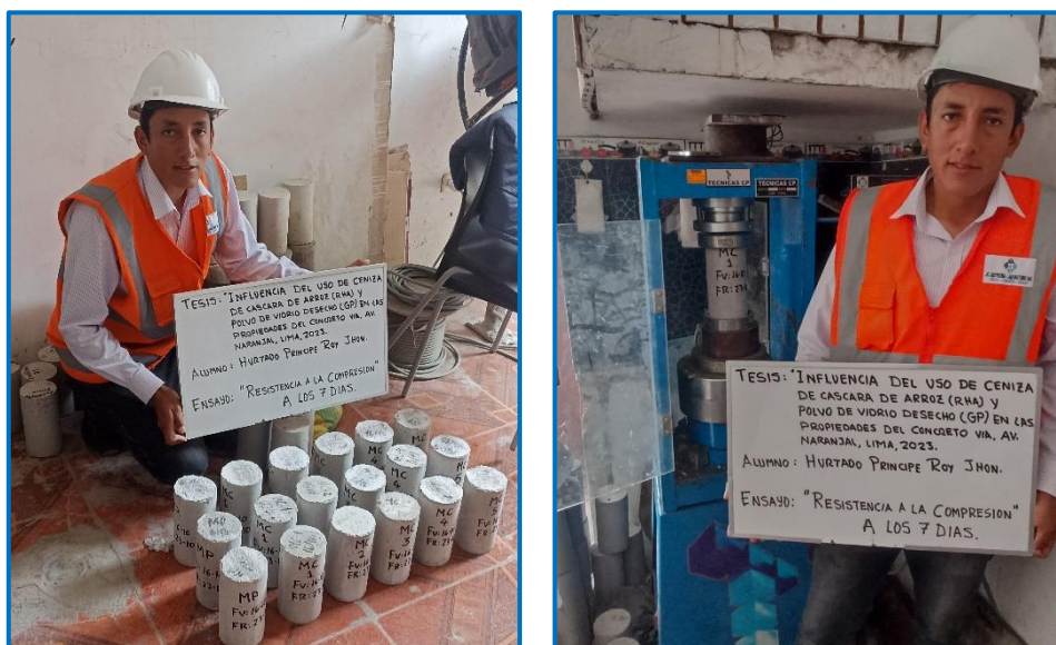
Figura 18. Ensayos de compresión para muestra patrón y muestras combinadas a 7 los días.
