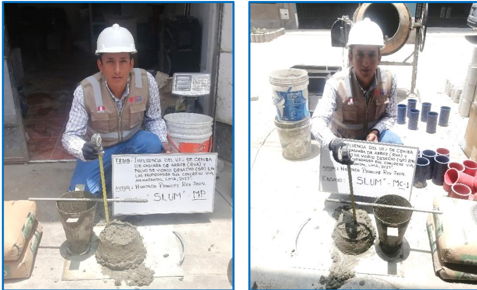
Figura 14. Ensayos de SLUM según ASTM C143 / NTP 339.035. Para muestras patrón.
