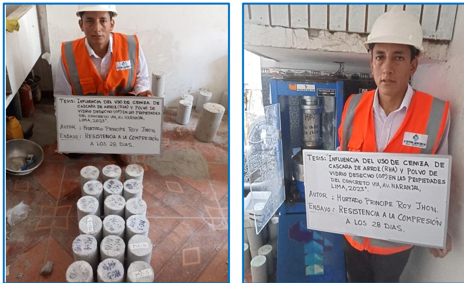
Figura 20. Ensayos de compresión para muestra patrón y muestras combinadas a 28 los días.
