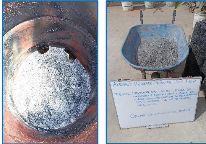
Figura 8. Resultado después del pre quemado, cuyo resultado es una ceniza en estado amorfo de color blanco.
