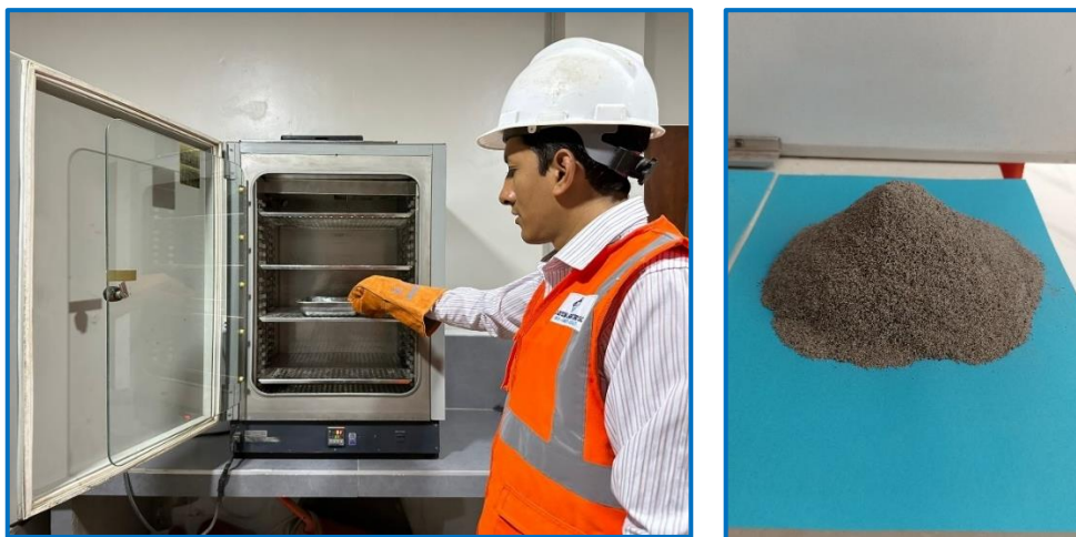
Figura 9. Incineración de RHA después del pre quemado, en horno eléctrico a temperatura de 600°C.
