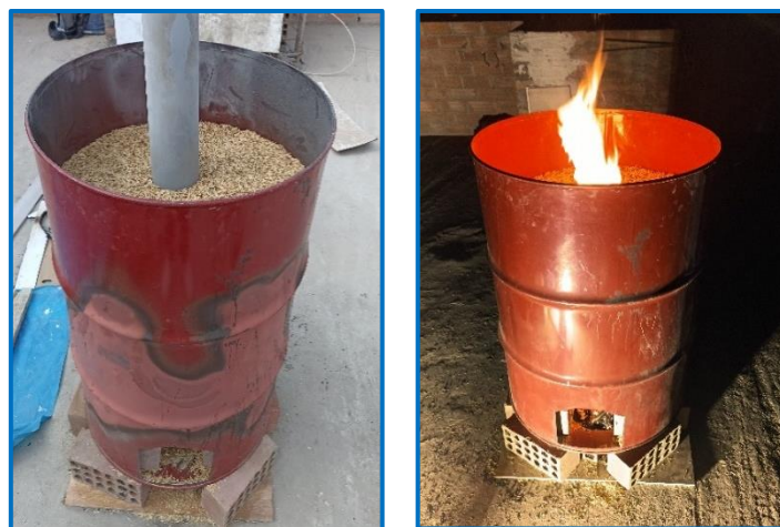
Figura 7. Proceso de pre quemado en un cilindro, durante 8 horas.
