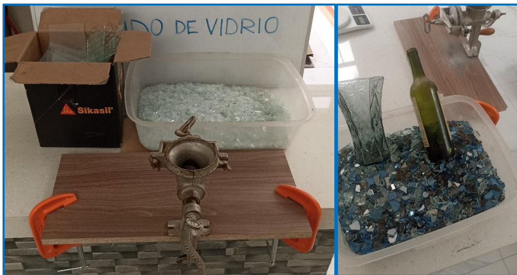
Figura 11. Vidrio reciclado, trituradas hasta lograr un tamaño aproximado de 1", para su posterior molido.
