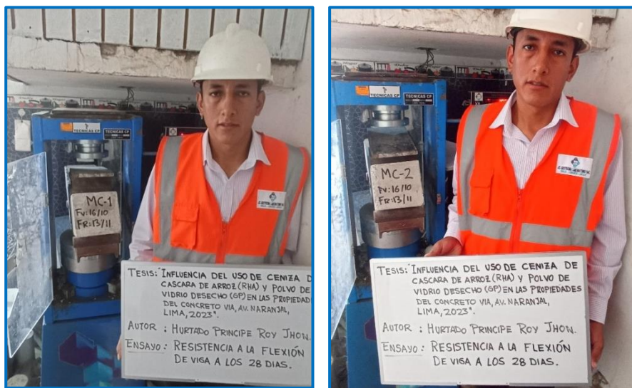
Figura 22. Ensayos de resistencia a la flexión del concreto para muestra patrón.
