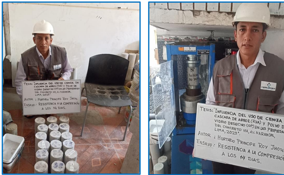
Figura 19. Ensayos de compresión para muestra patrón y muestras combinadas a 14 los días.
