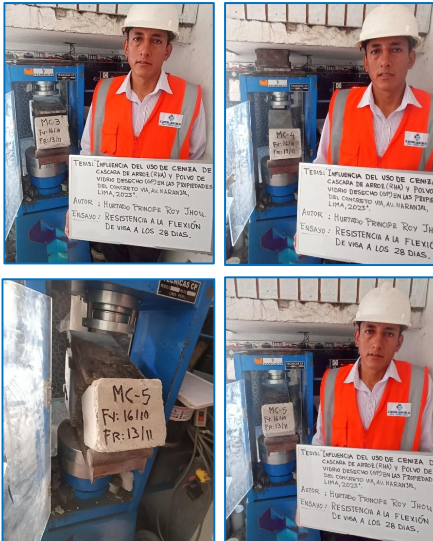
Figura 23. Ensayos de resistencia a la flexión del concreto para muestras combinadas.
