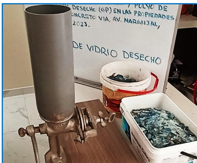
Figura 11. Vidrio reciclado, trituradas hasta lograr un tamaño aproximado de 1", para su posterior molido.
