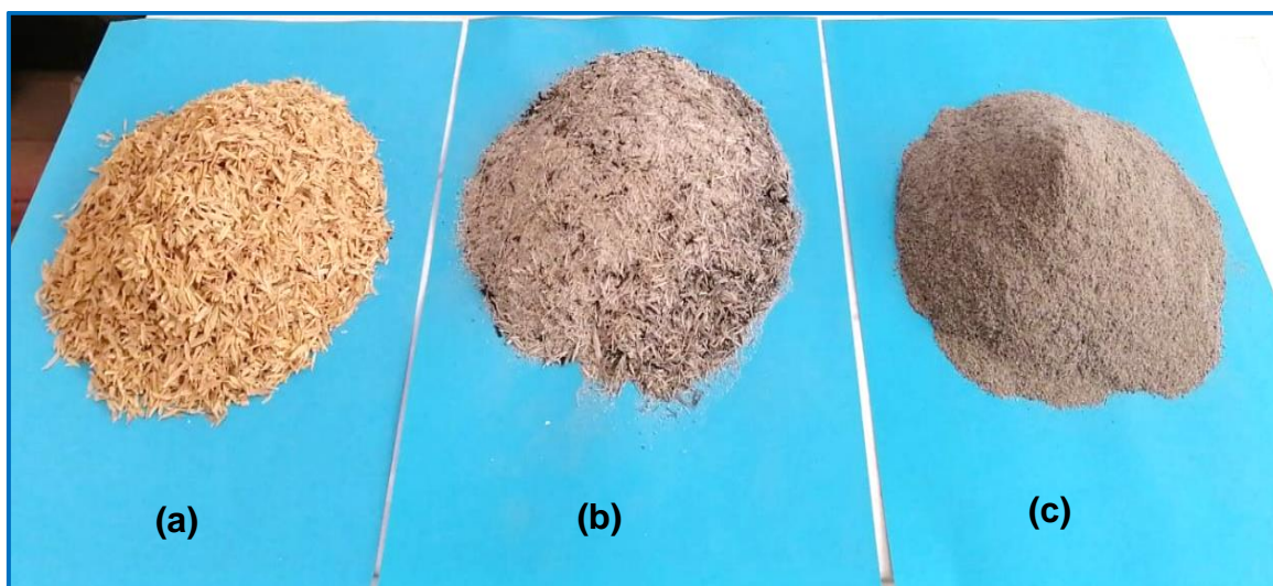
Figura 3. a)-Cáscara de arroz, (b)-Ceniza en estado amorfo pre quemado, (c)- Polvo de ceniza 150 \mu\text{m} , quemado a 600°C. Fuente: Elaboración propia
