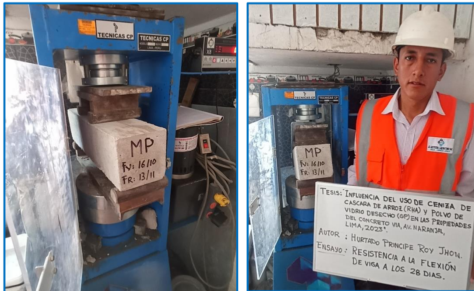
Figura 22. Ensayos de resistencia a la flexión del concreto para muestra patrón.
