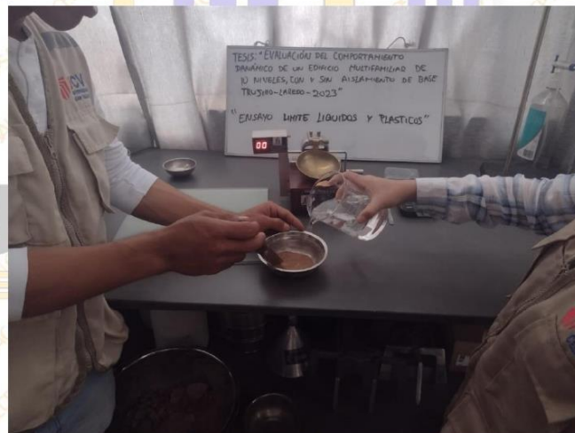
IMAGEN 3: Se puede apreciar el proceso del ensayo para obtener el índice de plasticidad del material extraído
