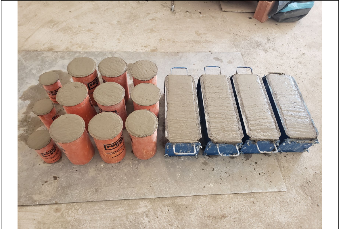
Elaboración de testigos cilíndricos y prismáticas f'c=210 \text{ kg/cm}^2
