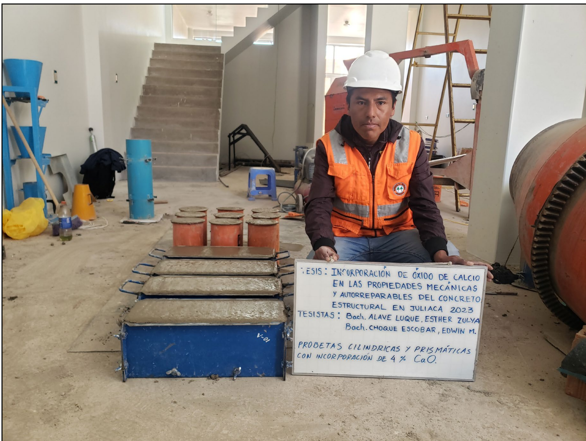
Elaboración de testigos cilíndricos y prismáticas f'c=210 kg/cm 2
