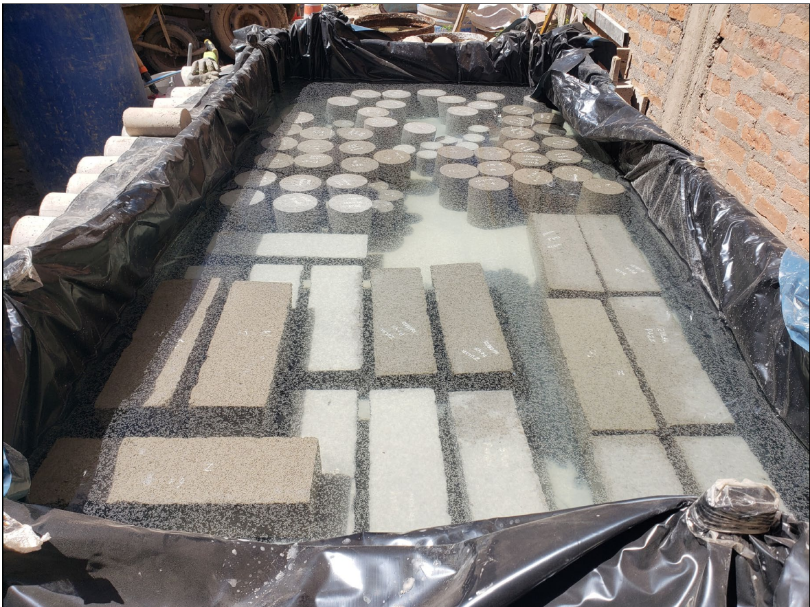
Curado de testigos cilíndricos y prismáticas f'c=210 \text{ kg/cm}^2
