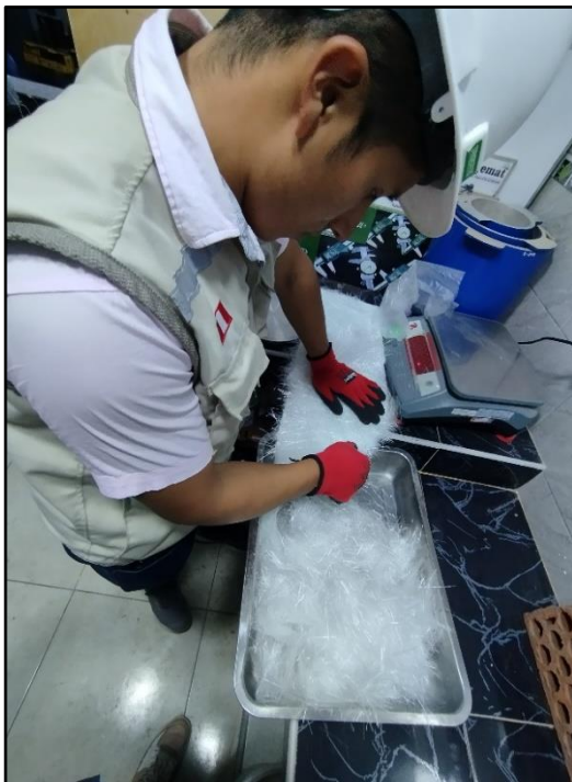
Nota: Proceso de deshilachado de la fibra de vidrio tipo E.
