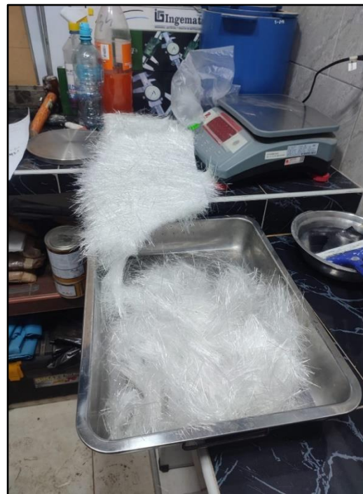
Nota: Proceso de deshilachado de la fibra de vidrio tipo E.
