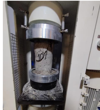
Figura 29. Rotura de probeta con 10% de perlas de poliestireno.
