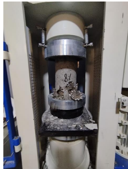
Figura 25. Rotura de probeta con 8% de perlas de poliestireno.
