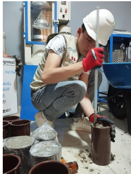
Figura 21. Realización de 25 golpes con la varilla.
