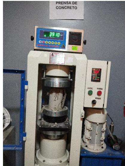
Figura 27. Rotura de probeta con 2% de perlas de poliestireno.
