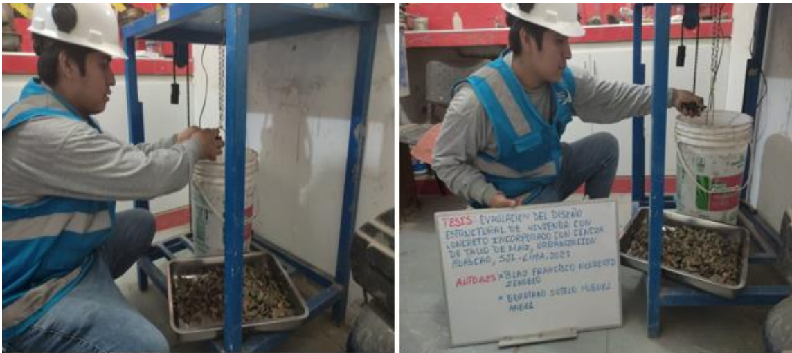
Figura 11. Gravedad específica de la piedra chancada.
