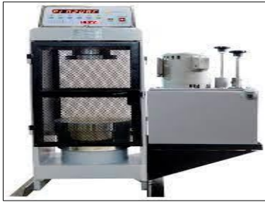
Figura 1. Máquina de ensayo a compresión
