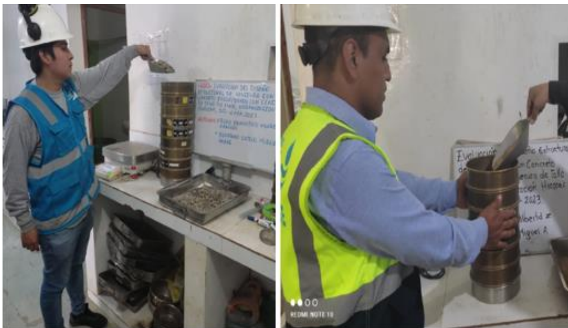
Figura 10. Tamizados de agregado fino y grueso.
