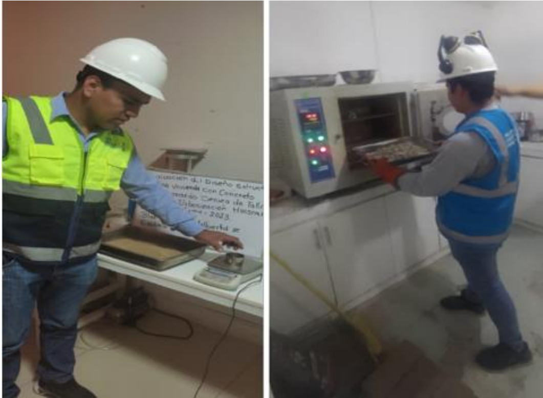
Figura 9. Ensayo de contenido de humedad de los agregados fino y grueso
