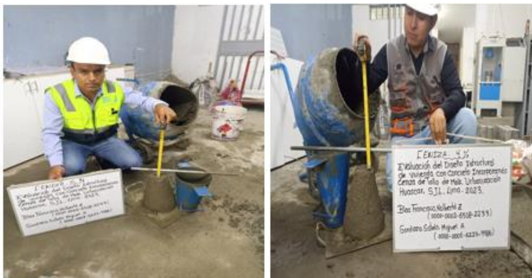
Figura 26. Ensayo de Slump para medir la trabajabilidad.
