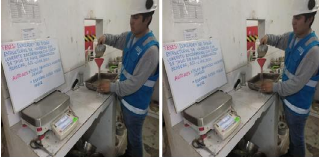
Figura 12. Gravedad específica de la arena gruesa.
