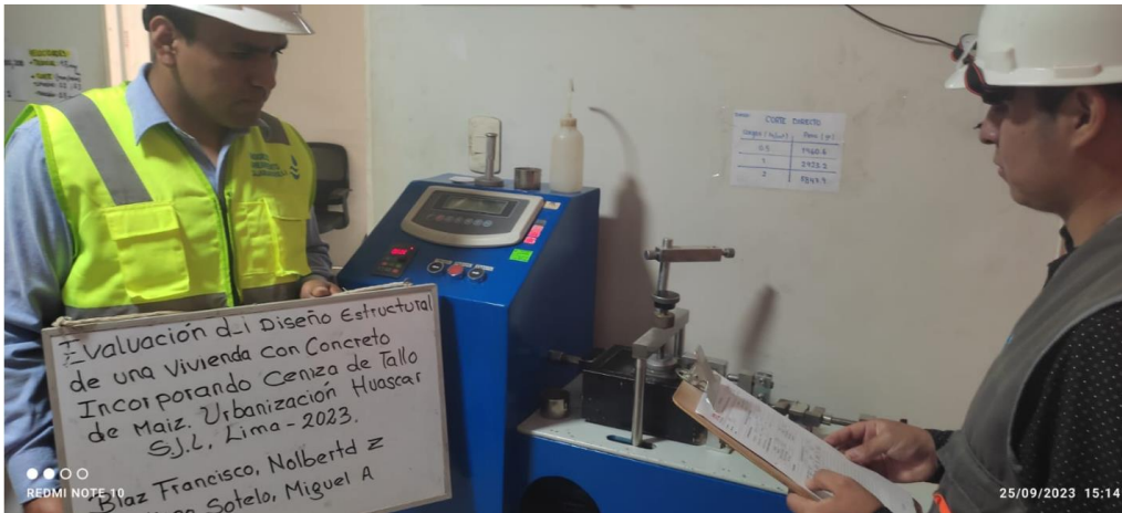
Figura 20. Ensayo de corte directo.
