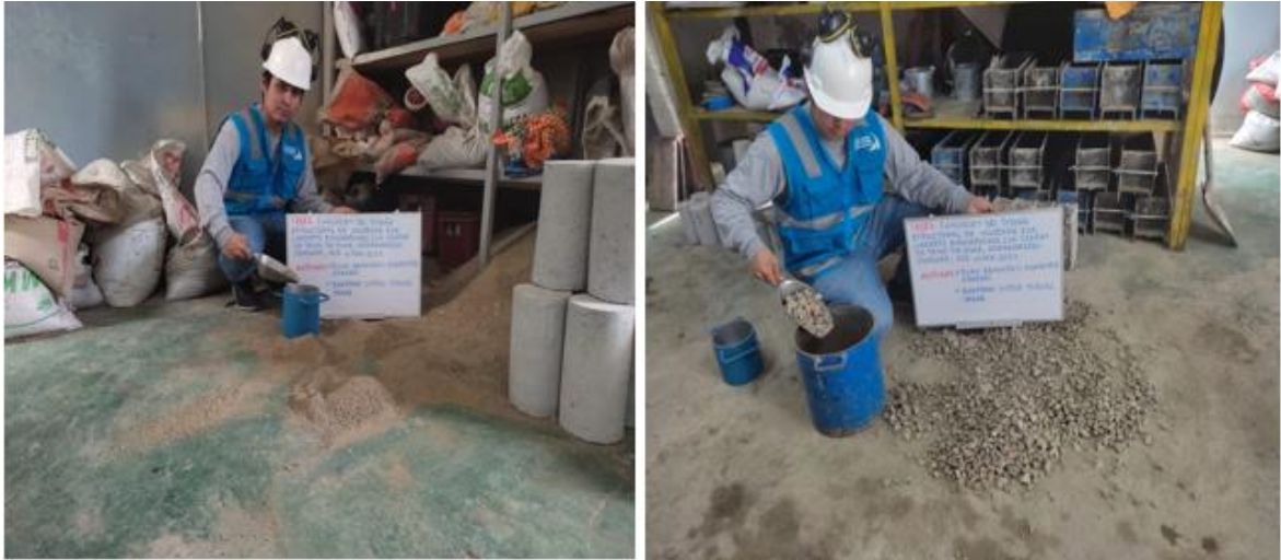
Figura 13. Peso unitario suelto y compactado de los agregados.
