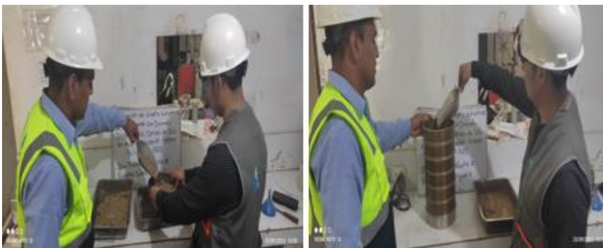
Figura 18.Tamizado de la muestra obtenida de la calicata.
