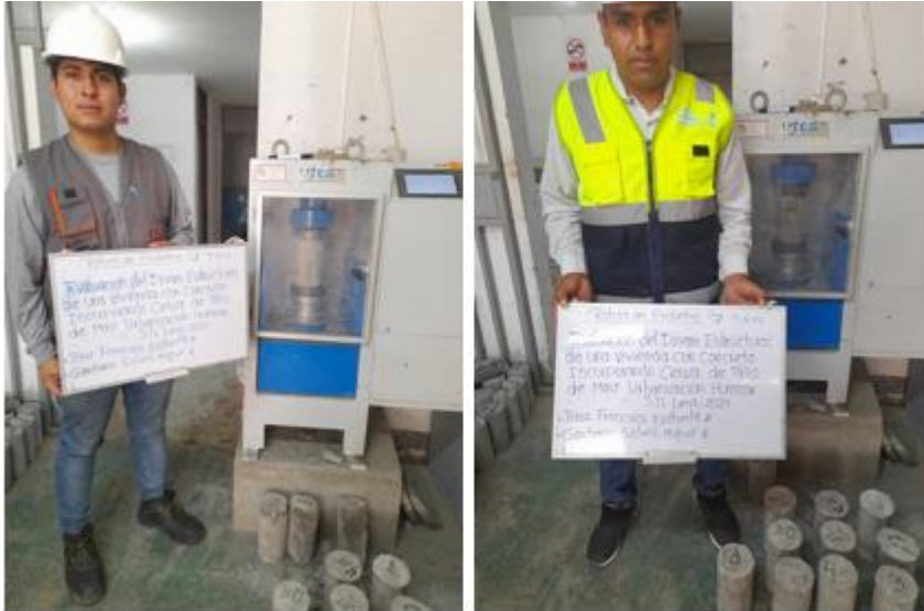
Figura 15. Rotura a compresión de muestras cilíndricas de concreto.
