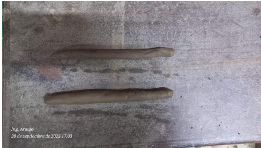
Figura 13 Ensayo de la cinta de barro
