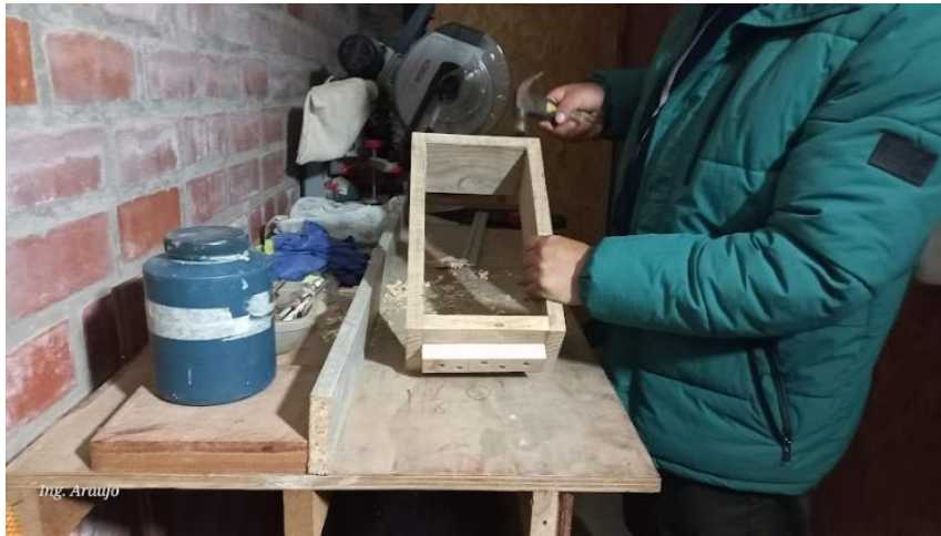
Figura 11 Construcción de la adobera
