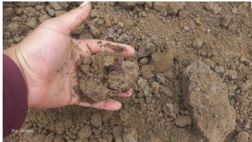
Figura 12 Verificación del suelo para el adobe
