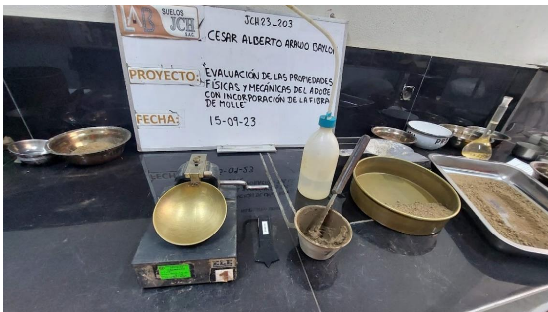
Figura 34 Análisis de plasticidad en la copa de Casagrande
