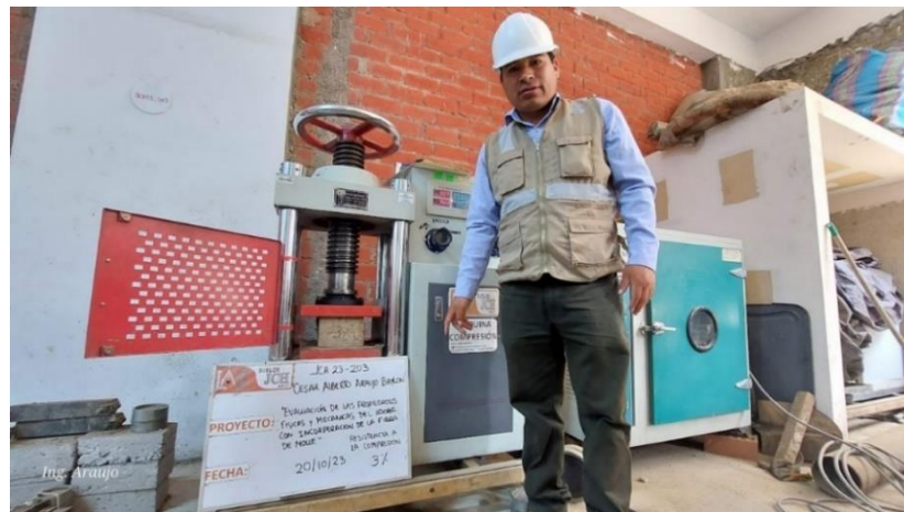
Figura 25 Ensayo a la resistencia a la compresión
