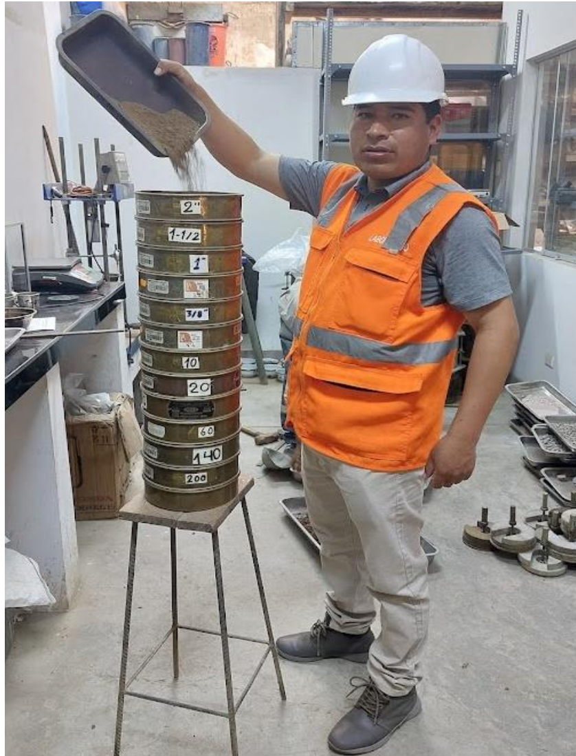
Figura 31 Ensayo granulométrico de la tierra
