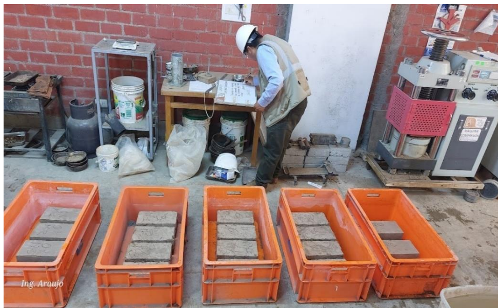
Figura 23 Ensayo a la absorción
