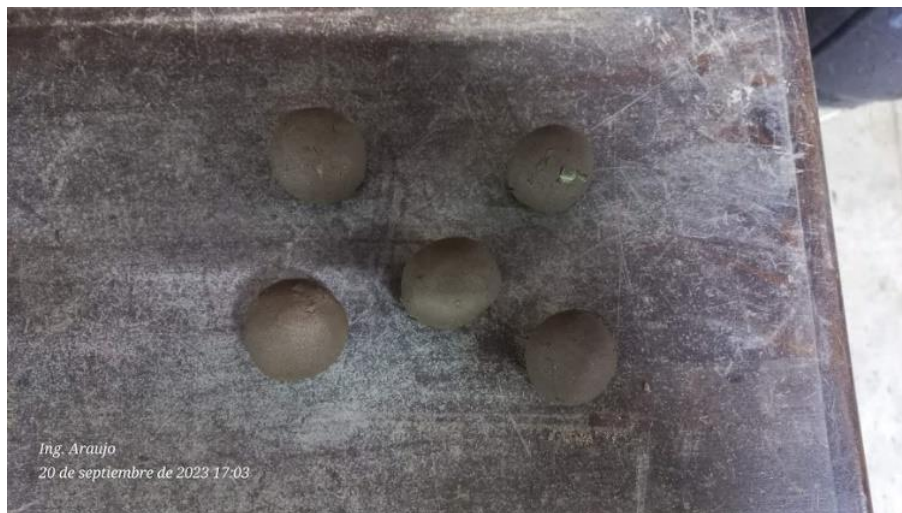
Figura 14 Ensayo de la resistencia seca del barro
