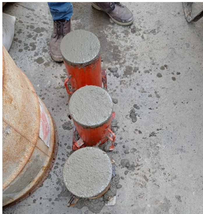
Imagen 17. Las probetas compactadas con el concreto f'c = 175 \text{ kg/cm}^2
