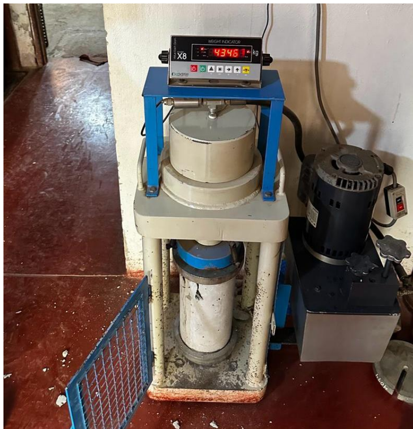
Imagen 20. Rotura de probetas a los 7 días
