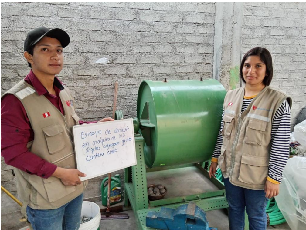
Imagen 11. Estudiantes realizando el ensayo de abrasión los ángeles para el agregado grueso
