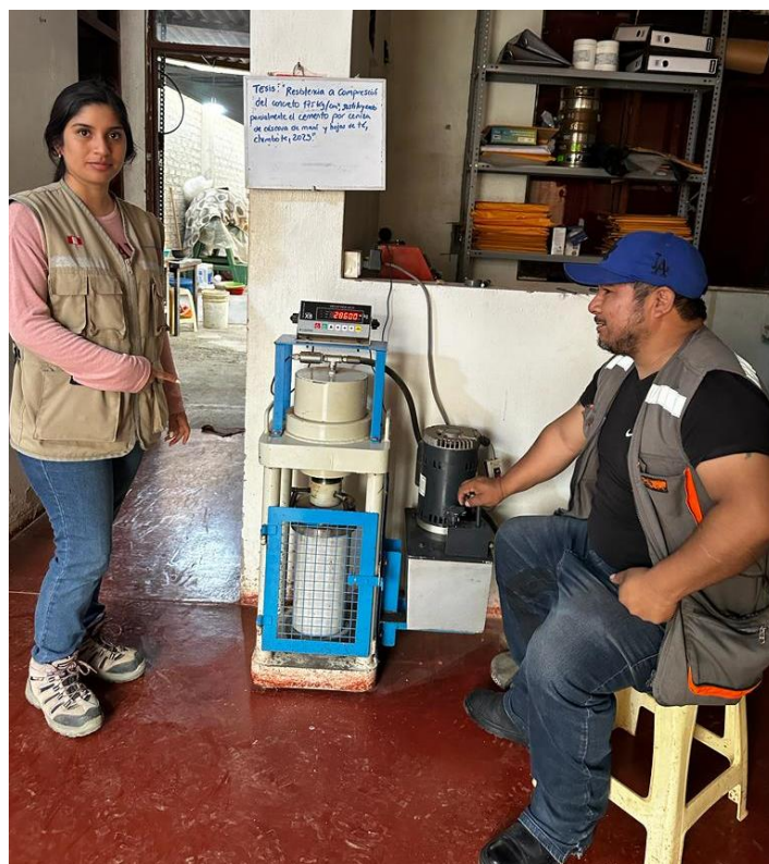
Imagen 21. Rotura de probetas a los 28 días
