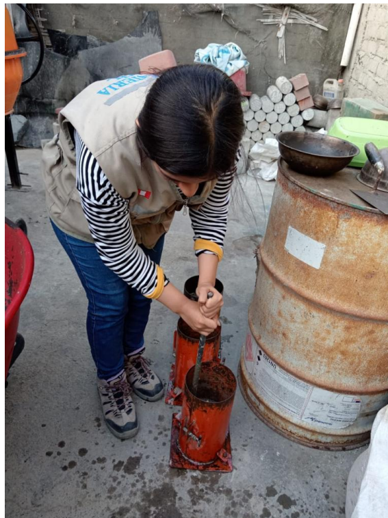
Imagen 15. Realizando la compactación por capas en las probetas
