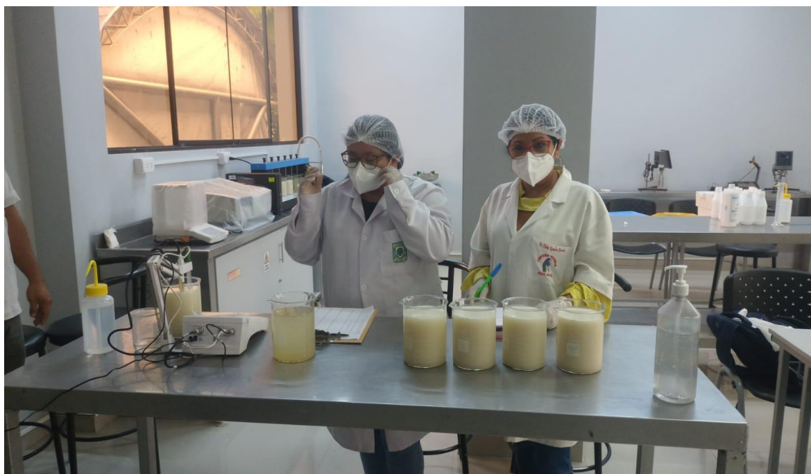
Anexo 24: Sistema de jarras en reposo
