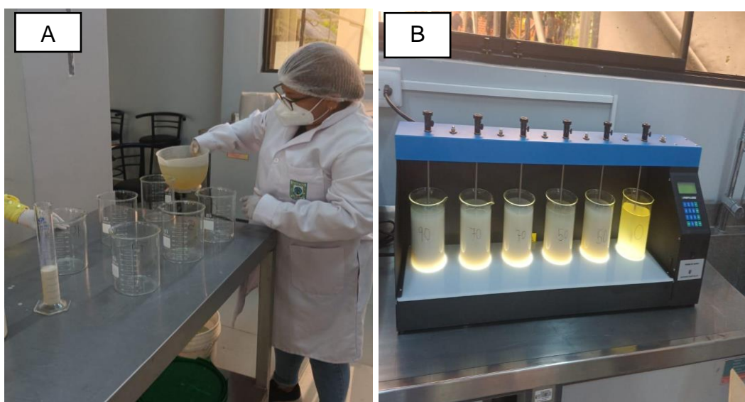
Figura 5: Proceso de tratamiento de las aguas residuales domésticas a dosis diferentes de los coagulantes de semillas de Jatropha curcas .
