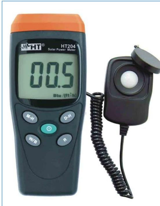
Figura 10. Solarímetro Digital
