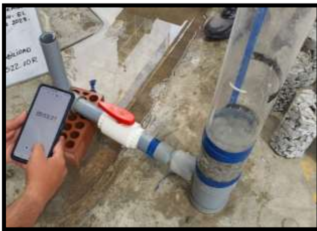
Figura 14. Ensayo de permeabilidad - permeámetro de carga variable
