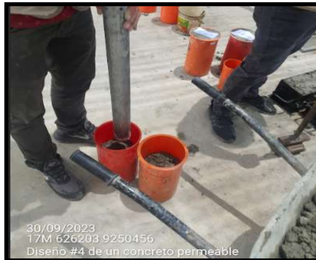
Figura 08. Compactación de testigos para ensayo de resistencia a compresión
