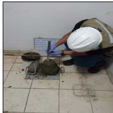
Figura 21. Asentamiento del concreto Fuente: Elaboración propia
