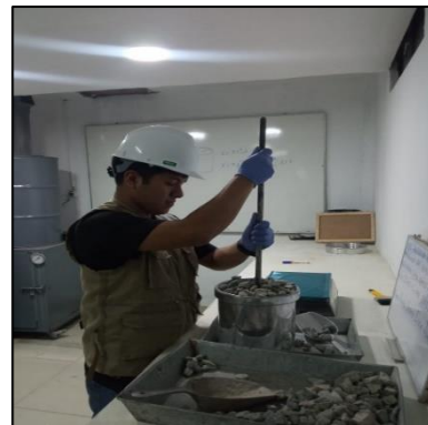
Figura 47. Compactación de agregado grueso Fuente: Elaboración propia
