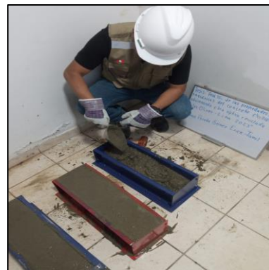
Figura 16. Elaboración de vigas Fuente: Elaboración propia
