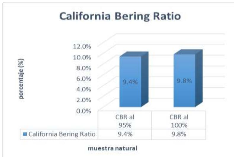
Figura N° 18: Prueba CBR del suelo natural.
