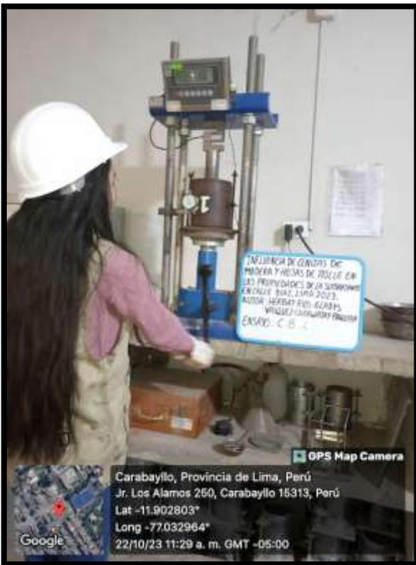
Imagen 19: CBR de C-01 con la adición de cenizas de hojas de molle a un 2.5%
