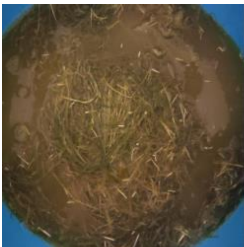
Figura 29. Aplicación con cal y el secado de la fibra de lino
