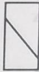
Tipo 4 Fractura diagonal sin fibras a través de los extremos, golpeado suavemente con un martillo para distinguirla del tipo 1.
