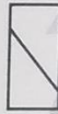
Tipo 4 Fractura diagonal sin fisuras a través de los extremos, golpeo suavemente con un martillo para distinguirla del tipo 1.
