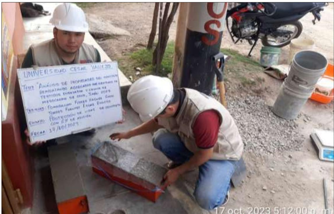
Protección del concreto de vigas para el 6% de sustitución
