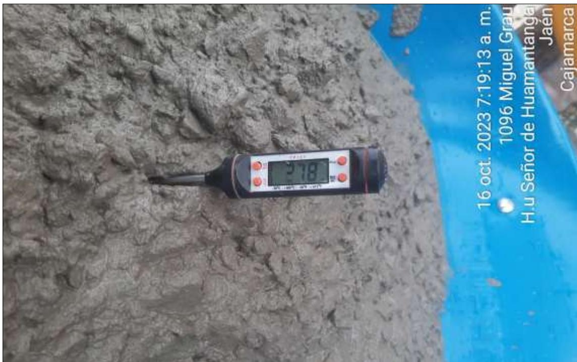
Medición de la temperatura del concreto con un valor de 27.8°C
