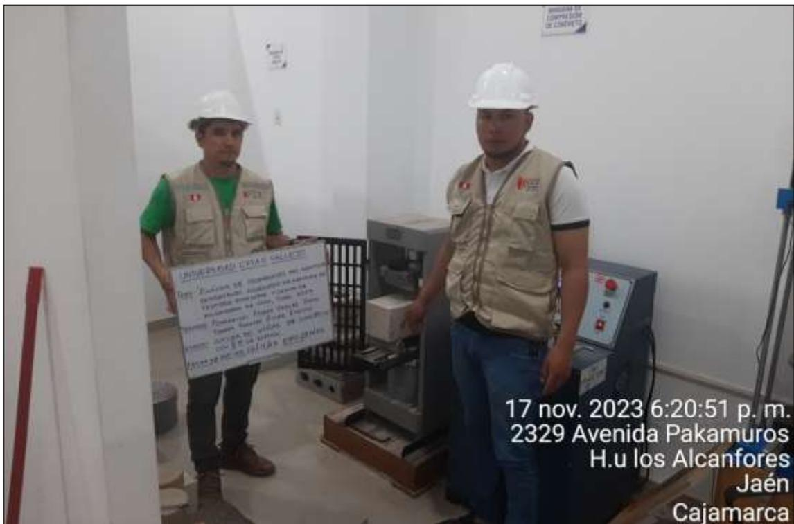
Rotura de vigas de concreto con 8% de sustitución
