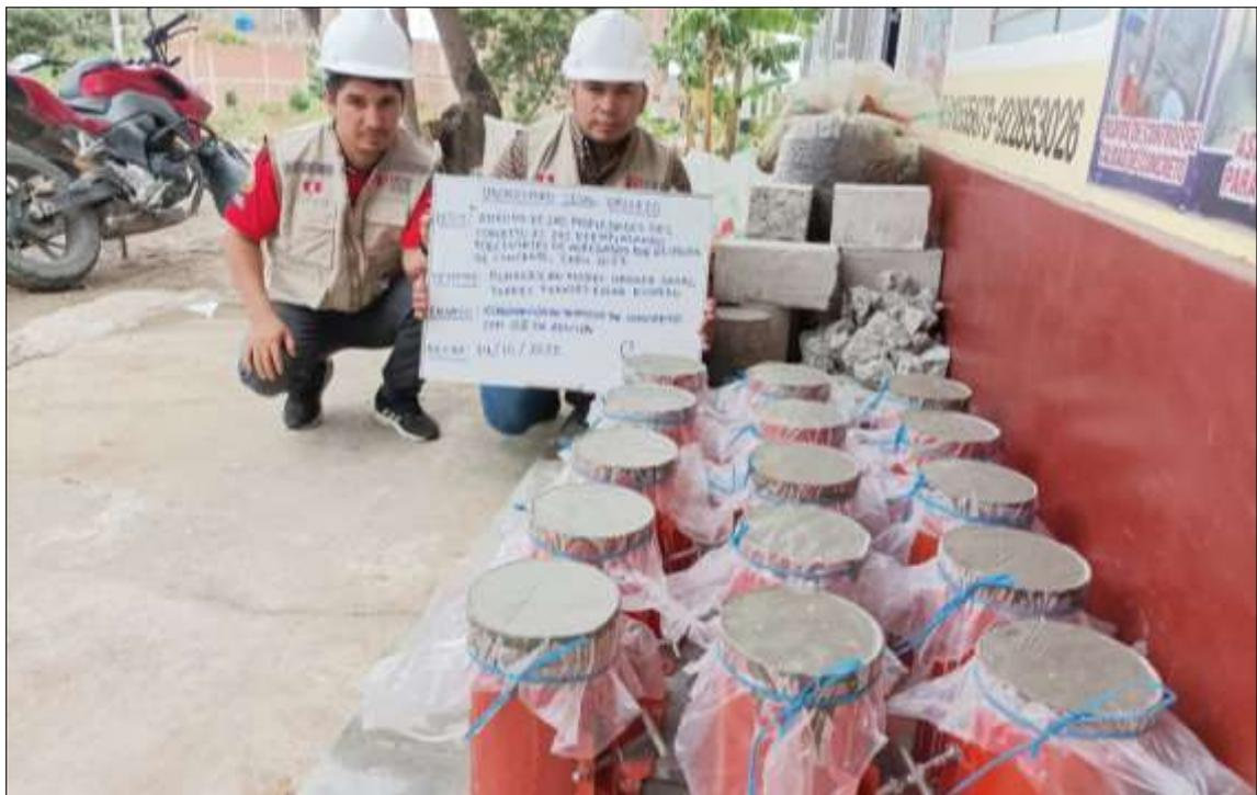
Protección del concreto para el 0% de sustitución
