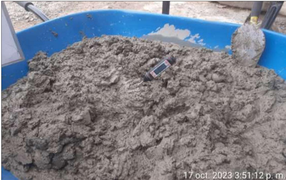
Medición de la temperatura del concreto con un valor de 30.4°C
