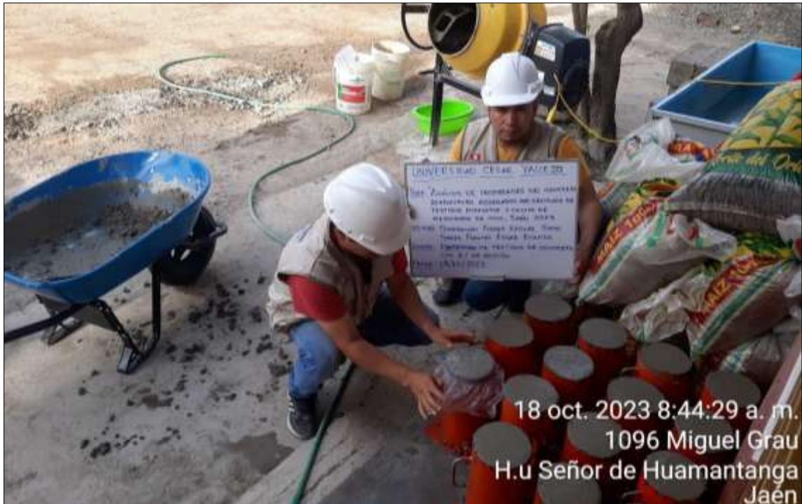
Protección del concreto para el 8% de sustitución
