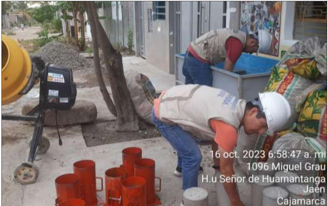
Desmoldado de testigos de concreto
