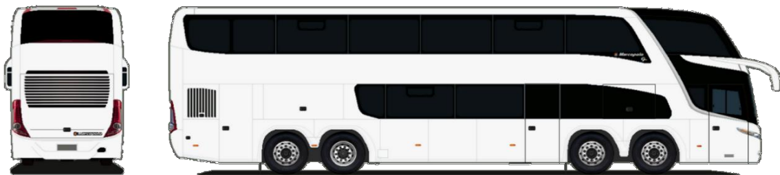
Figura 54. Autobús de 60 pasajeros de cuatro ejes; (Fuente: Catálogo Marcopolo)
