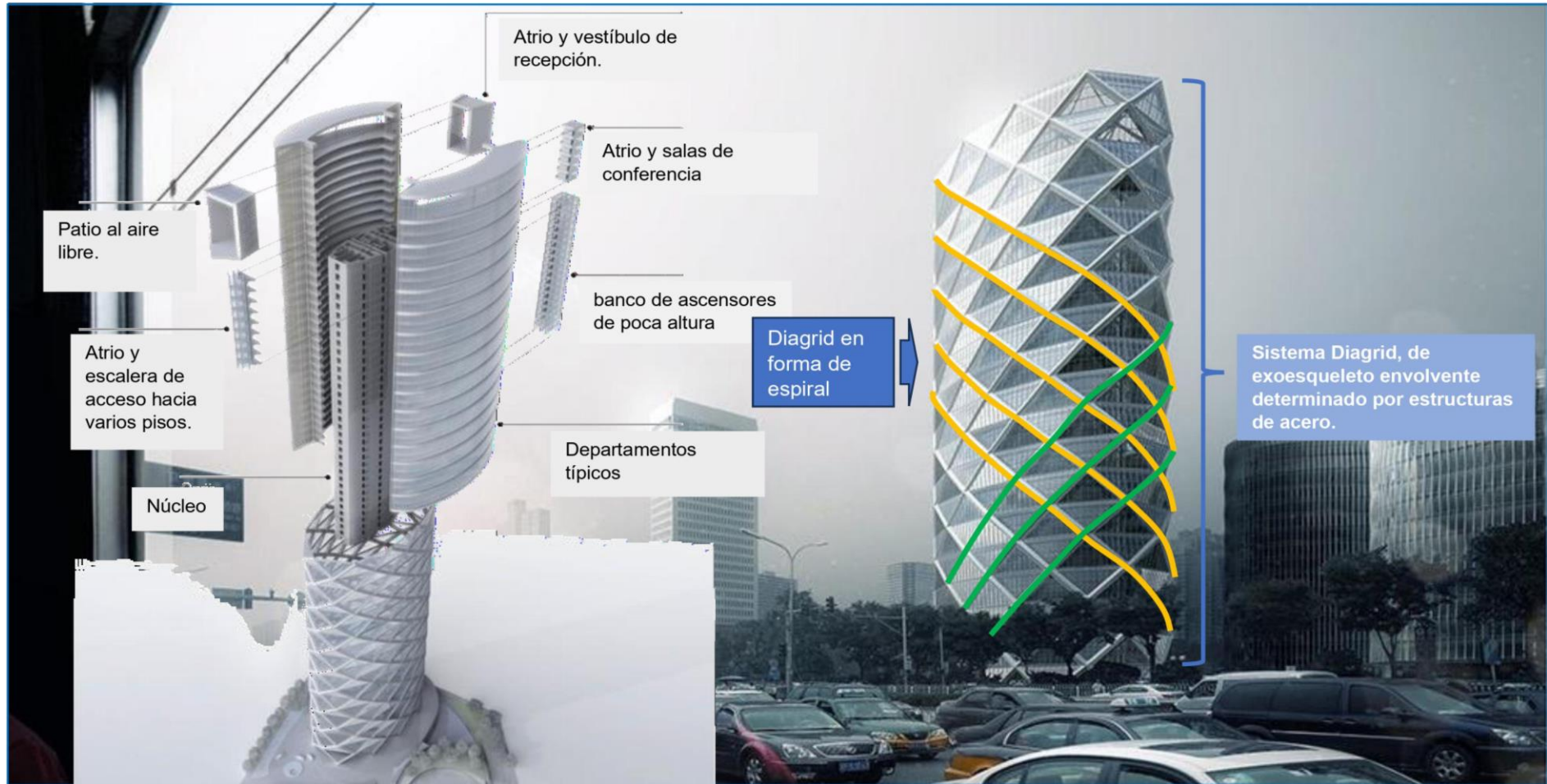
Anexo 23. Edificio, Poly internacional Plaza, (Beijing - China); construido a través de la aplicación del sistema estructural Diagrid.
