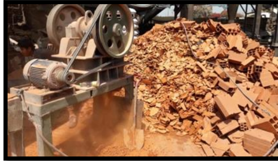
Figura 12. Proceso Chancado de polvo de ladrillo
