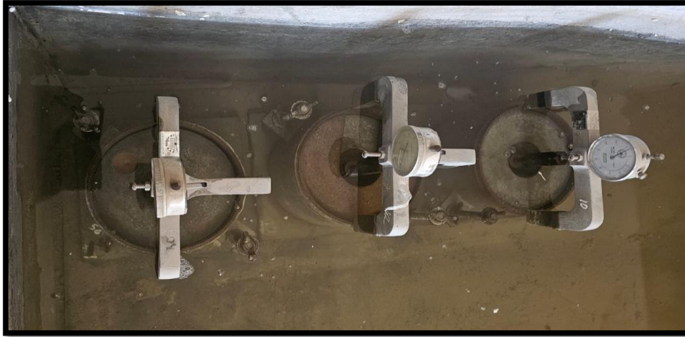
Figura 21. Procesos de diseño de CBR de ladrillo pulverizado y ceniza volante
