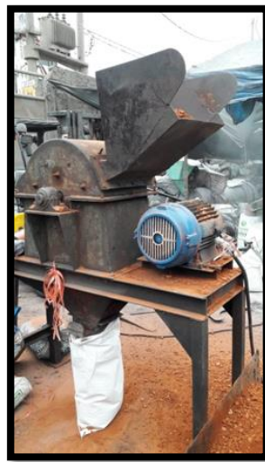
Figura 14. Proceso el pulverizado en la chancadora de polvo de ladrillo
