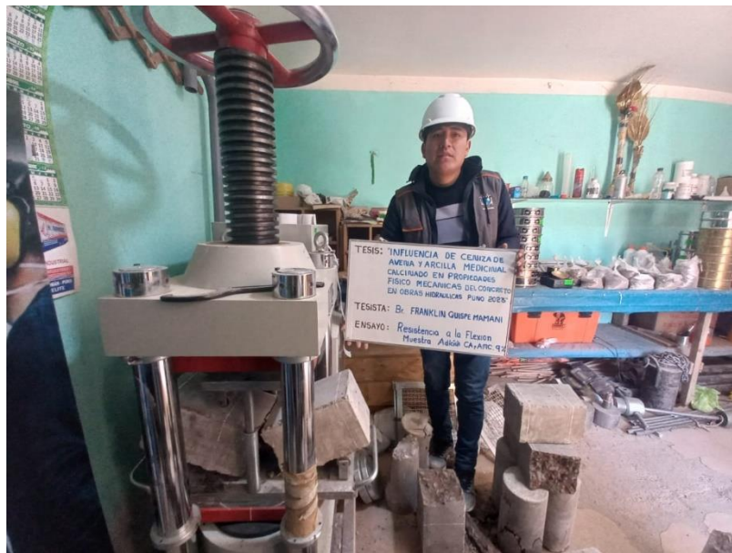
Fotografía 8. Rotura de vigas a flexión
