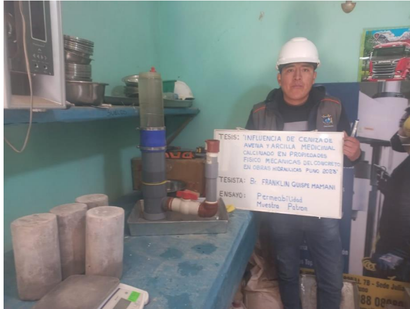
Fotografía 9. Prueba de permeabilidad
