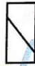
Tipo 4 Fractura diagonal sin fisuras a través de los extremos, golpeado suavemente con un martillo para distinguirla del tipo 1.
