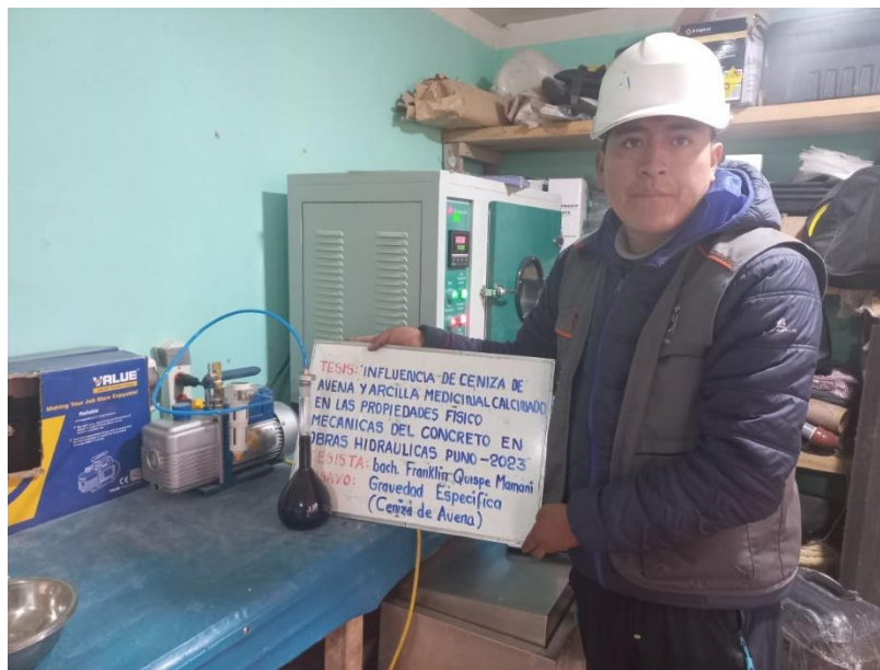
Fotografía 4. Gravedad específica de la ceniza de avena
