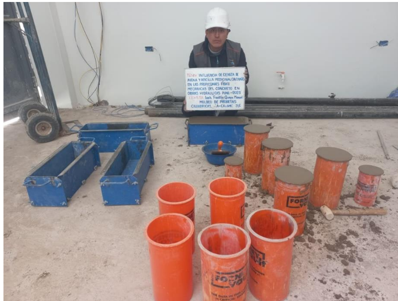
Fotografía 6. E4laboracion de especímenes
