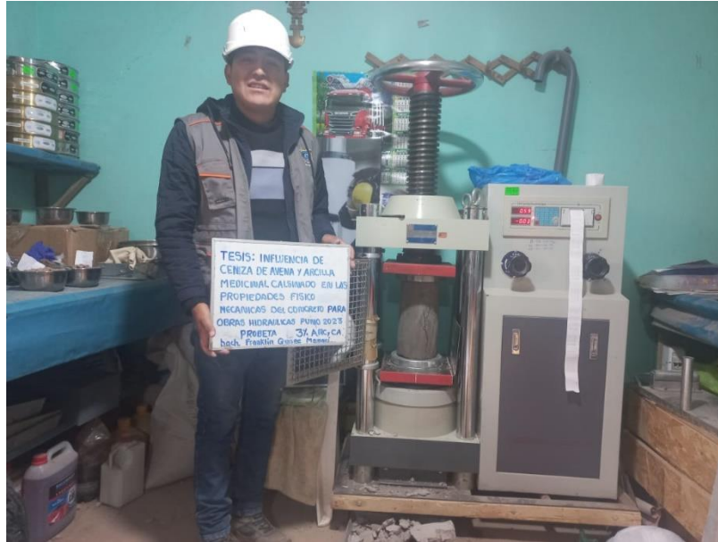
Fotografía 7. Rotura de probetas a compresión
