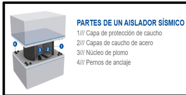
**Figura N°3.** Partes de un aislador con núcleo de plomo
