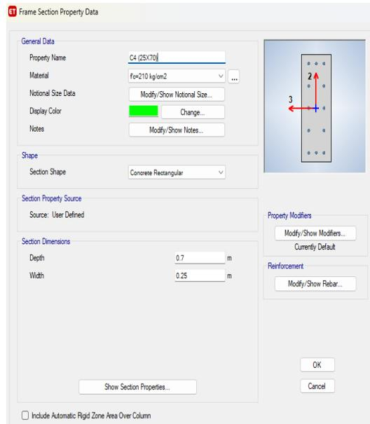
**Figura N°18.** Definición de columna C4
