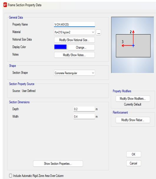
**Figura N°22.** Definición de la viga V-CH
