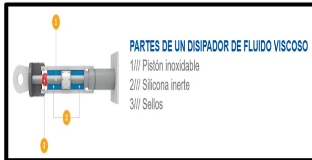
**Figura N°6.** Partes de un disipador de fluido viscoso tipo Taylor
