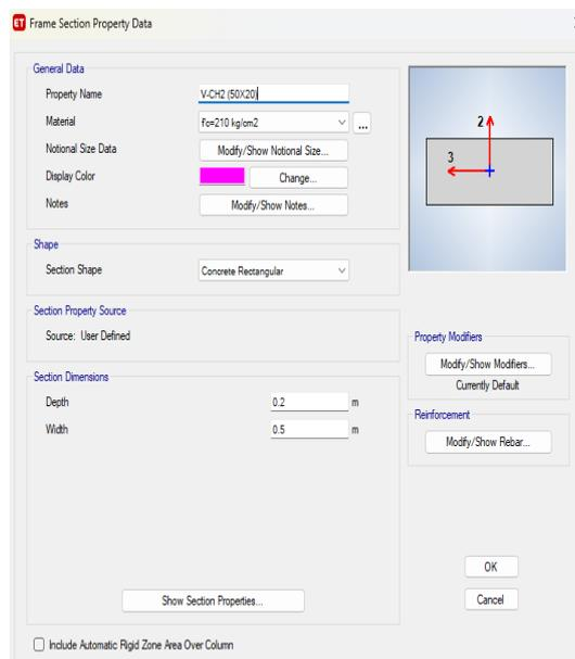
**Figura N°23.** Definición de la viga V-CH2
