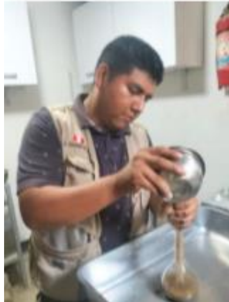
Imagen 09. El agregado fino se introduce en la fiola.
