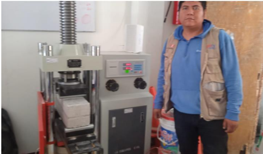
Imagen 16. Rotura de probetas (ensayo de resistencia a la flexión)
