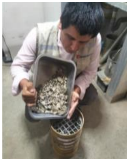
Imagen 02. Colocando el agregado en el Tamiz.
