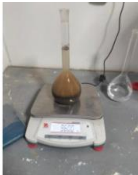
Imagen 10. Pesado de la fiola + agua + agregado fino.
