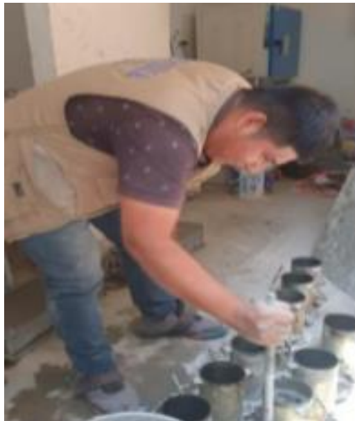
Imagen 12. Elaboración de testigos.
