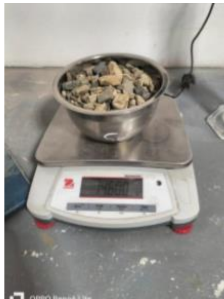
Imagen 06. Pesado de agregado seco.
