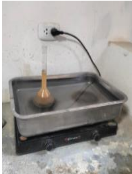
Imagen 11. Eliminación de aire.
