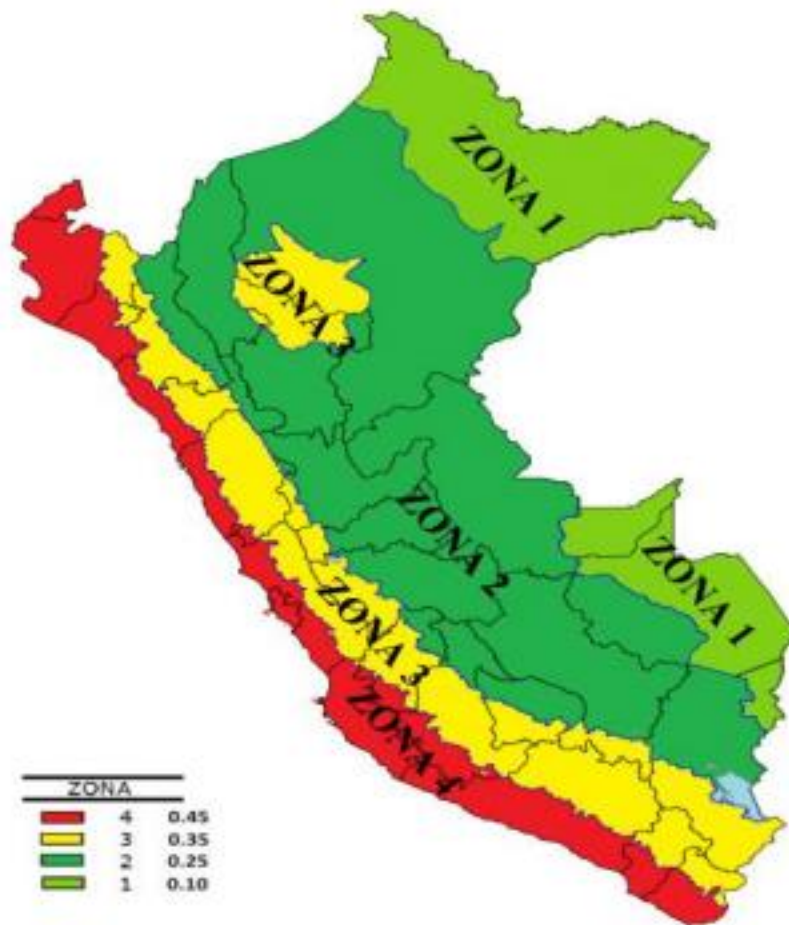
Figura 2. Mapa de Zonificación, Norma E030 de diseño sismorresistente.
