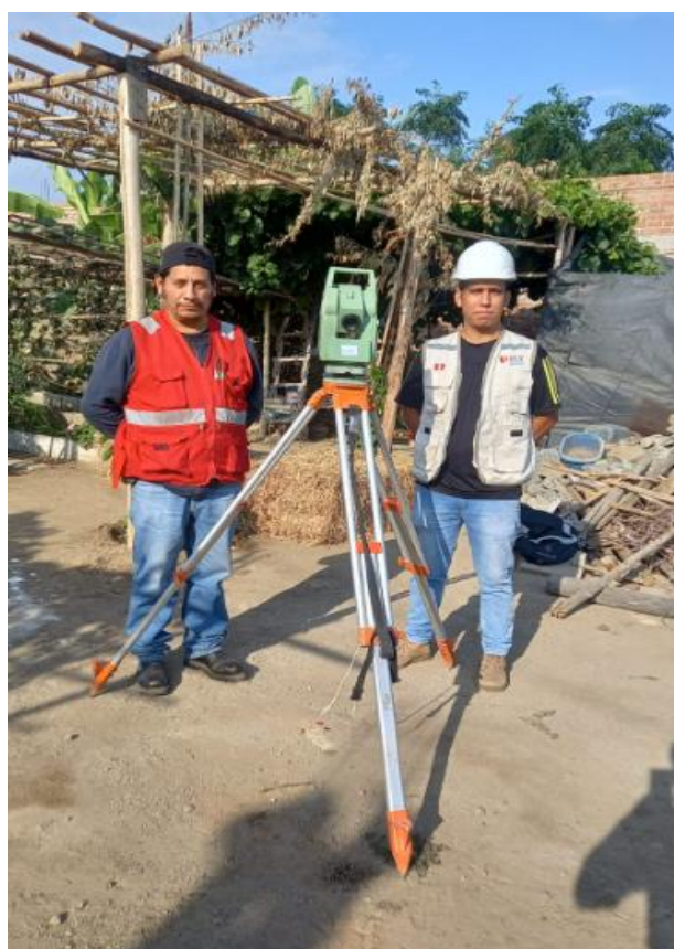
Levantamiento Topográfico con estación total.
