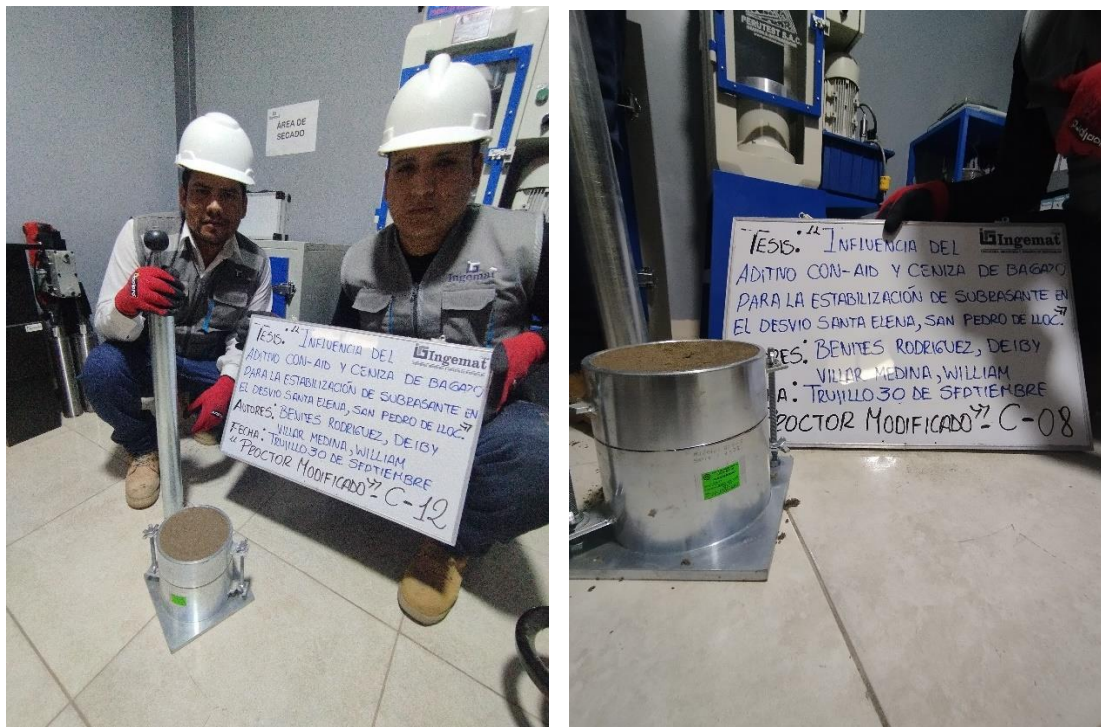
Figura 41. Molde compactado para pesar del ensayo de Proctor modificado,
