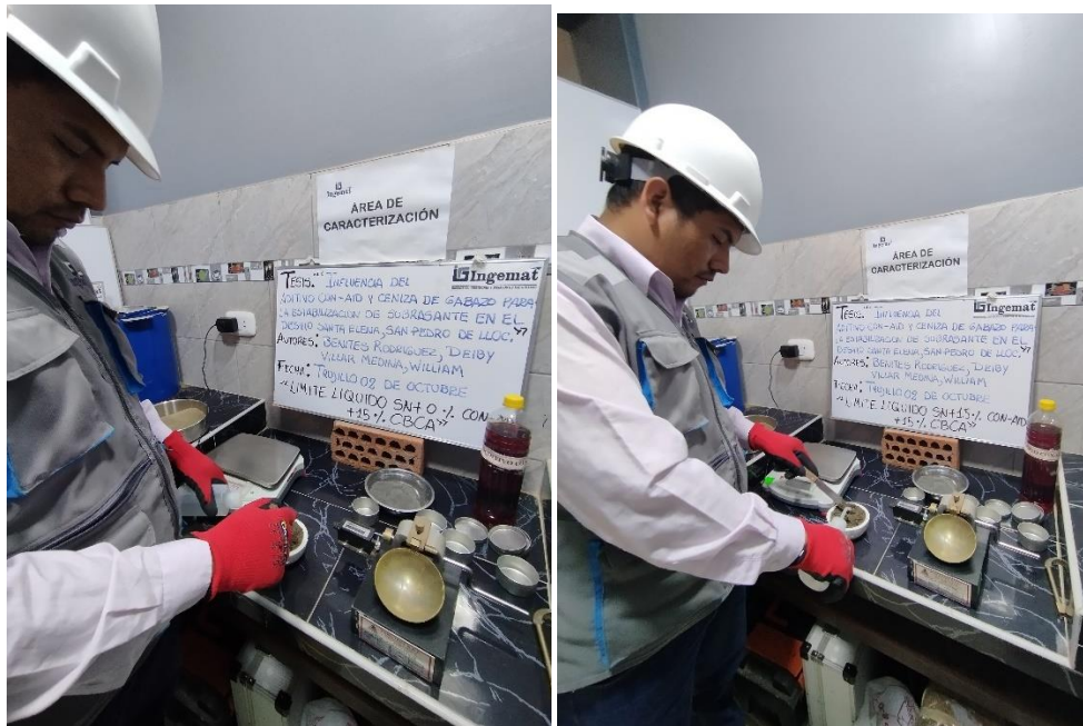
Figura 47. Ensayo de límite líquido con la adición de aditivo CON-AID y CBCA
