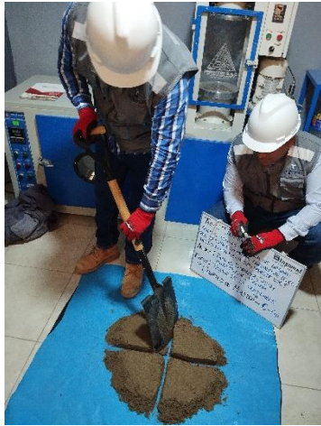
Figura 8. Cuarteo de la muestra.
