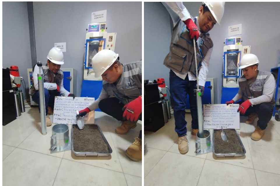
Figura 45. Inicio del ensayo de Proctor modificado con adición de aditivo CON-AID y CBCA
