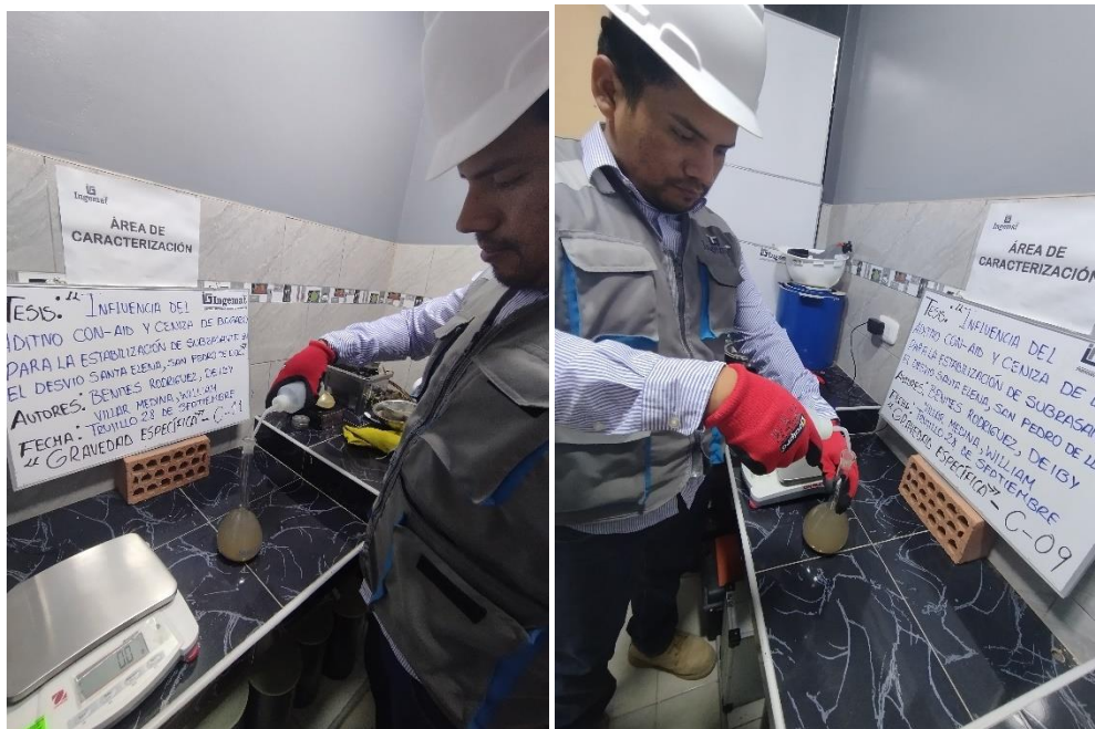
Figura 39. Ensayo de gravedad específica, colocación de agua destilada
