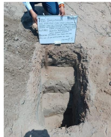
Figura 2. Profundidad a 1.50 m, calicata N° 5.
