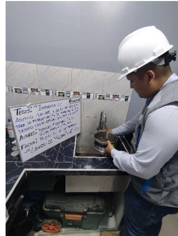
Figura 9. Lavado de muestra malla N° 200.
