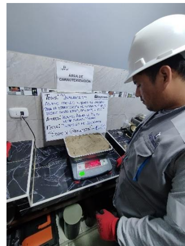
Figura 10. Pesado de muestra seca.
