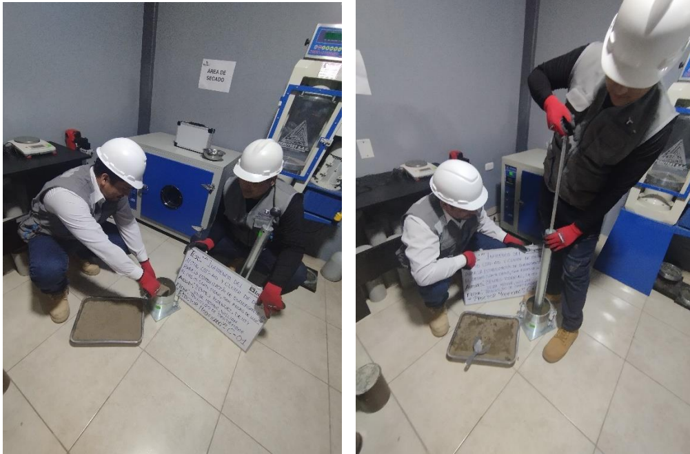
Figura 40. Colocación de muestra en el molde para el ensayo de Proctor modificado
