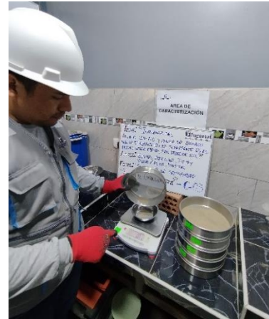
Figura 13. Peso del material que pasa de las mallas.
