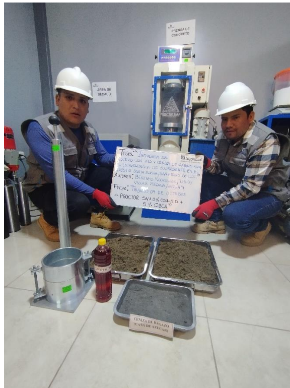
Figura 43. Ensayo de Proctor modificado con adición de aditivo CON-AID y CBCA
