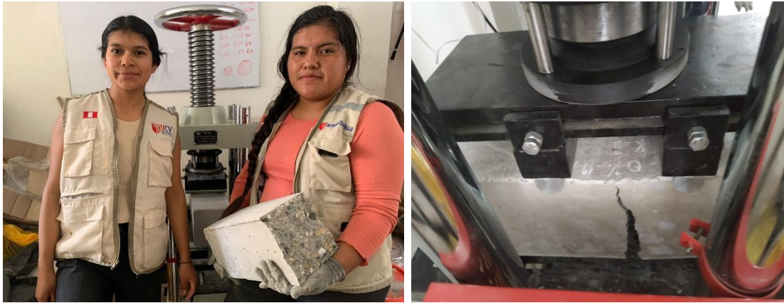
Figura N° 16.- Ensayo de vigas a los 28 días de curado.
