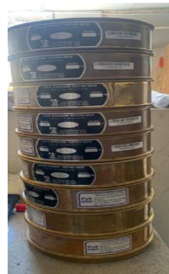
Figura N° 8.- Equipamiento para el análisis granulométrico
