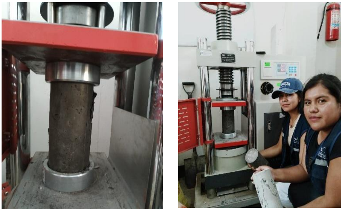
Figura N° 13.- Ensayo de las muestras a los 7 días de curado.
