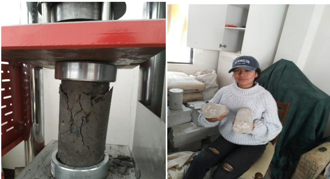
Figura N° 15.- Ensayo de muestras a los 28 días de curado.
