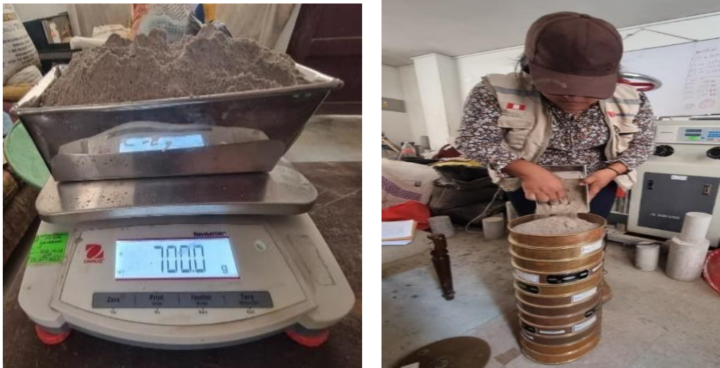
Figura N° 12.- Análisis granulométrico de la ceniza.
