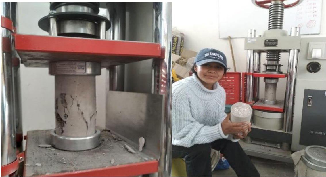
Figura N° 14.- Ensayo de muestras a los 14 días de curado.
