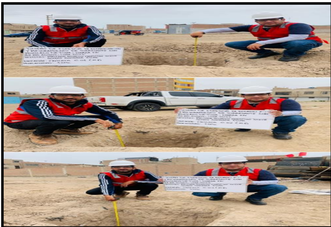
Figura 21. Calicatas in situ C-1, C-2, C-3
