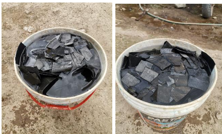
Figura 31. Llantas cortadas remojados en agua con alcohol poli vinílico usando el método de remojo en agua con hidróxido de sodio
