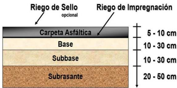
Figura 18. Capa de rodadura de un pavimento flexible
