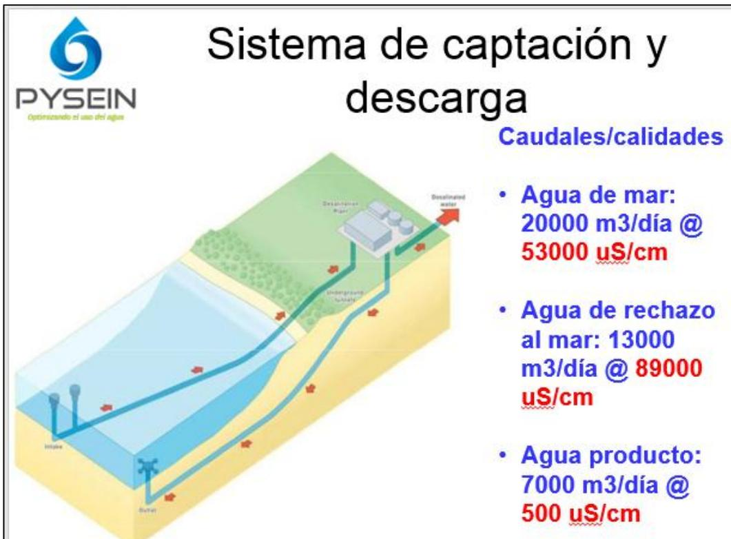
Figura 09. Esquema de Sistema de captación y descarga
