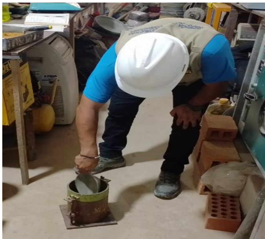
Imagen 08: ensayo de Proctor.
