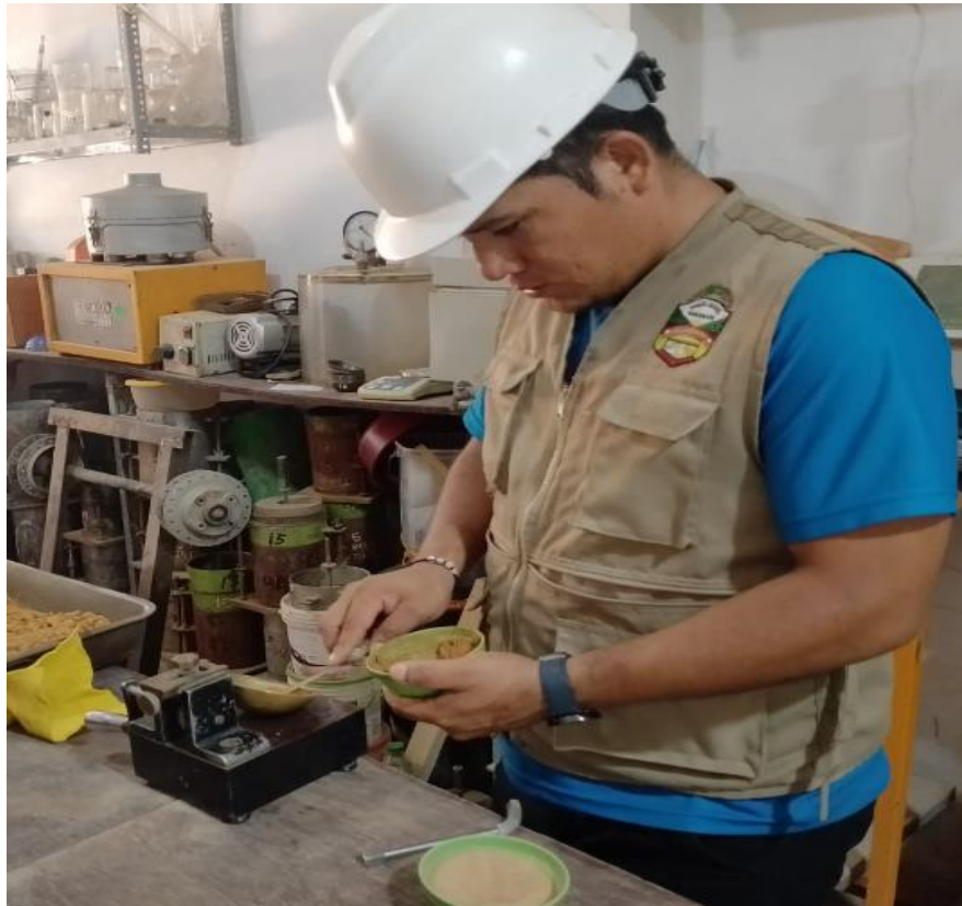
Imagen 04: ensayo de casa grande.
