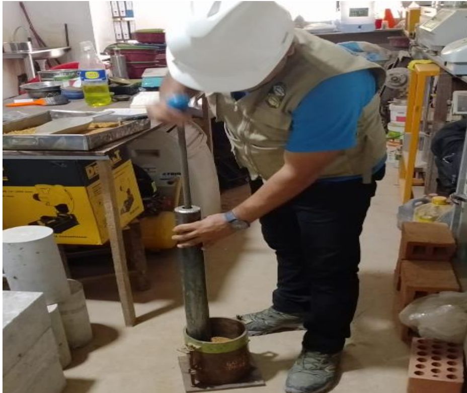
Imagen 07: ensayo de Proctor.
