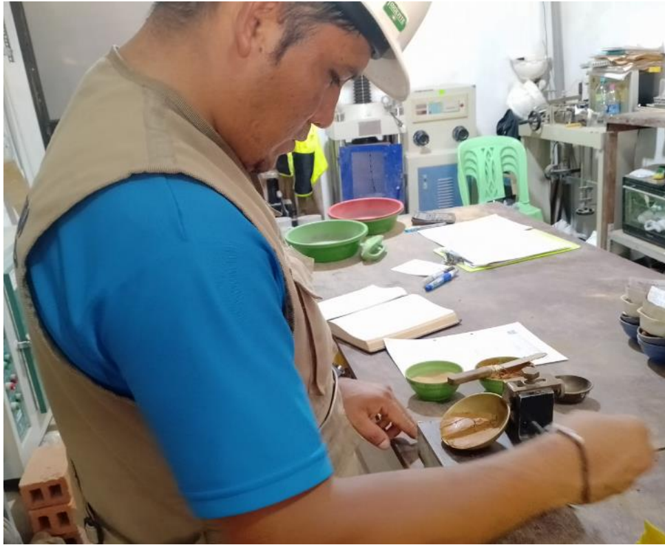
Imagen 05: ensayo de casa grande.
