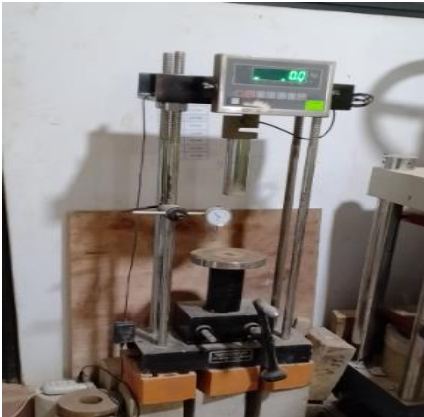
Imagen 12: prensa hidráulica para ensayo de CBR.
