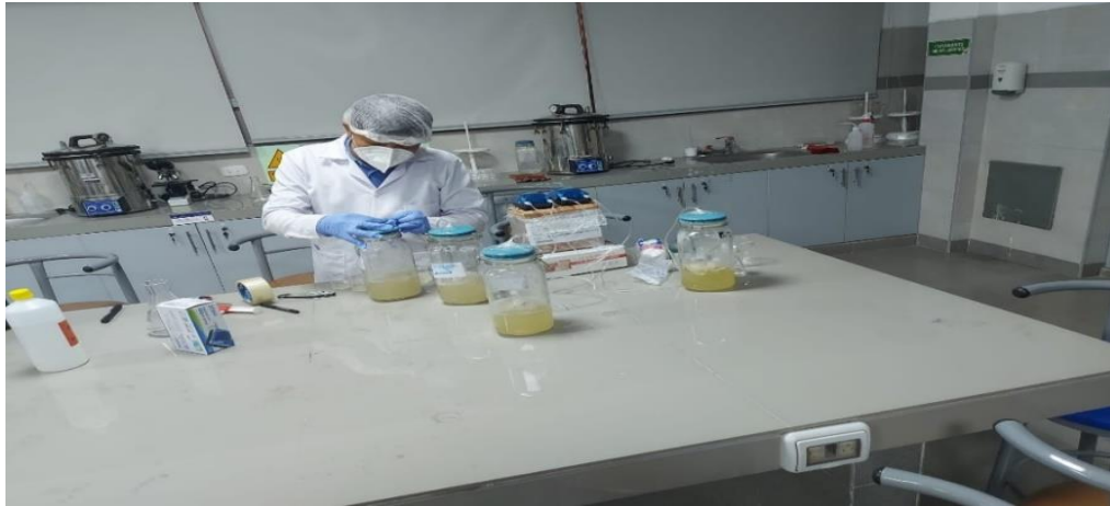
Figura 26. Verificación de cada unidad de P. biorreactor airlift para evitar fugas de aire.
