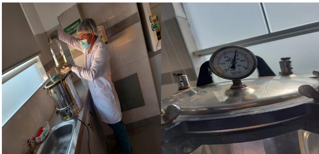
Figura 25. Esterilización de frascos conteniendo caldo nutritivo en autoclave a 121 °C.
