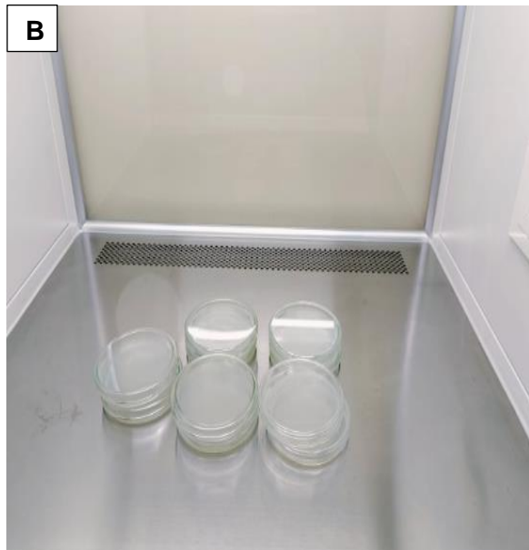
Figura 3: A. Para su esterilización, se sometió durante 20 minutos en autoclave a 120 °C y 15 lb de presión; B. Se vació 20 ml en placas Petri de 90 mm estériles, en condiciones asépticas y se dejó enfriar y solidificar a temperatura ambiente durante 24 h.
