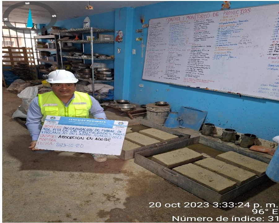
Se muestra el ensayo de absorción de los adobes a los 28 días
