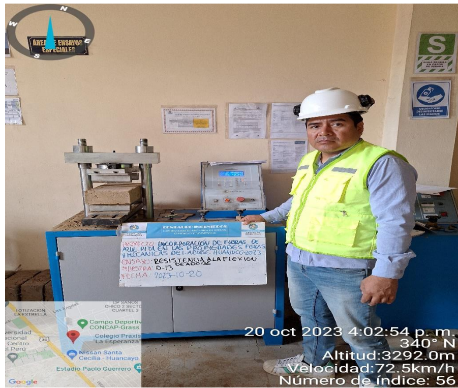
Se observa el ensayo de la flexión de los adobes a los 28 días
