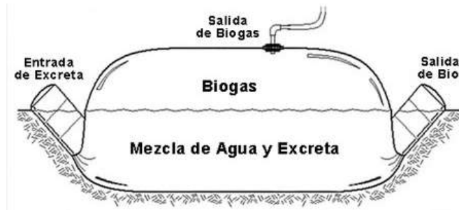
FIGURA 3: Biodigestor de bolsa (tipo balón). (Chacón, 2017)
