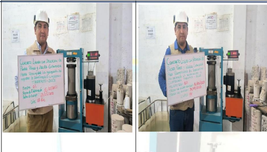
Fotos n° 17-18: En las imágenes podemos observar la resistencia a la compresión axial de los testigos de concreto.
