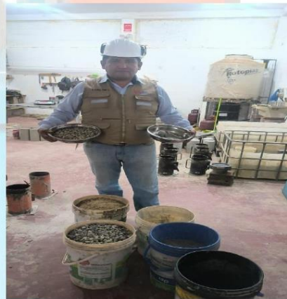
Fotos n° 11-12: En las imágenes podemos apreciar los materiales a utilizar para el diseño de concreto con reemplazo de piedra pómez y arcilla expandida.
