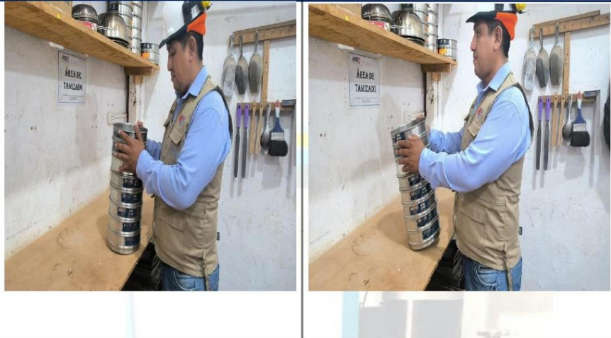
Fotos nº 05-06: En las imágenes se puede apreciar el ensayo de análisis granulométricos.
