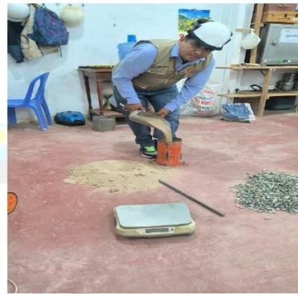
Fotos n° 09-10: En las imágenes podemos observar realización del ensayo de peso unitario.
