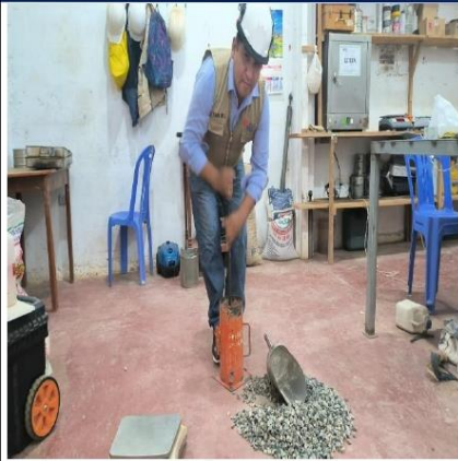
Fotos n° 09-10: En las imágenes podemos observar realización del ensayo de peso unitario.
