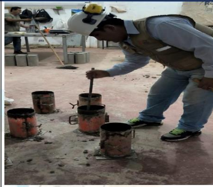
Fotos n° 13-14: En las imágenes podemos observar al personal realizando moldeo de los testigos de los diseños.
