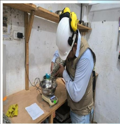
Fotos n° 11-12: En las imágenes podemos apreciar los materiales a utilizar para el diseño de concreto con reemplazo de piedra pómez y arcilla expandida.
