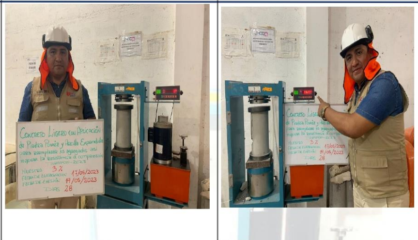
Fotos n° 25-26: En las imágenes podemos observar la resistencia a la compresión axial de los testigos de concreto
