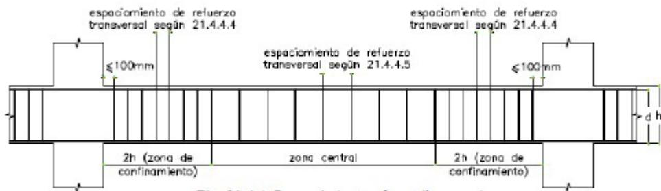
Fig. 21.4.4 Requerimientos de estribos en vigas.
