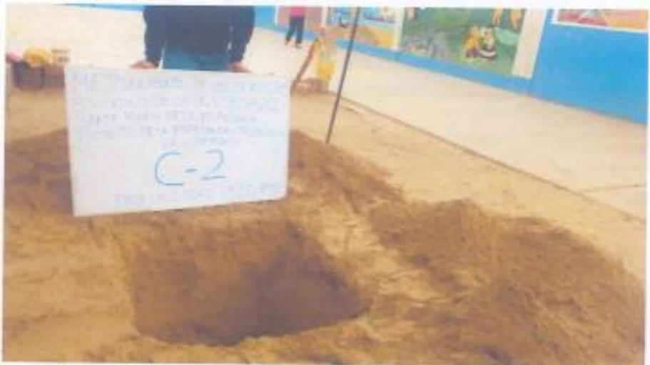
Fotos 08: Vista Panorámica de la Excavación de la calicata C-02, con un primer estrato superficial de 0.30 mts de suelo contaminado con material de relleno y orgánico, un segundo estrato de 2.70 mts de suelo de arena fina, de color beige
