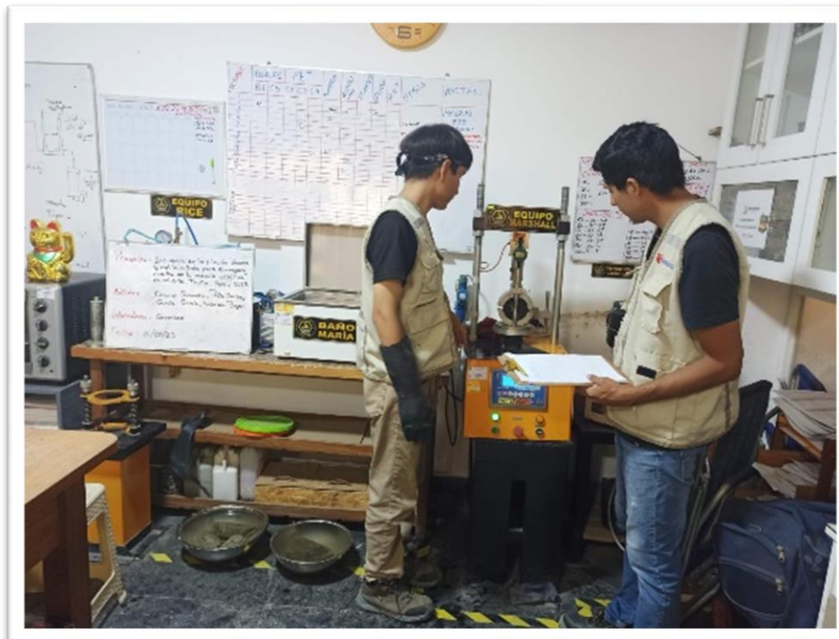
Fotografía 22: Ensayo Marshall de cada muestra después del baño maría para obtener la estabilidad y flujo
