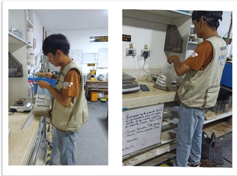
Fotografía 11: Control de peso de cada material e insumo para su posterior mezcla
