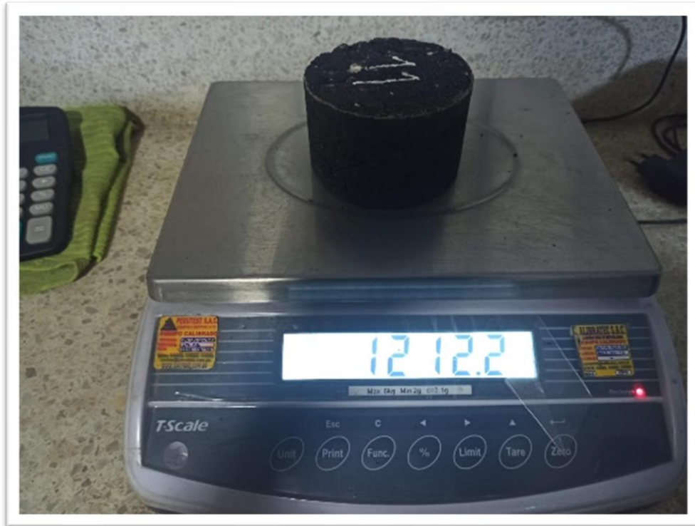
Fotografía 19: Control de peso al aire de cada briqueta
