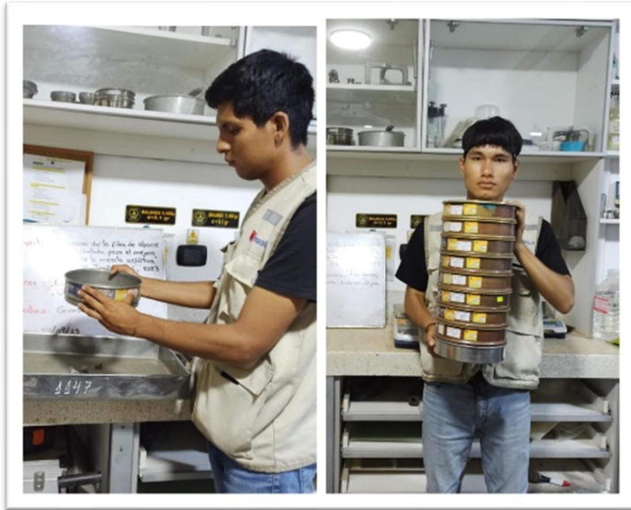
Fotografía 07: Análisis granulométrico de agregados gruesos y finos
