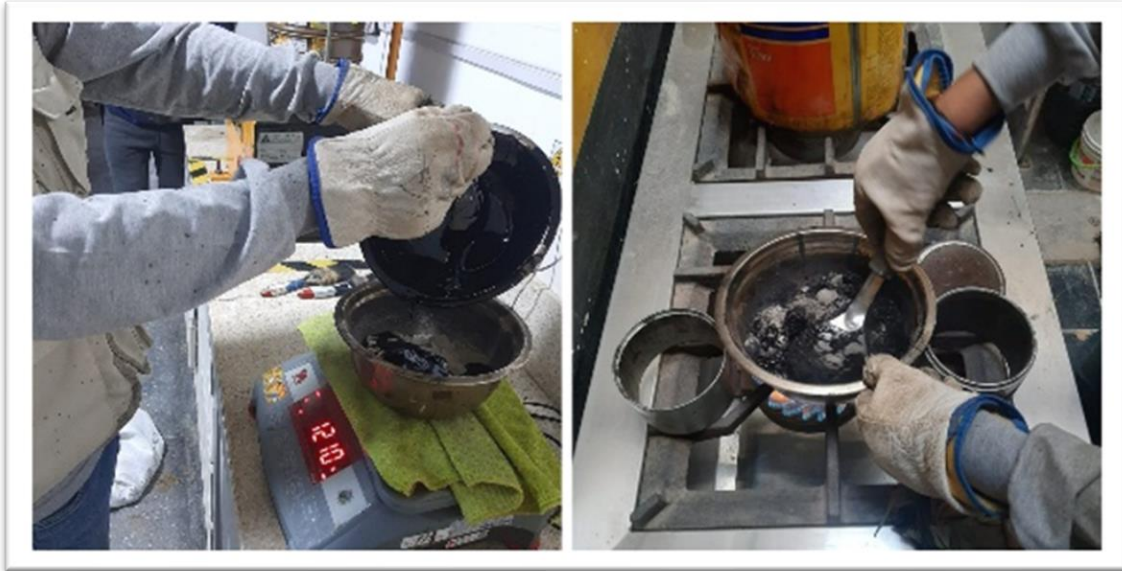
Fotografía 13: Combinación de los materiales e insumos para elaboración de briquetas
