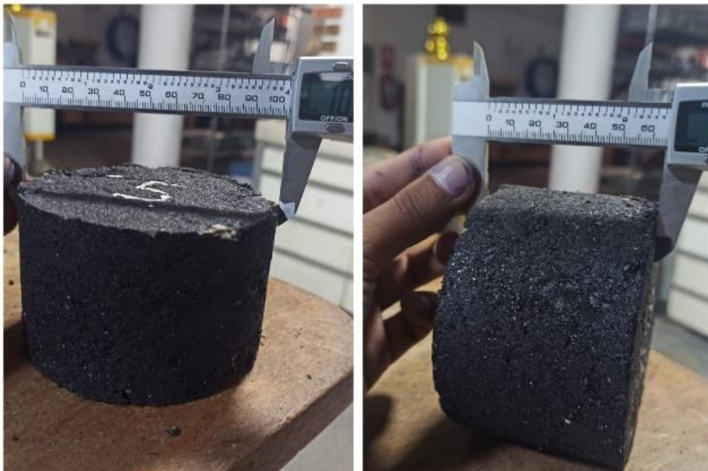
Fotografía 18: Verificación de dimensiones de cada briqueta
