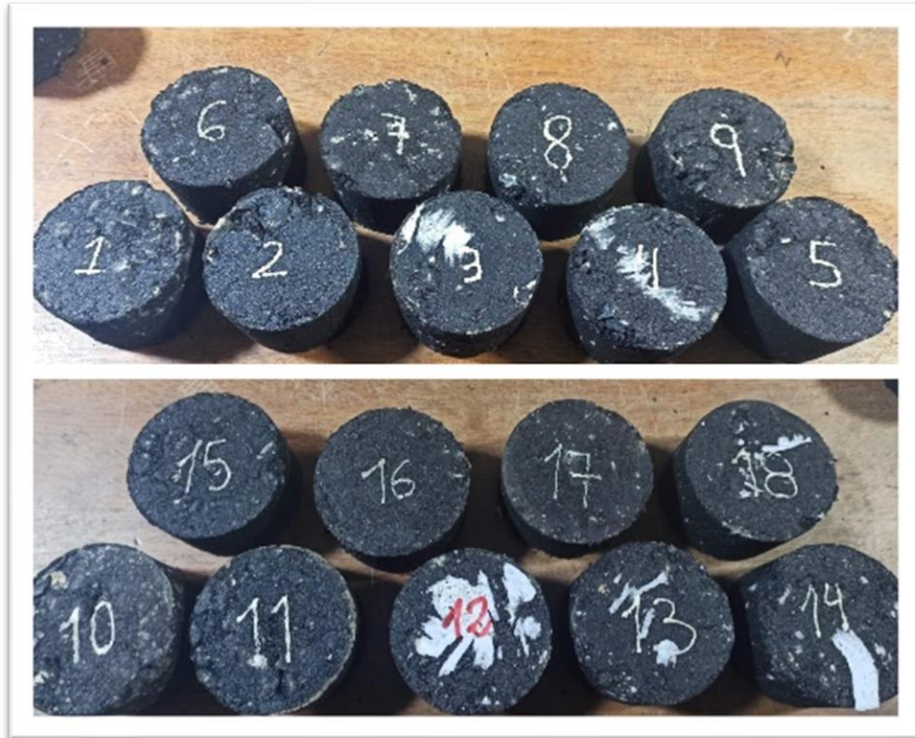
Fotografía 17: Briquetas modificadas con cal y briquetas adicionando fibra de abacá
