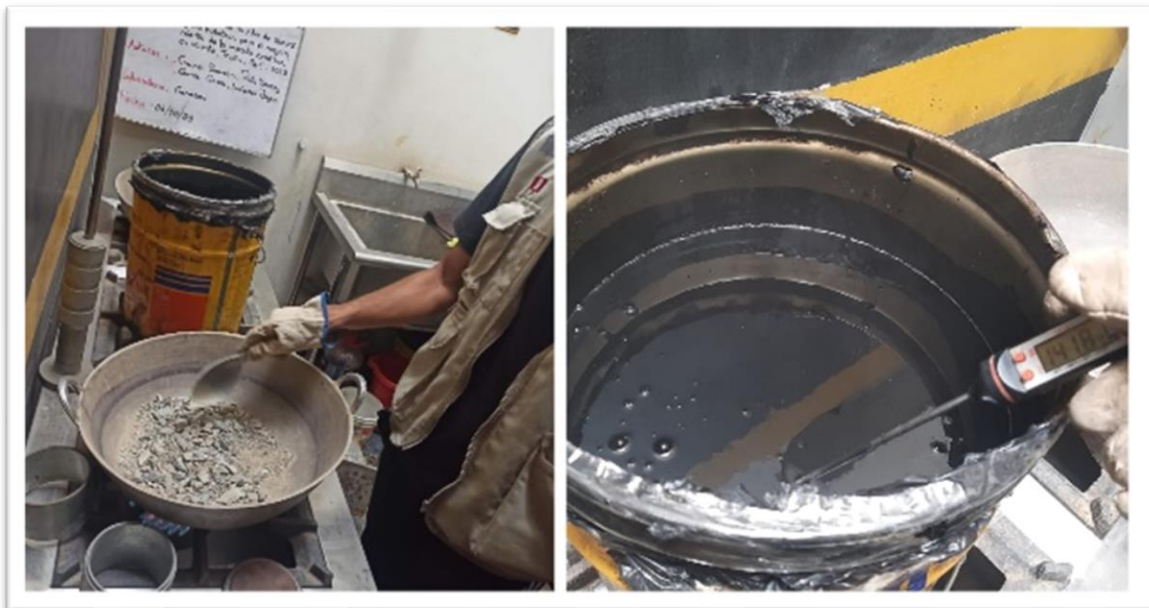
Fotografía 12: Control de temperatura a 140°C de los materiales e insumos.
