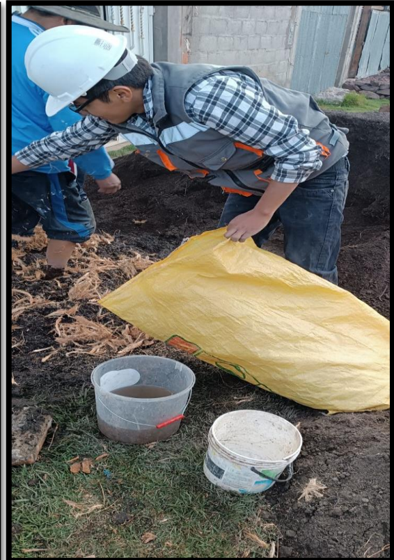
Fotografía 7. Preparación de la tierra con las fibras ya pesadas para cada porcentaje de resistencia
