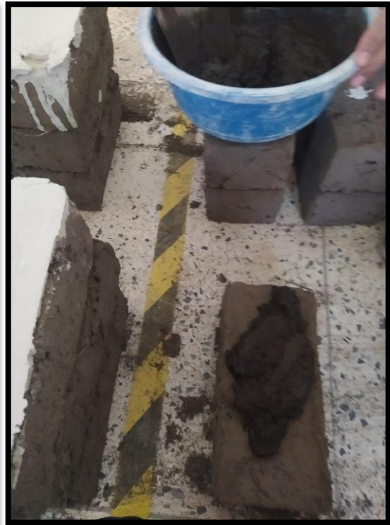
Fotografía 25. Proceso de preparación del mortero para el ensayo de compresión por pilas
