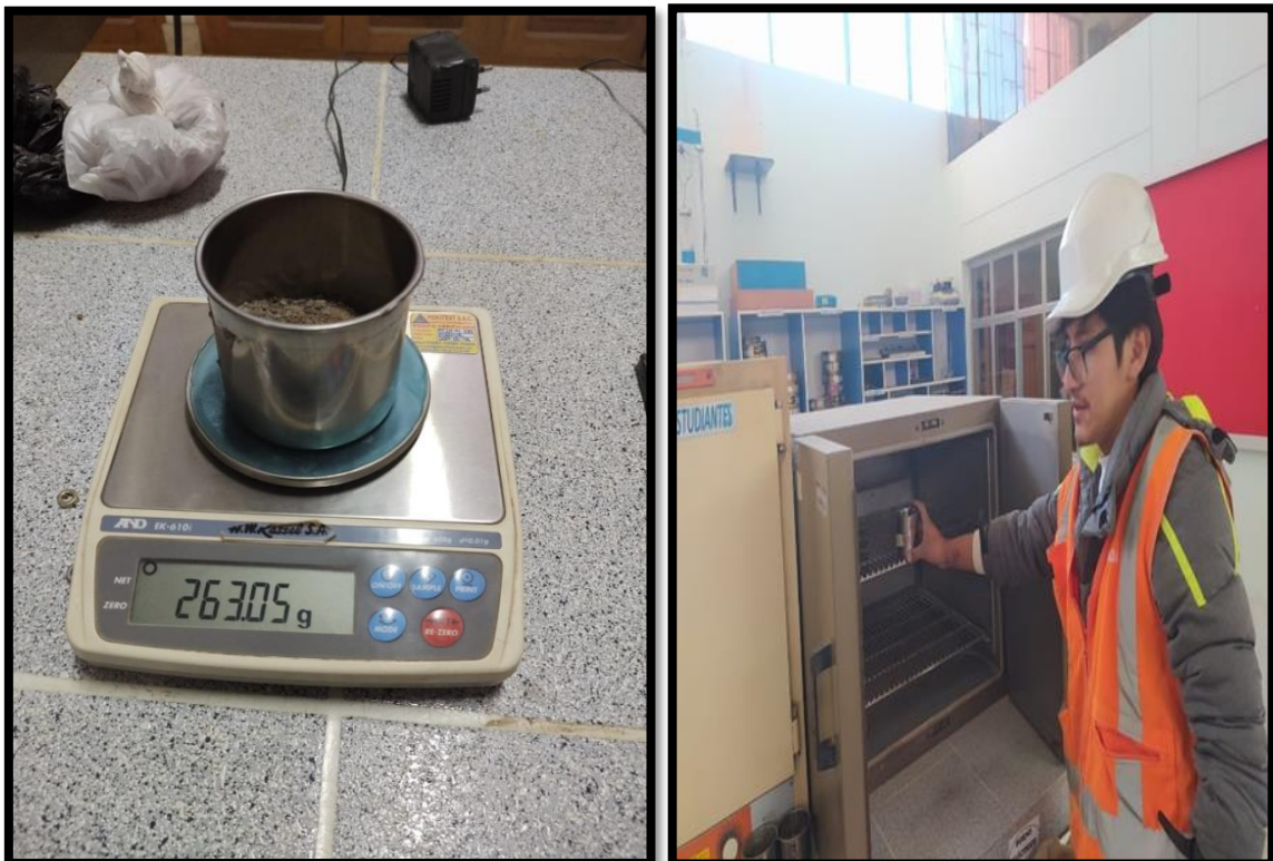
Fotografía 13. Proceso de pesado de muestra para el contenido de humedad
