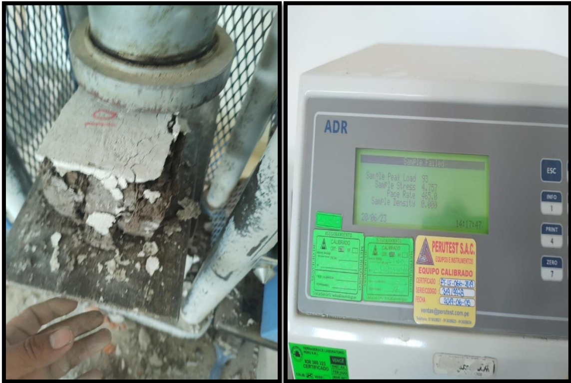
Fotografía 31. Proceso de rotura por el método de compresión de pilas de todas las muestras de los diferentes porcentajes
