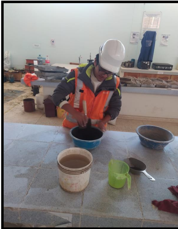
Fotografía 25. Proceso de preparación del mortero para el ensayo de compresión por pilas
