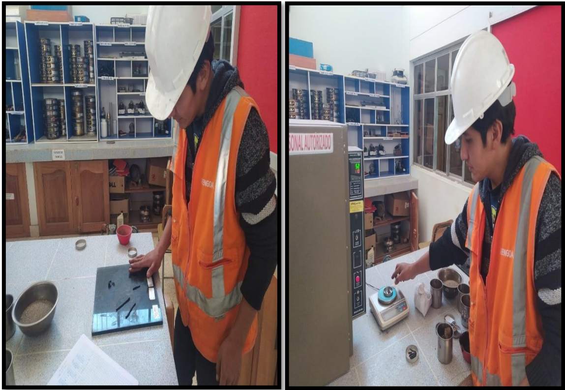
Fotografía 22. Preparación de los agregados para el capeo, de ambas caras del adobe
