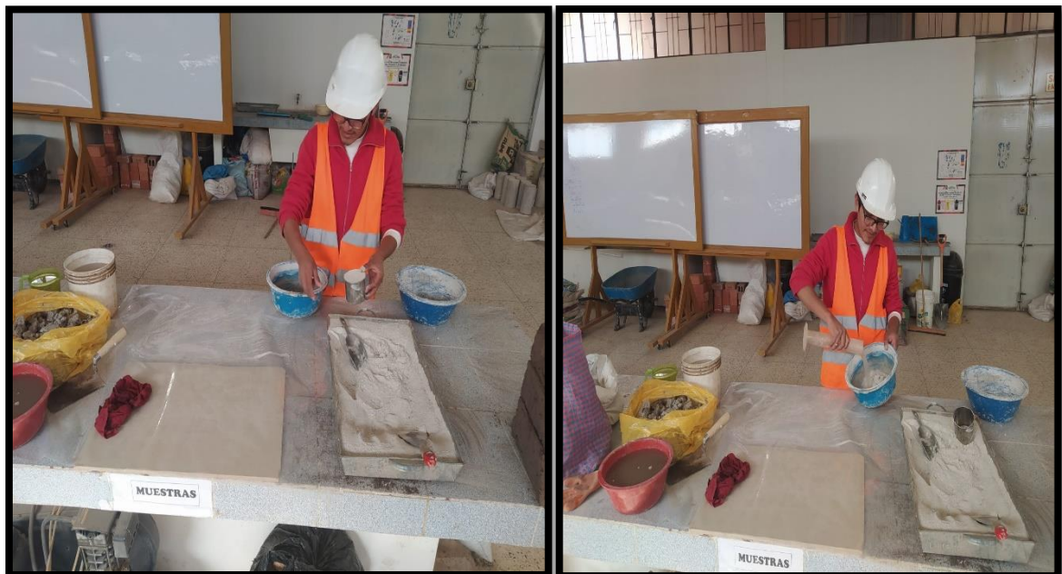
Fotografía 22. Preparación de los agregados para el capeo, de ambas caras del adobe
