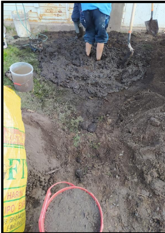
Fotografía 7. Preparación de la tierra con las fibras ya pesadas para cada porcentaje de resistencia
