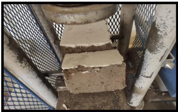
Fotografía 30. Proceso de rotura por el método de compresión de todas las muestras de los diferentes porcentajes
