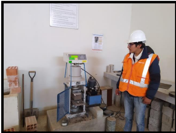
Fotografía 29. Proceso de rotura de los adobes por resistencia a la flexión de todas las muestras de los diferentes porcentajes.
