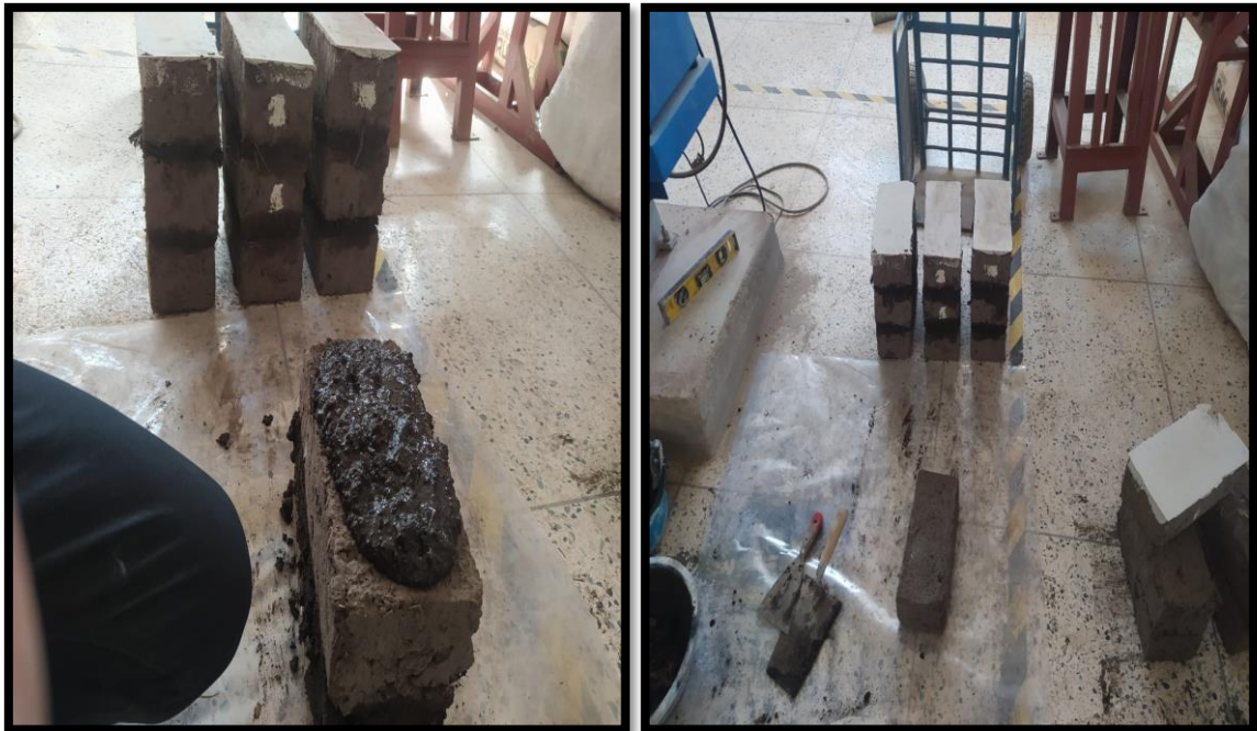
Fotografía 27. Proceso de apilamiento de adobes
