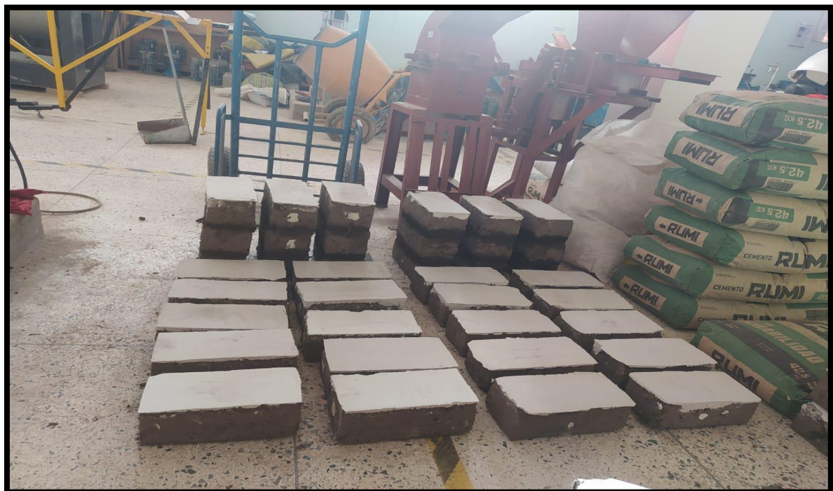
Fotografía 28. Proceso de almacenamiento de muestras para sus diferentes pruebas, para las muestras del ensayo de pilas se procederá a esperar el secado del mortero añadido.
