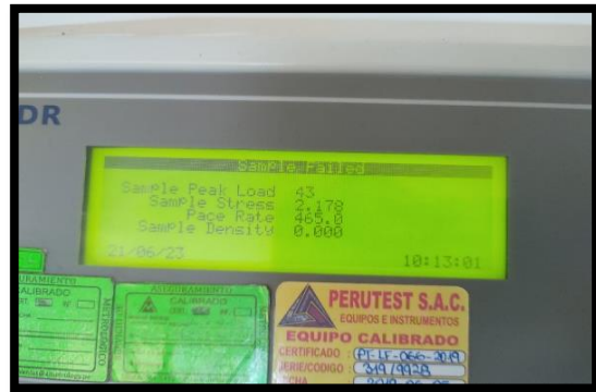
Fotografía 30. Proceso de rotura por el método de compresión de todas las muestras de los diferentes porcentajes
