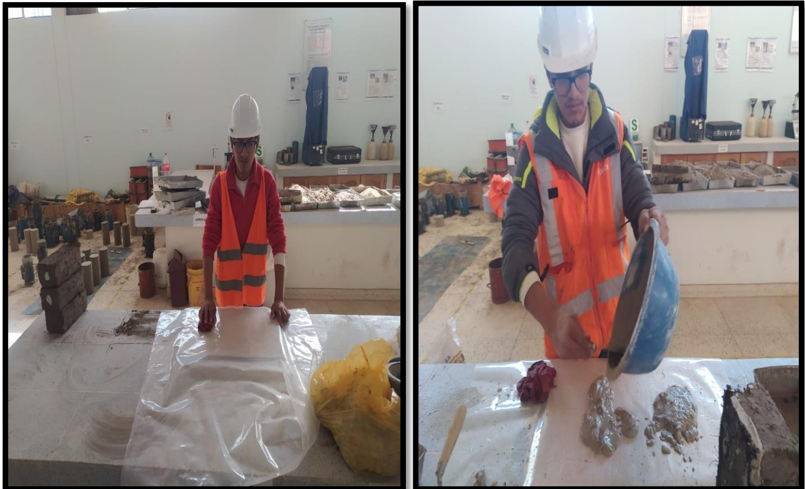
Fotografía 24. Proceso final para el capeo de caras
