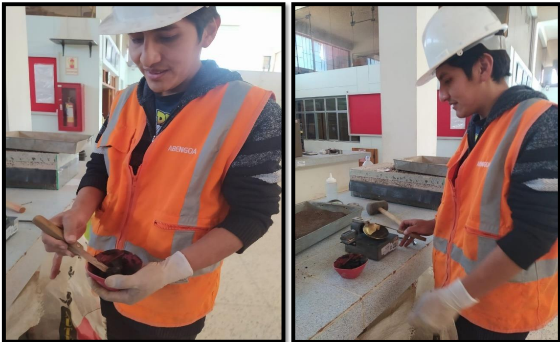
Fotografía 17. Proceso de mezclado del material tamizado y uso del método de Casagrande
