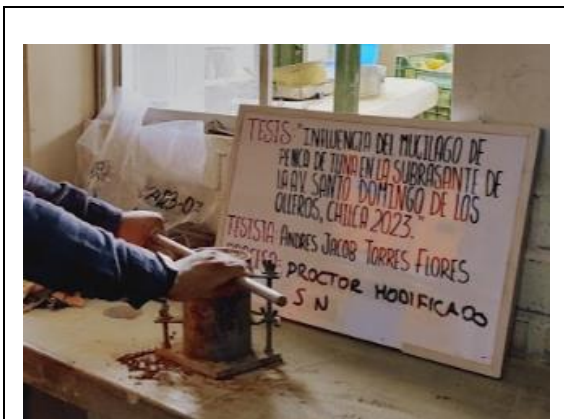
Proctor Modificado Máxima Densidad Seca - Patrón
