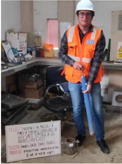
Proctor Modificado Máxima Densidad Seca – Patrón + 45% MPT
