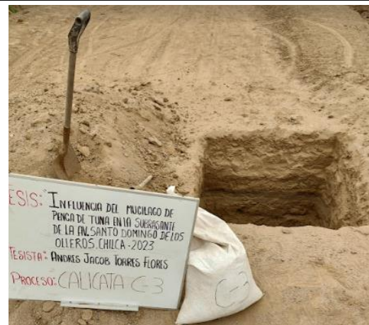
Toma de muestra de la calicata C-3
