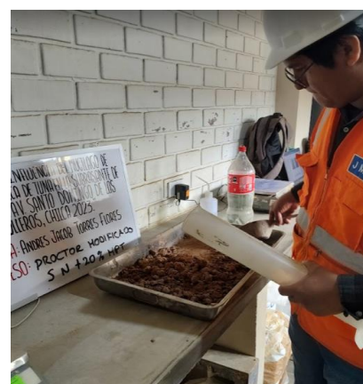
Proctor Modificado Optimo Contenido de Humedad – Patrón + 20% MPT
