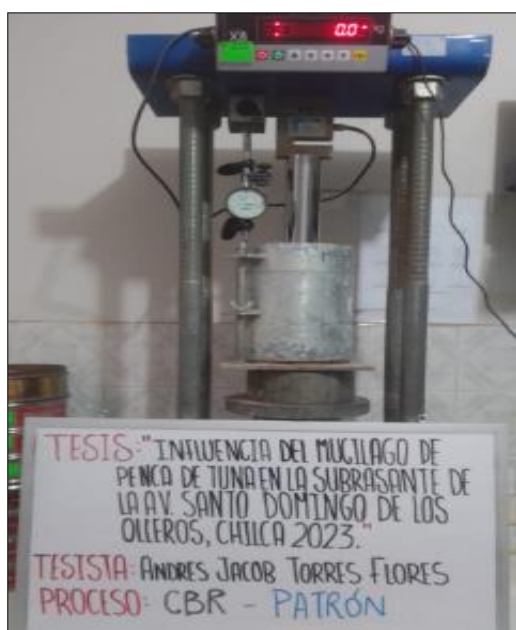
Figura 33: Ensayo de California Bearing Ratio (CBR) realizado al suelo natural.
