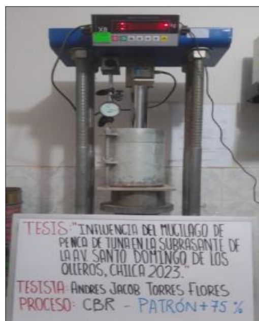
Figura 34: Ensayo de California Bearing Ratio (CBR) realizado al suelo natural con añadidura de Mucilago de las Pencas de las Tunas.
