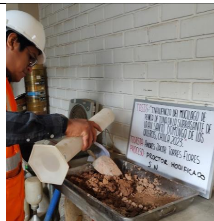
Proctor Modificado Optimo Contenido de Humedad - Patrón
