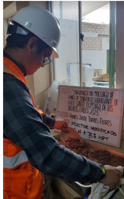
Proctor Modificado Optimo Contenido de Humedad – Patrón + 75% MPT
