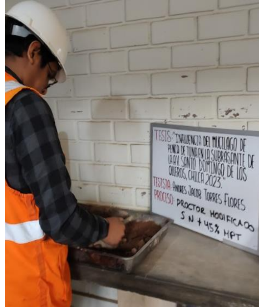
Proctor Modificado Optimo Contenido de Humedad – Patrón + 45% MPT
