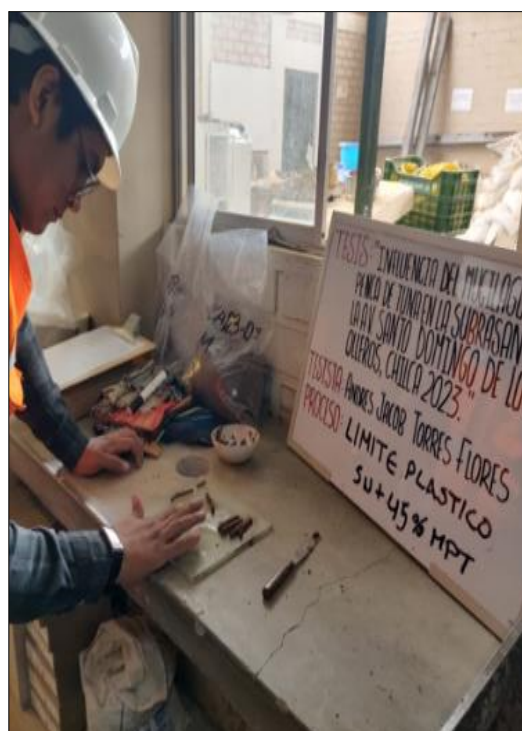
Figura 27: Ejecución del ensayo para determinación del límite plástico.
