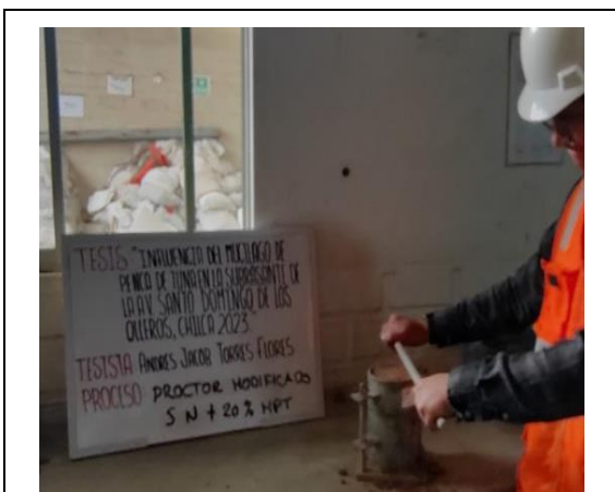
Proctor Modificado Máxima Densidad Seca – Patrón + 20% MPT
