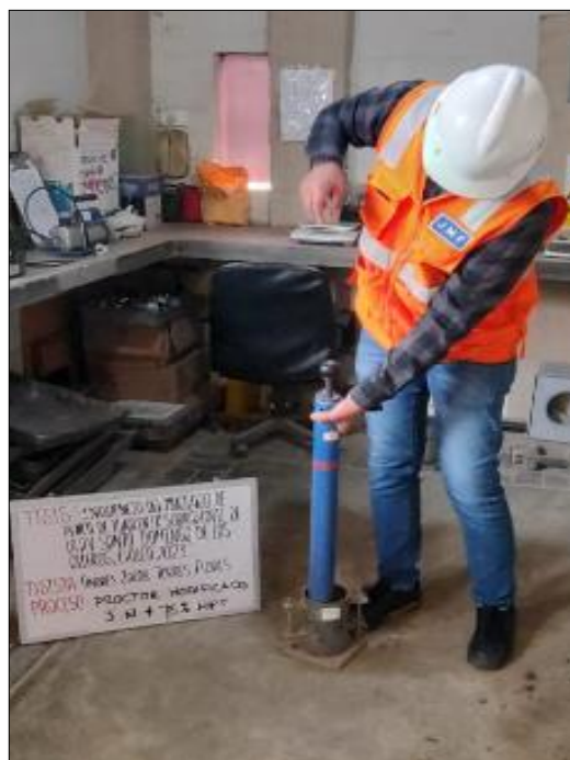
Figura 30: Ensayo de Proctor Modificado, preparación de moldes.
