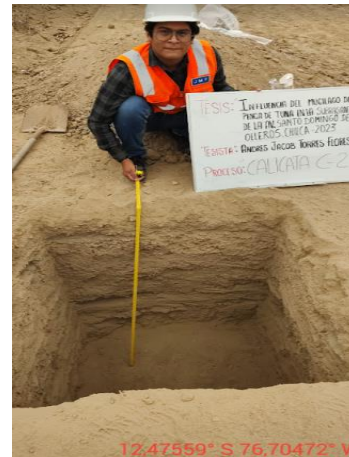
Verificación de profundidad de calicata C-2
