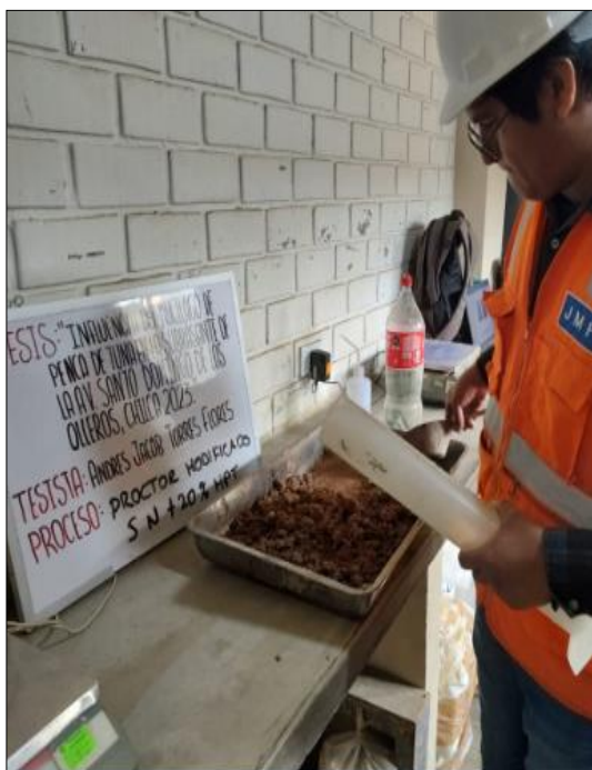
Figura 29: Ensayo de Proctor Modificado, con añadidura de MPT.
