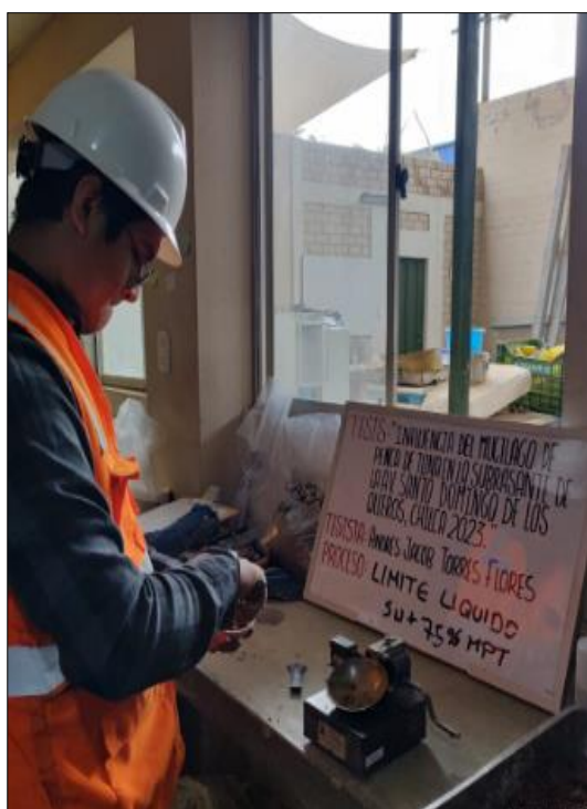
Figura 26: Ejecución del ensayo para determinación del límite líquido.
