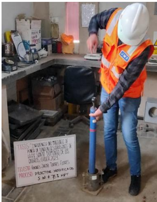
Proctor Modificado Máxima Densidad Seca – Patrón + 75% MPT
