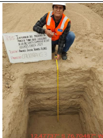
Verificación de profundidad de calicata C-3
