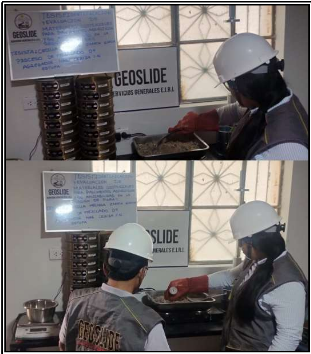
Figura 30. Proceso de mezclado de agregados, ceniza de paja de arroz y vidrio triturado en estufa
