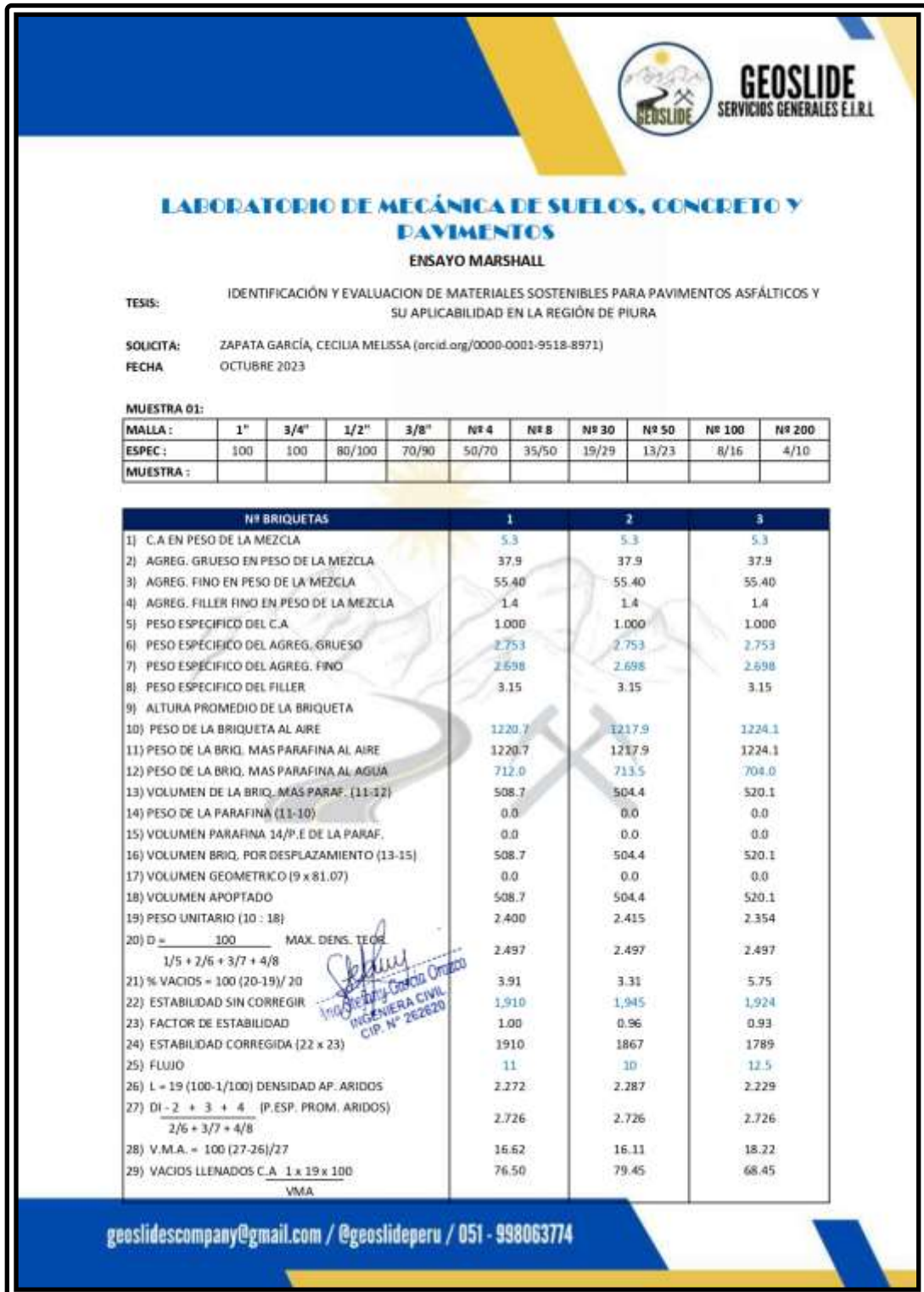
Figura 8. Ensayo Marshall de briqueta al 5.3% de CA utilizando agregados naturales
