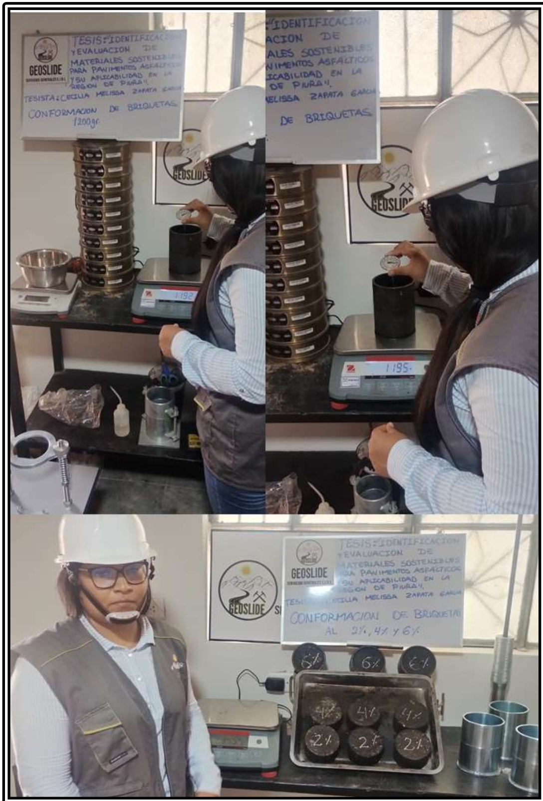
Figura 31. Conformación de briquetas
