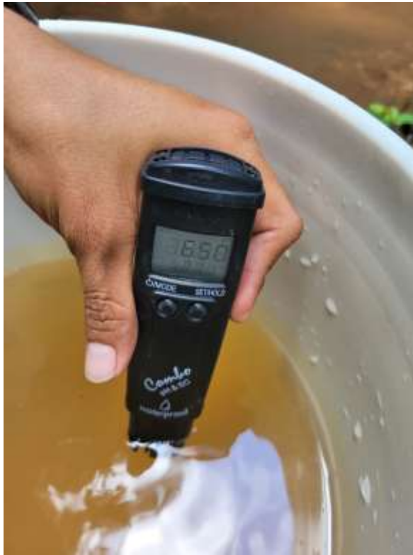
Fotografía 3: Toma in situ de pH y T° del agua.
