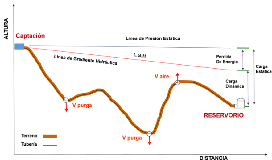
Ilustración 1: Línea gradiente hidráulica de una conducción a presión
