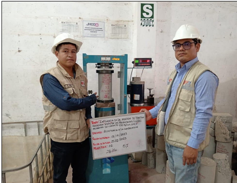
Figura Q: Se aprecia el ensayo de Compresión del concreto 6% (28 días).
