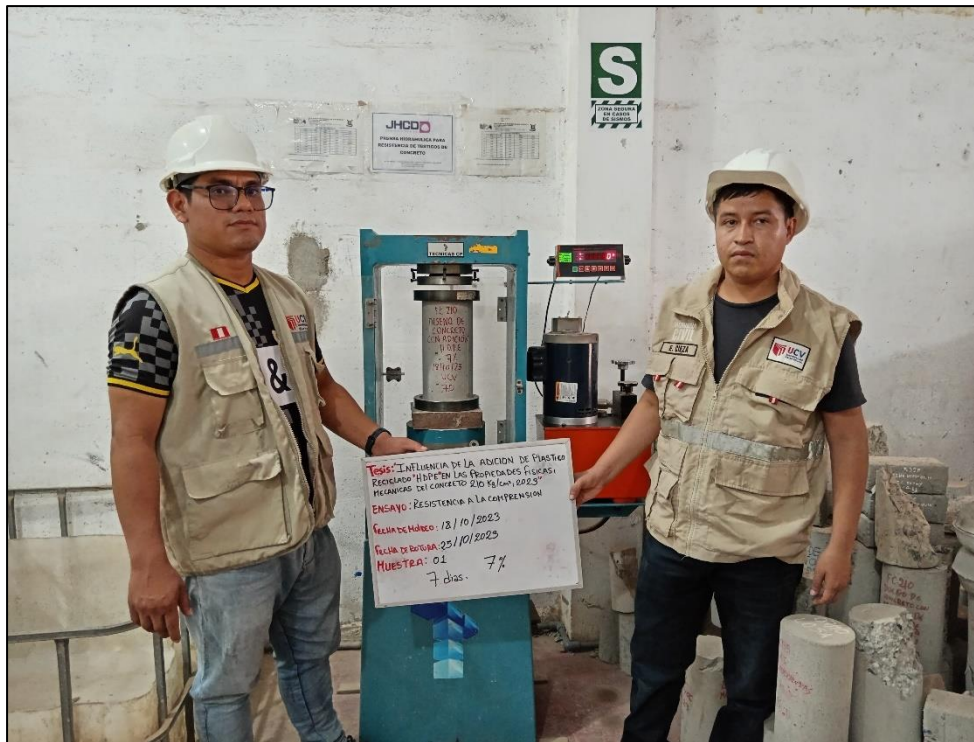
Figura L: Se aprecia el ensayo de Compresión del concreto 0% (14 días).
