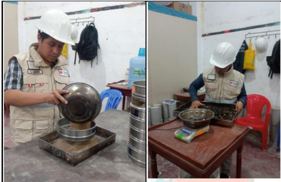
Fotos nº 01-02: En las imágenes se puede apreciar el ensayo de análisis granulométricos.
