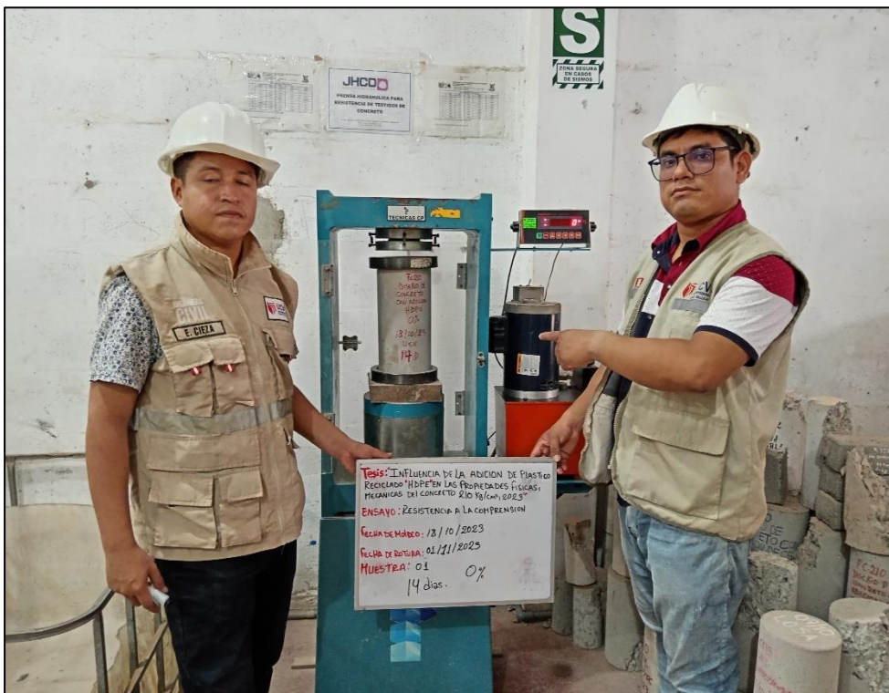
Figura L: Se aprecia el ensayo de Compresión del concreto 0% (14 días).
