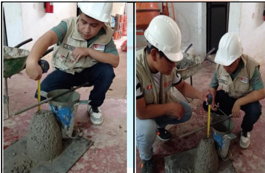
Fotos n° 07-08: En las imágenes podemos observar al personal realizando la prueba de asentamiento para los diseños de Mezclas.
