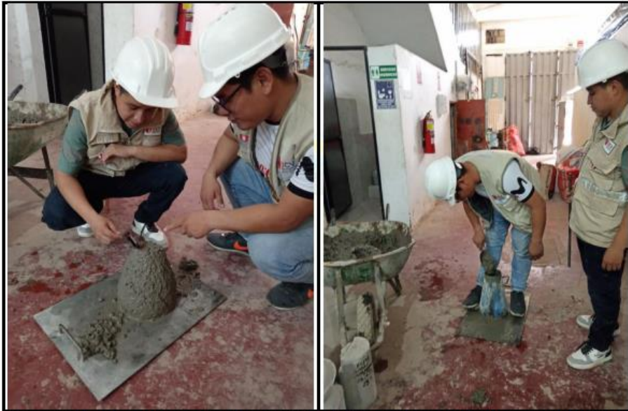
Fotos n° 09-10: En las imágenes podemos observar al personal realizando la prueba de asentamiento para los diseños de Mezclas.
