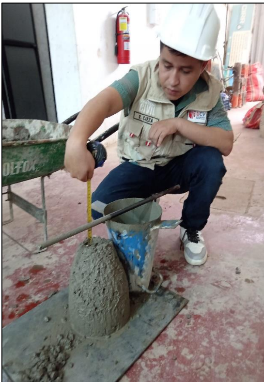
Figura F: Se aprecia el ensayo de Consistencia mediante el cono de Abrams.
