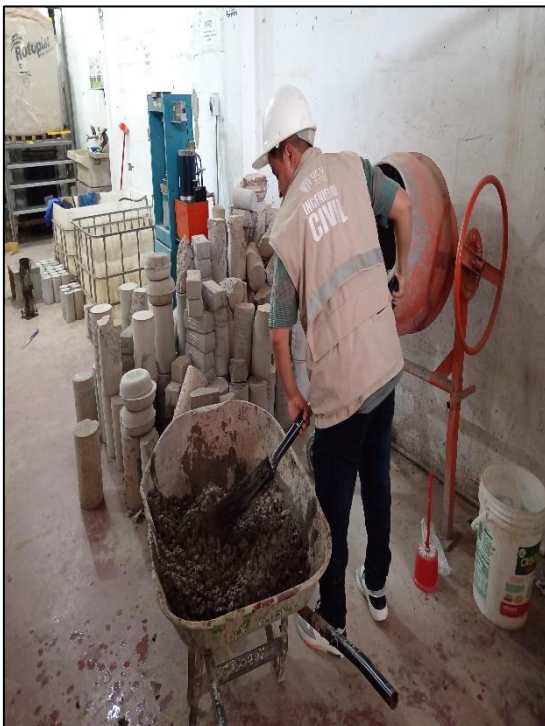
Figura D: Se aprecia la preparación de la mezcla para los diferentes diseños.
