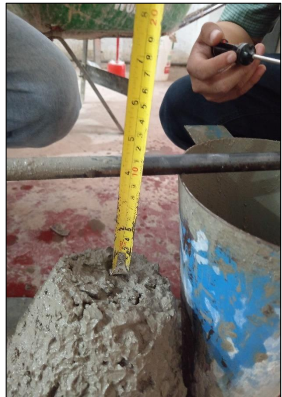
Figura F: Se aprecia el ensayo de Consistencia mediante el cono de Abrams.
