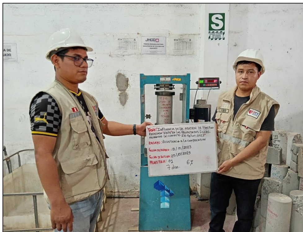
Figura J: Se aprecia el ensayo de Compresión del concreto 6% (7 días).
