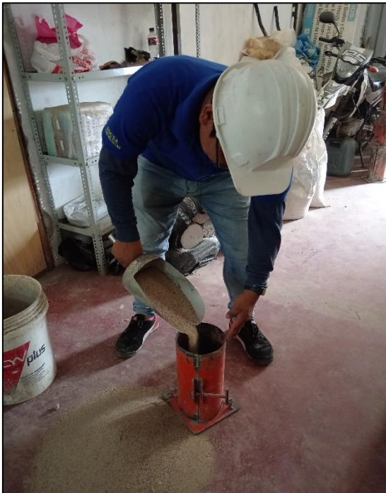
Figura B: Se aprecia el ensayo de Peso Unitario de los agregados.
