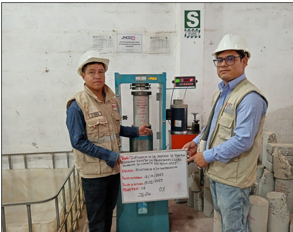
Figura O: Se aprecia el ensayo de Compresión del concreto 0% (28 días).
