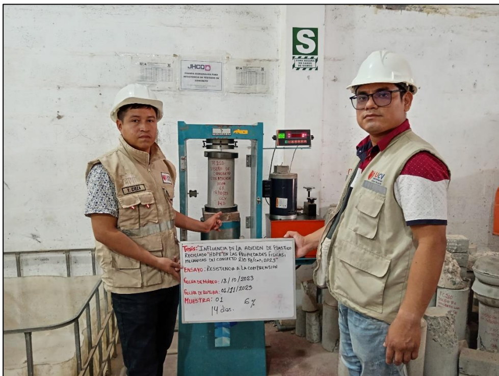
Figura N: Se aprecia el ensayo de Compresión del concreto 6% (14 días).
