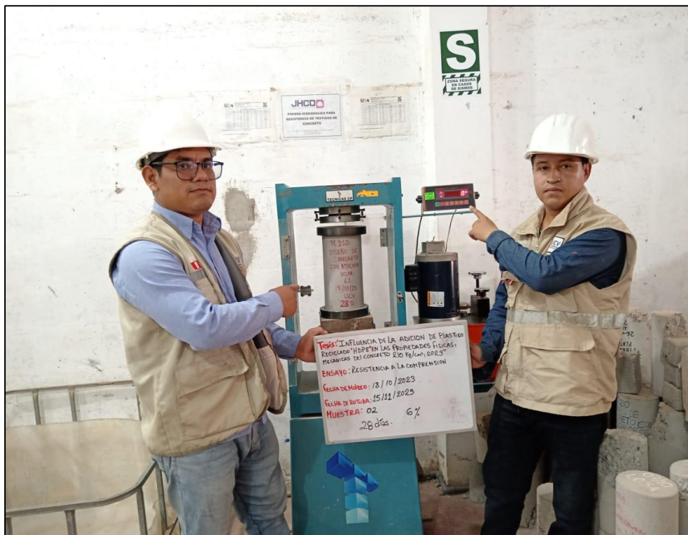
Figura Q: Se aprecia el ensayo de Compresión del concreto 6% (28 días).
