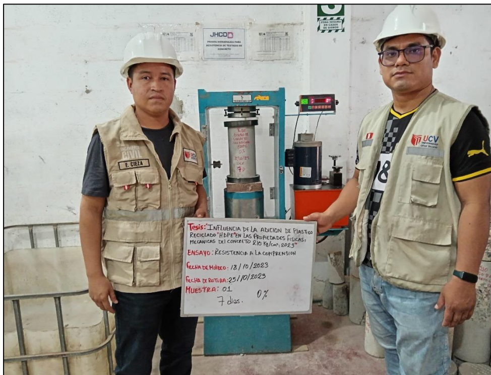
Figura H: Se aprecia el ensayo de Compresión del concreto 0% (7 días).
