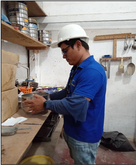
Figura B: Se aprecia el ensayo de Peso Unitario de los agregados.
