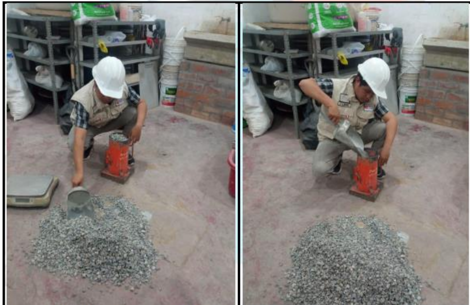
Fotos nº 03-04: En las imágenes podemos observar realización del ensayo de peso unitario de la grava.
