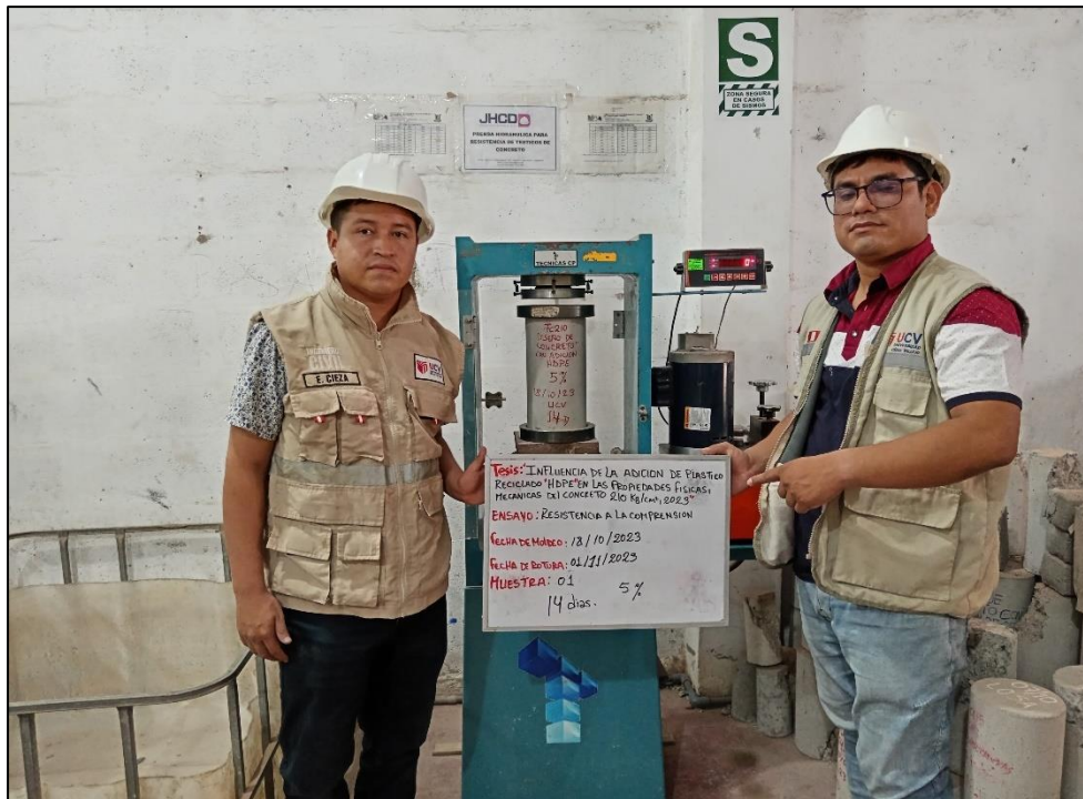
Figura N: Se aprecia el ensayo de Compresión del concreto 6% (14 días).
