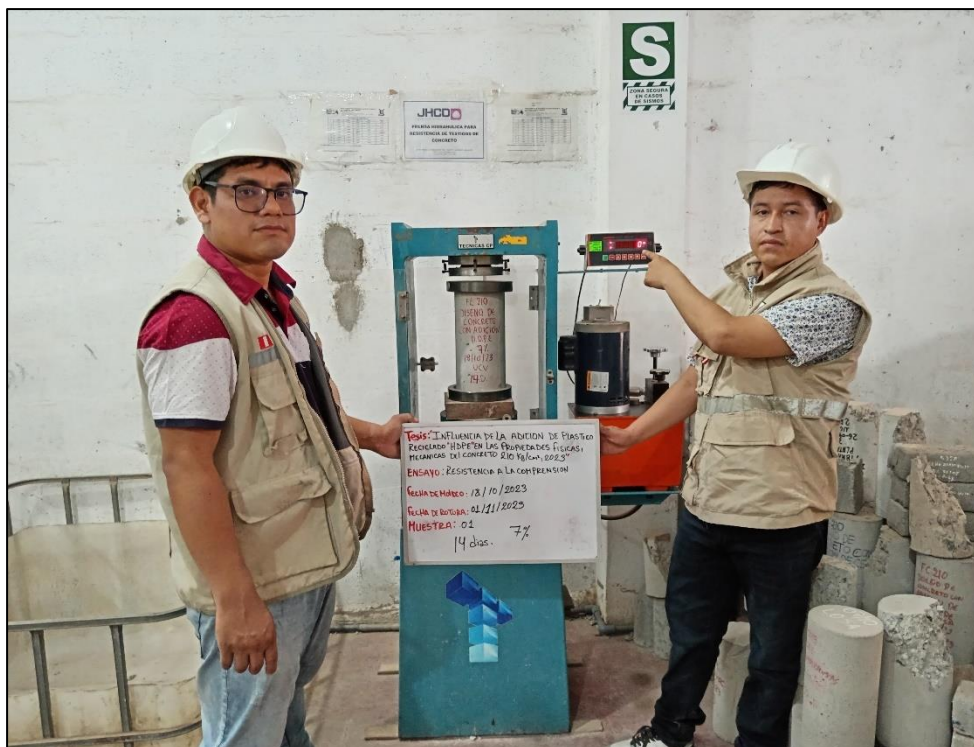
Figura O: Se aprecia el ensayo de Compresión del concreto 0% (28 días).
