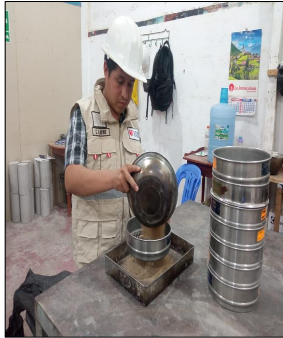
Figura B: Se aprecia el ensayo de Peso Unitario de los agregados.
